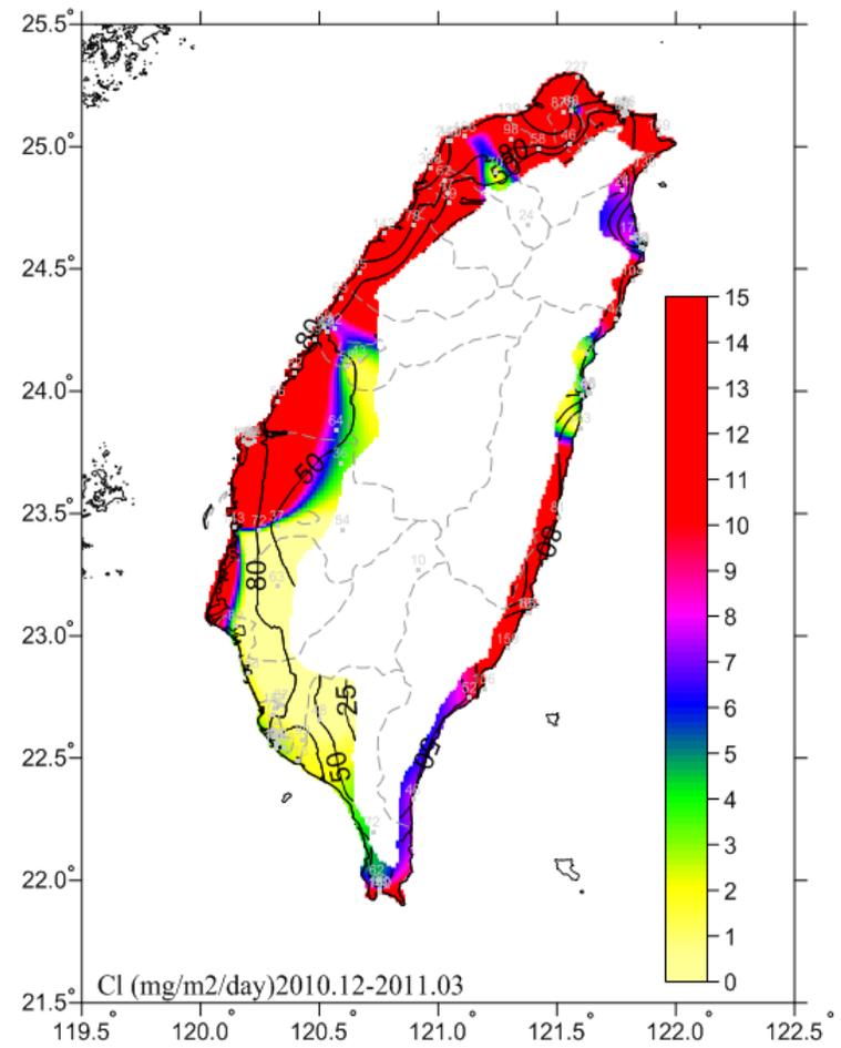
圖 4-2 2010.12-2011.03 氯鹽沉積速率(mg/m<sup>2</sup>/day)
