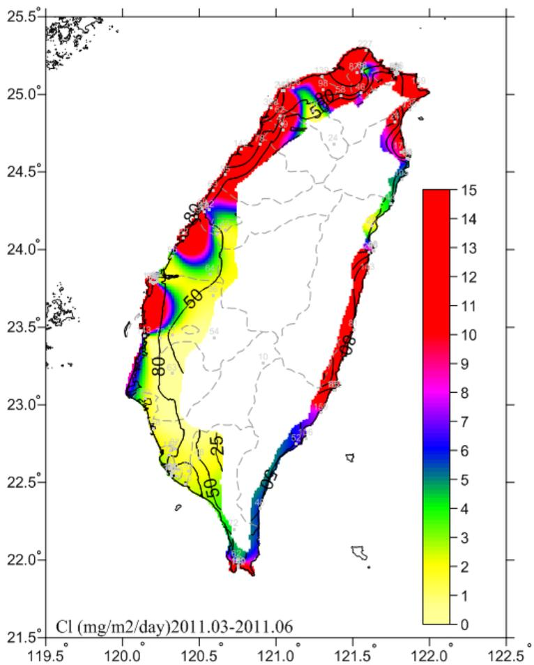
圖 4-3 2011.03-2011.06 氯鹽沉積速率(mg/m<sup>2</sup>/day)
