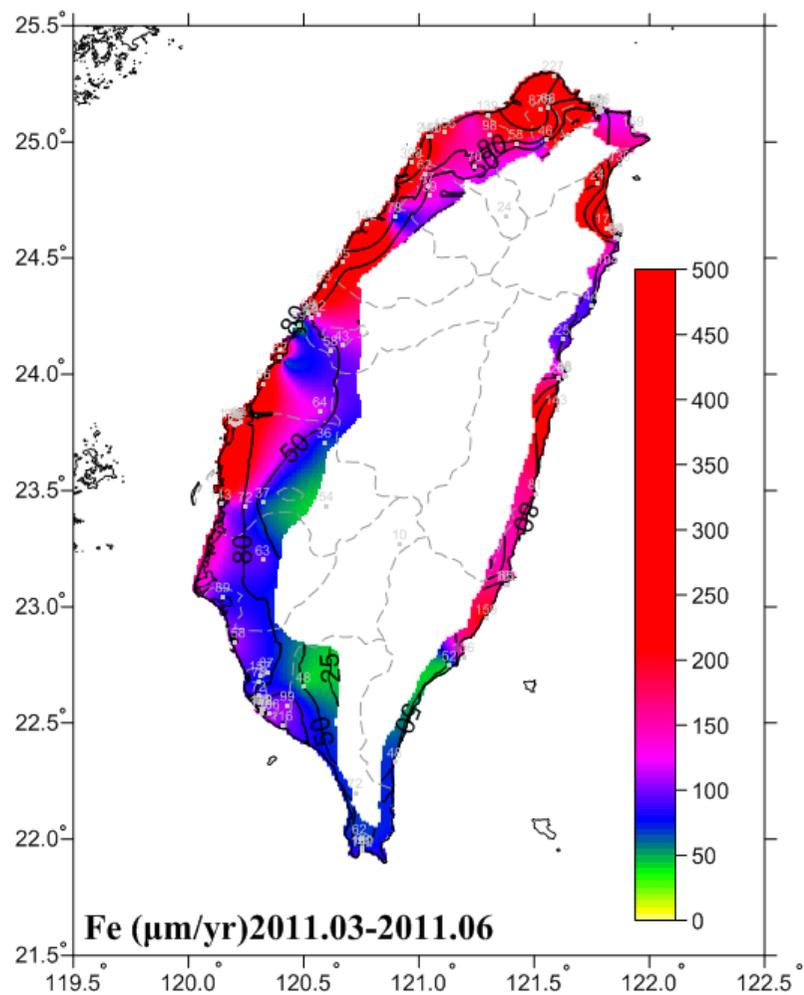
圖 6-11 2011.03-2011.06 碳鋼腐蝕速率圖
