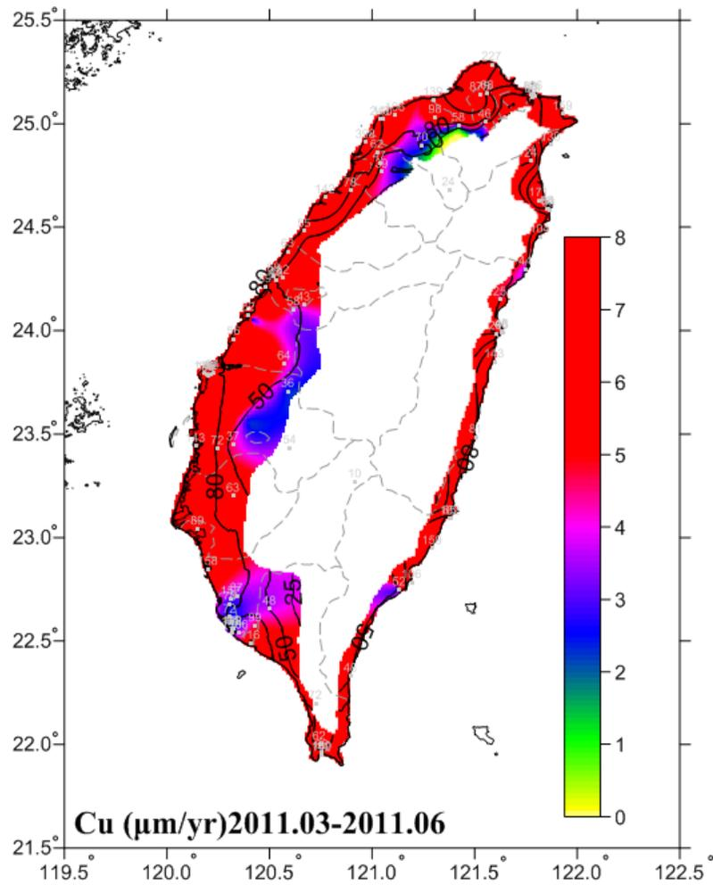
圖 6-19 2011.03-2011.06 銅腐蝕速率圖
