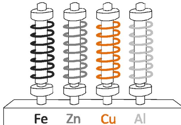
圖 1-5 金屬線材試樣暴放裝置圖
