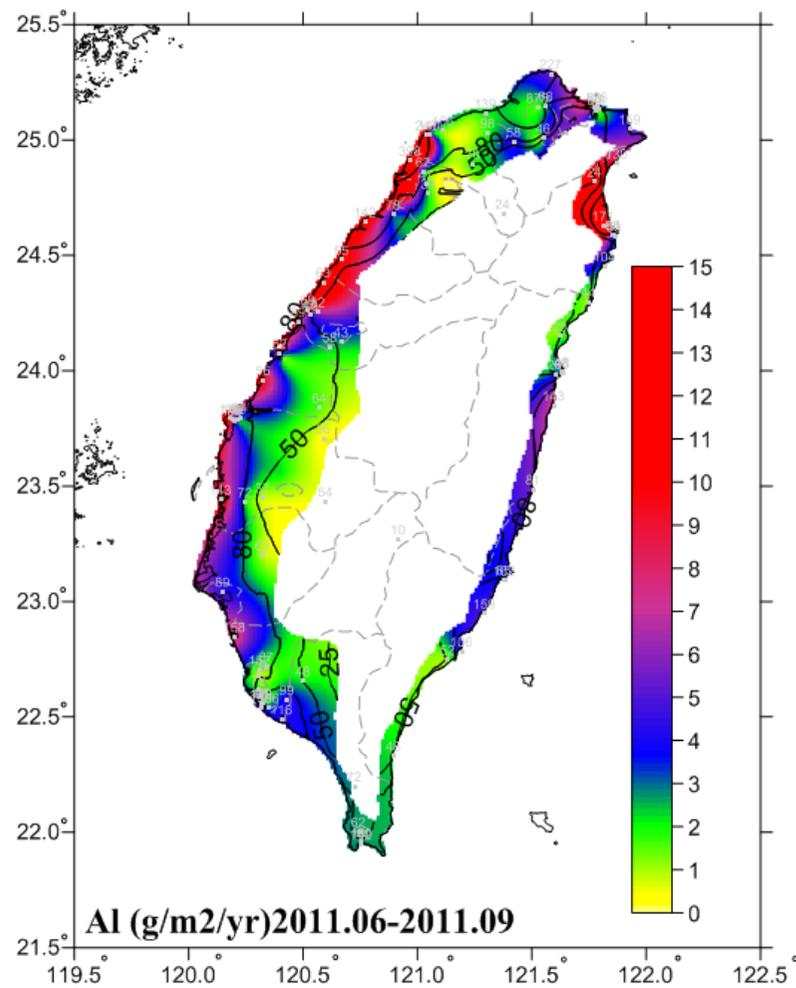
圖 6-24 2011.06-2011.09 鋁腐蝕速率圖
