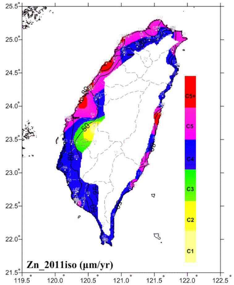
圖 6-26 2011 鋅年腐蝕速率 ISO 分類圖
