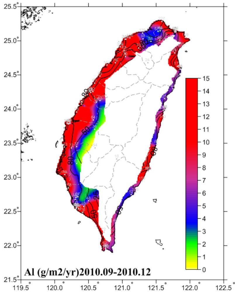
圖 6-21 2010.09-2010.12 鋁腐蝕速率圖
