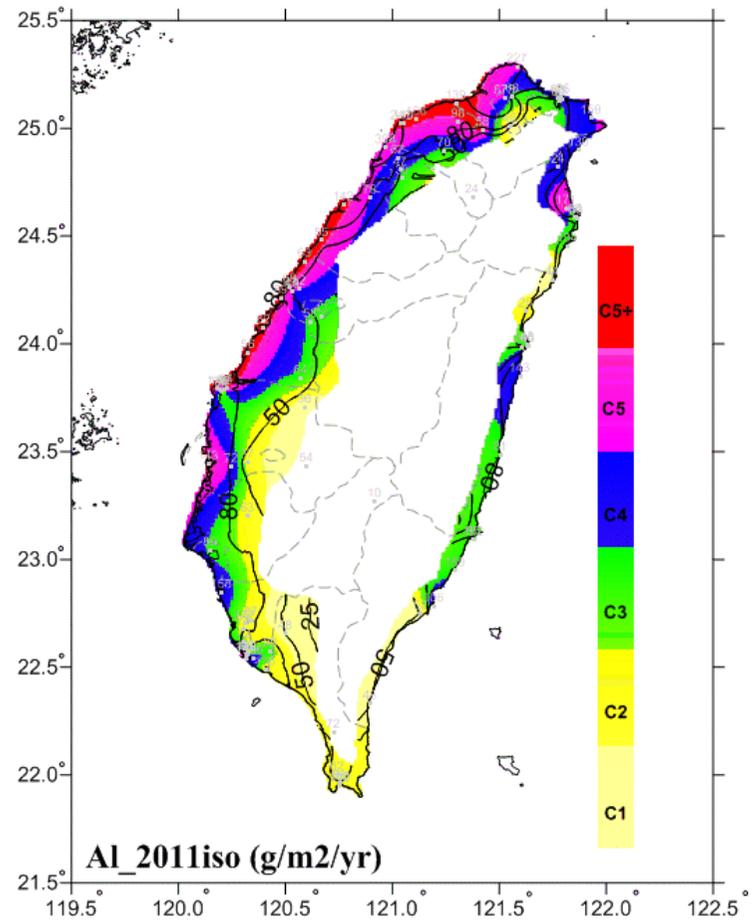
圖 6-28 2011 鋁年腐蝕速率 ISO 分類圖
