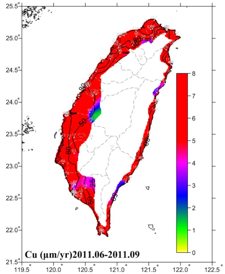
圖 6-20 2011.06-2011.09 銅腐蝕速率圖
