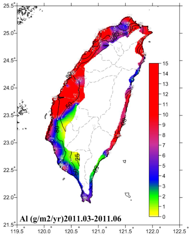
圖 6-23 2011.03-2011.06 鋁腐蝕速率圖
