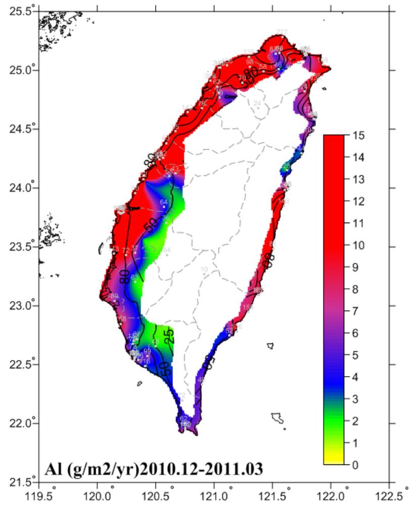
圖 6-22 2010.12-2011.03 鋁腐蝕速率圖
