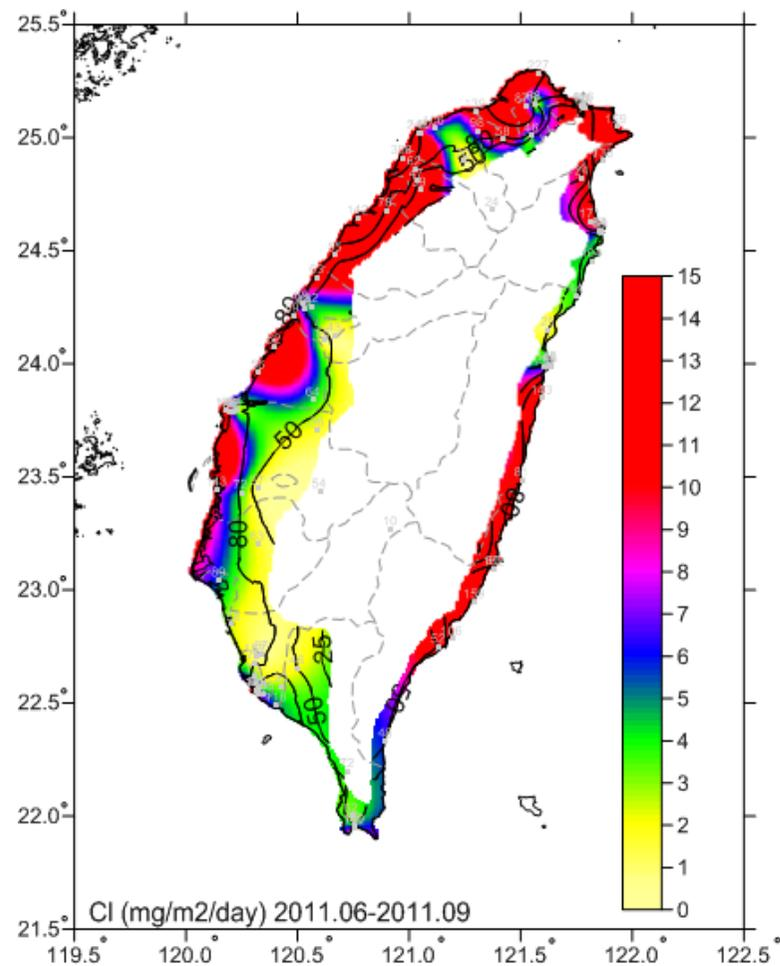
圖 4-4 2011.06-2011.09 氯鹽沉積速率(mg/m<sup>2</sup>/day)
