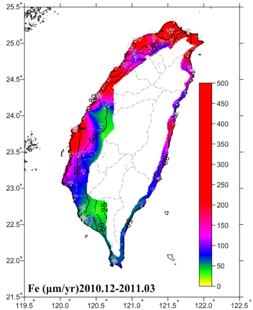
圖 6-10 2010.12-2011.03 碳鋼腐蝕速率圖
