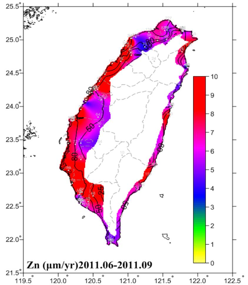
圖 6-16 2011.06-2011.09 鋅腐蝕速率圖
