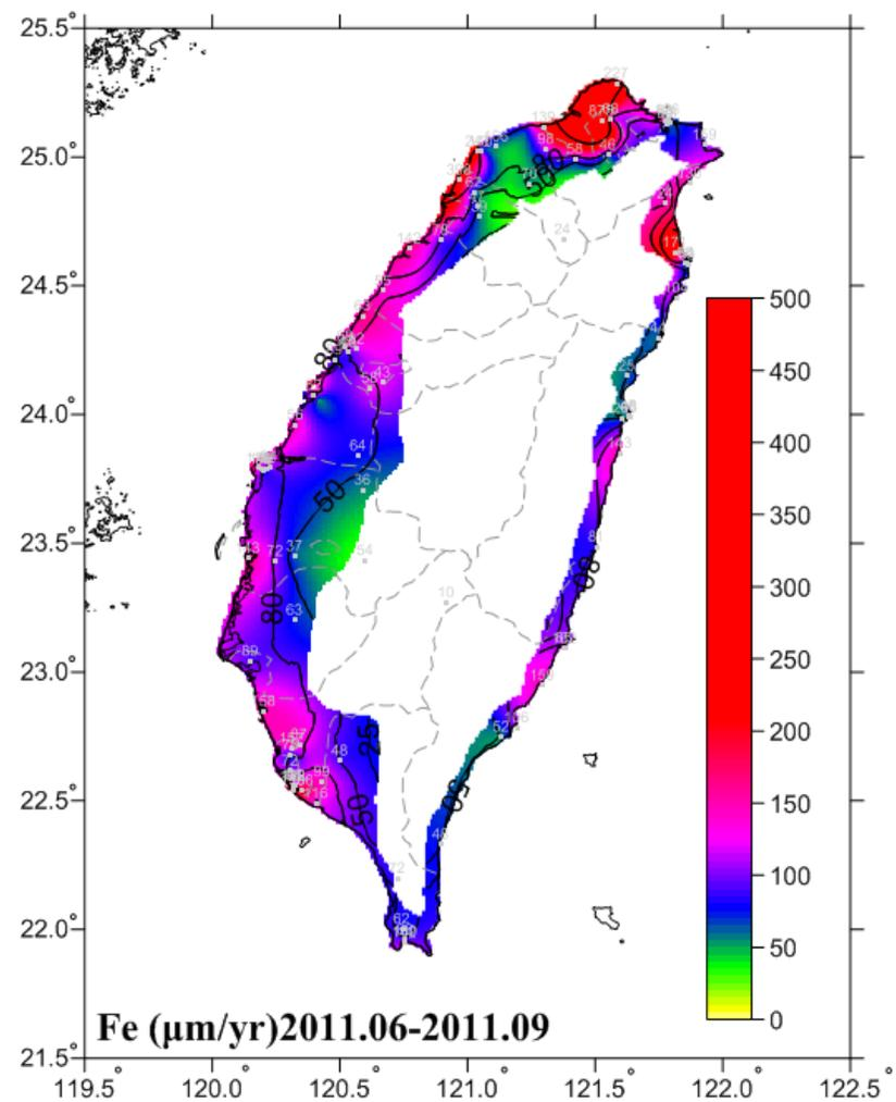
圖 6-12 2011.06-2011.09 碳鋼腐蝕速率圖
