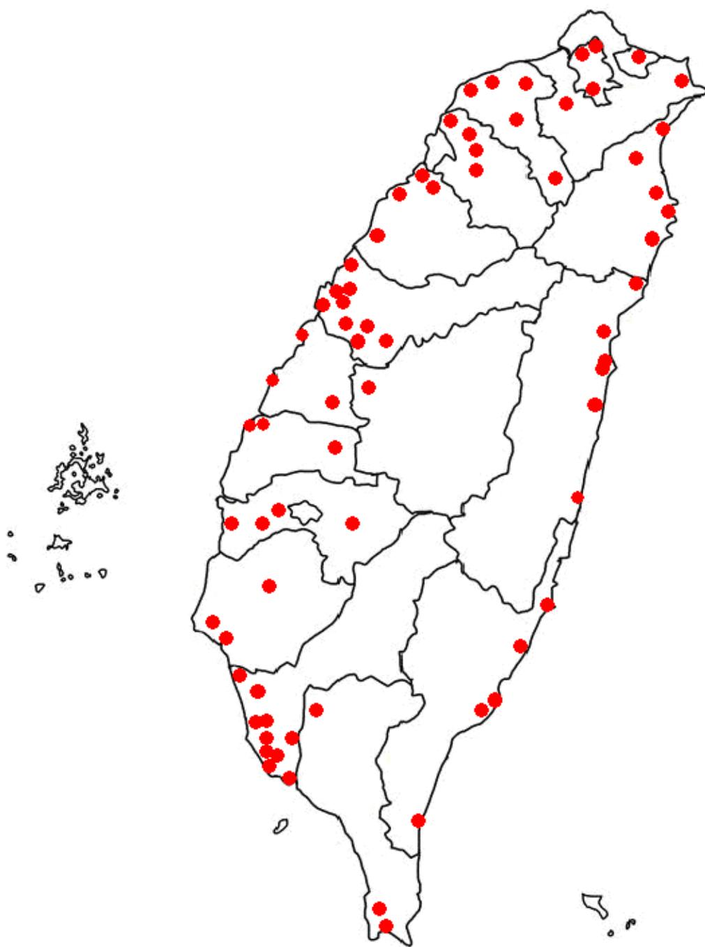
圖 2-3 現地暴露試驗(碳鋼、鋅、鋁、銅螺旋狀試片)點分佈圖
