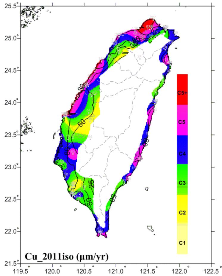
圖 6-27 2011 銅年腐蝕速率 ISO 分類圖
