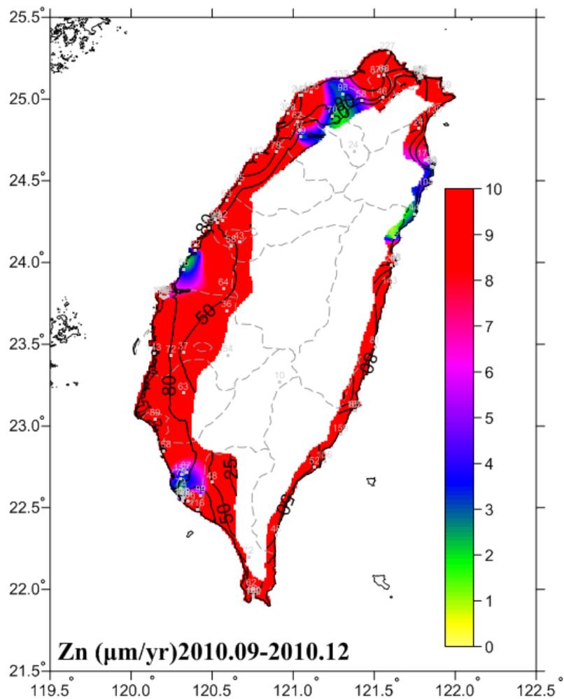
圖 6-13 2010.09-2010.12 鋅腐蝕速率圖
