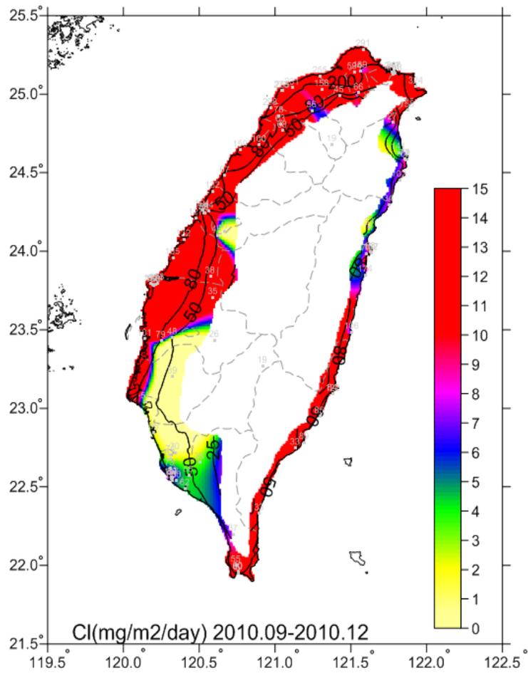
圖 4-1 2010.09-2010.12 氯鹽沉積速率(mg/m<sup>2</sup>/day)
