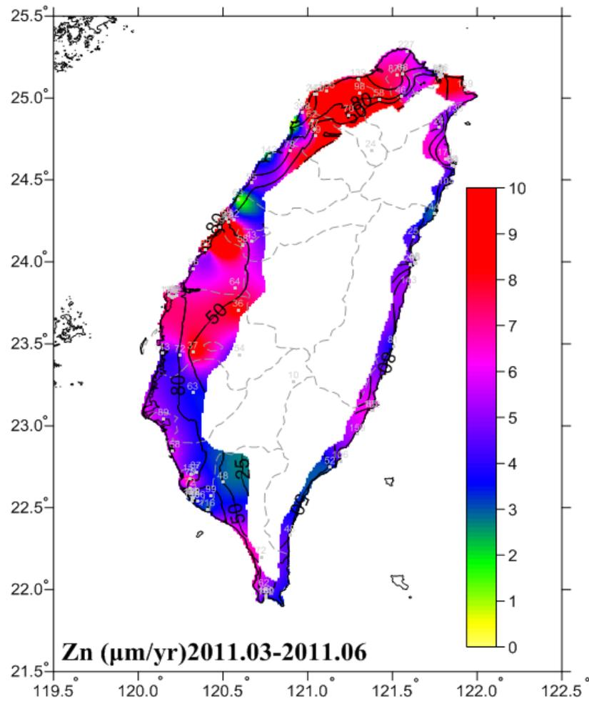
圖 6-15 2011.03-2011.06 鋅腐蝕速率圖
