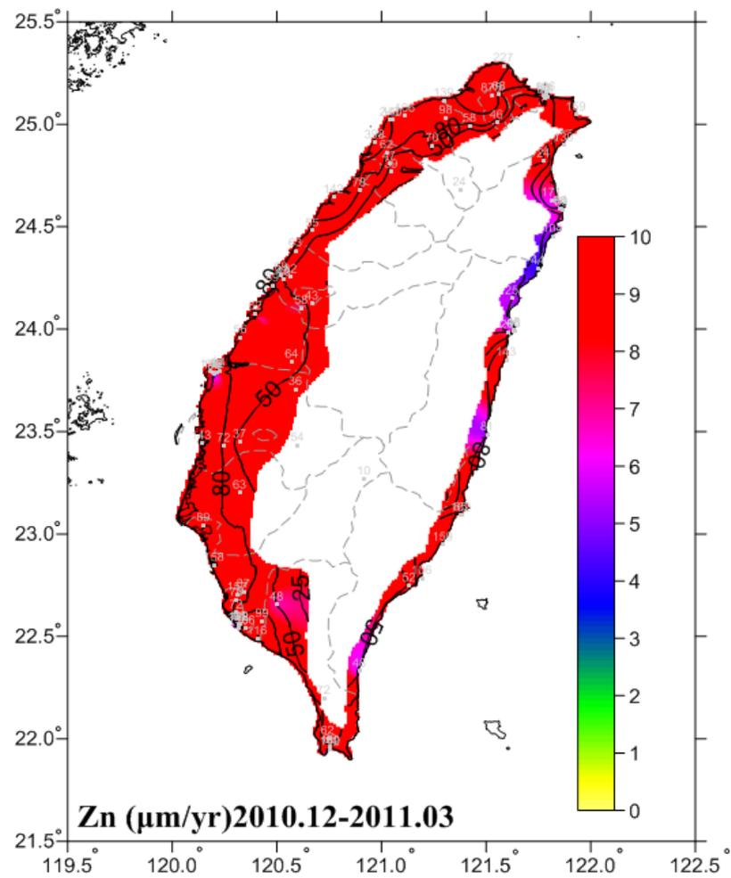
圖 6-14 2010.12-2011.03 鋅腐蝕速率圖
