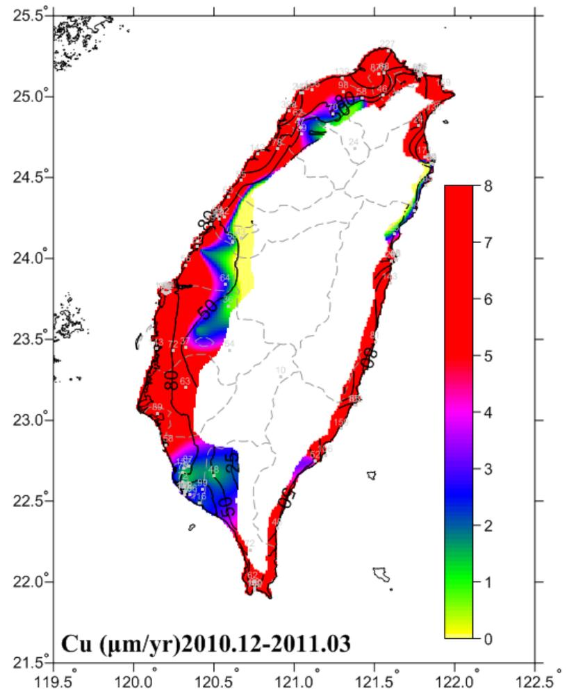
圖 6-18 2010.12-2011.03 銅腐蝕速率圖
