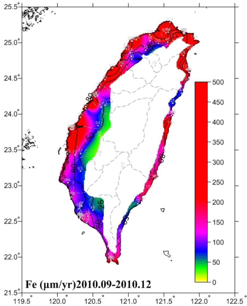
圖 6-9 2010.09-2010.12 碳鋼腐蝕速率圖
