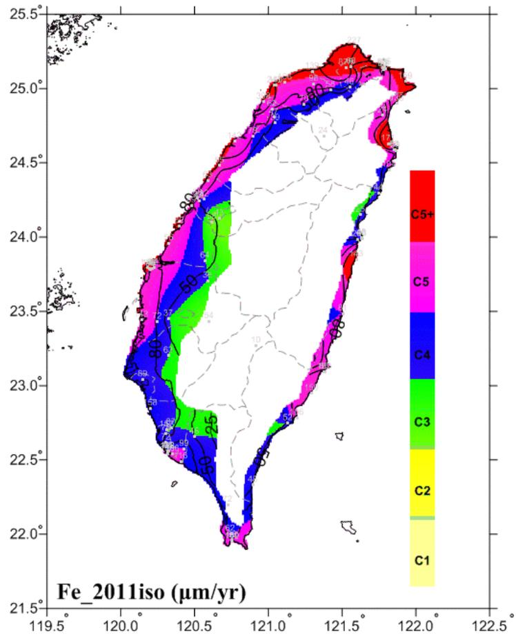
圖 6-25 2011 碳鋼年腐蝕速率 ISO 分類圖
