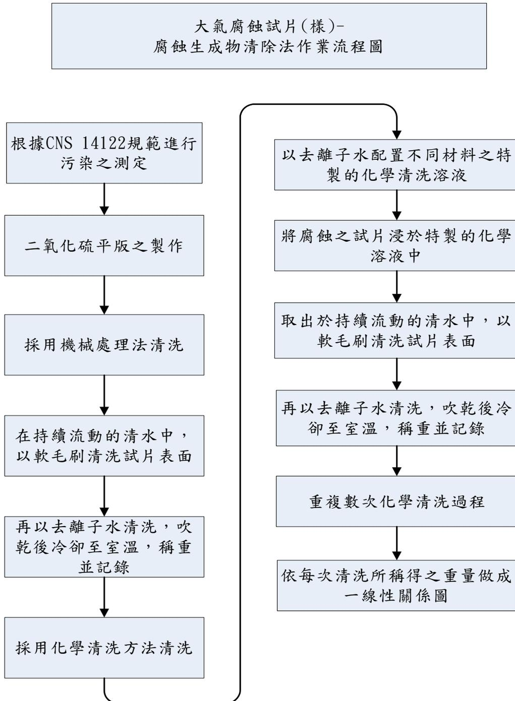
圖 1-6 腐蝕生成物清除法作業流程圖
