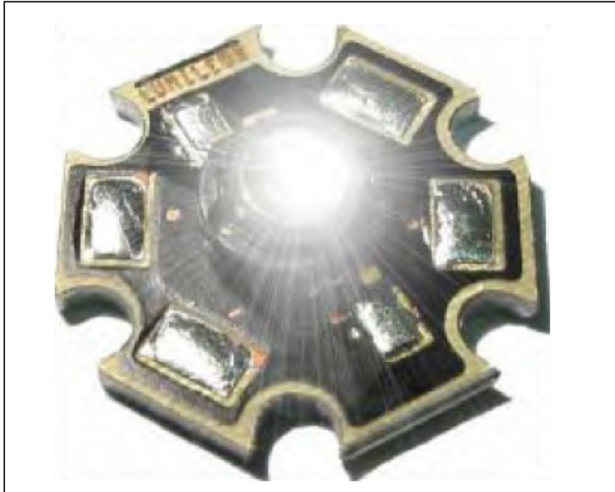
圖 3.5-6 Philips Lumileds Luxeon 封裝結構
