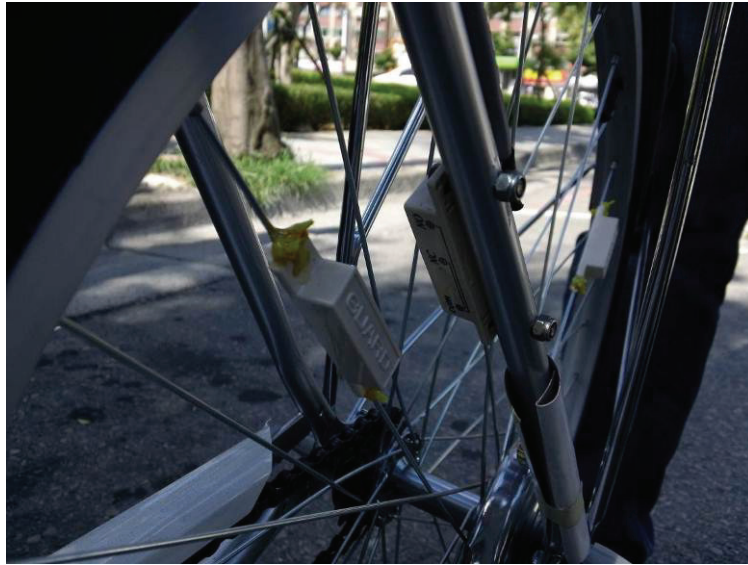
圖 3-9 裝置在輪幅上的近接開關
