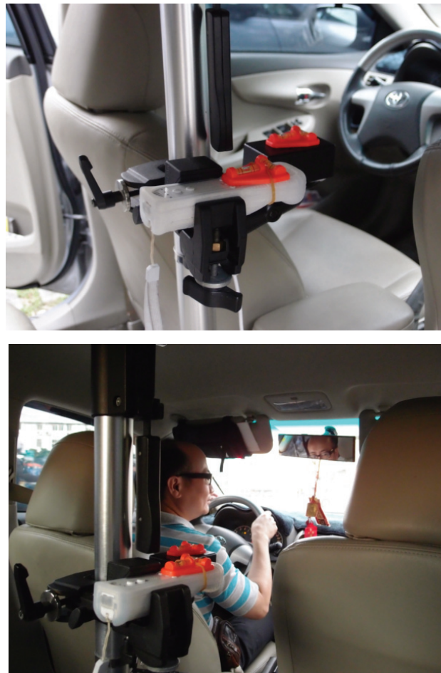
圖 3-44 加速度計架設情形
