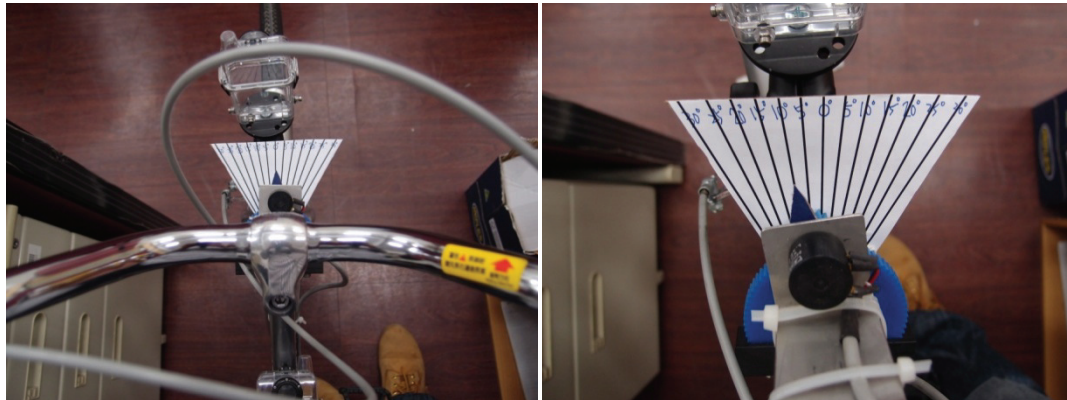
圖 3-49 測量龍頭轉角角度值實驗情形
