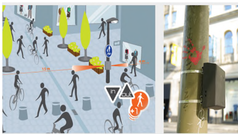
圖 2.34 被動式紅外線熱電感應偵測[14]
