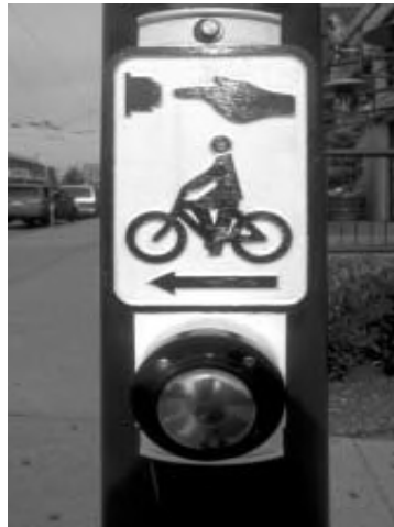
圖 7.4 自行車專用穿越手動觸控裝置(美國)[35]
