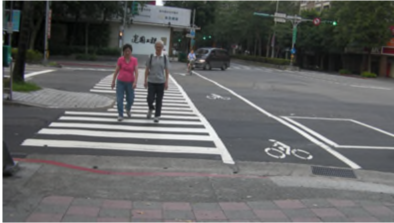
圖 3.50 自行車穿越道與行人穿越道合併
