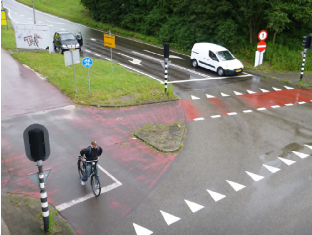
圖 2.18 視距較佳的自行車停止線設計
