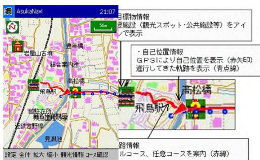
圖 7.11 自行車定位與路徑導引畫面使用狀況(日本奈良縣)[32]
