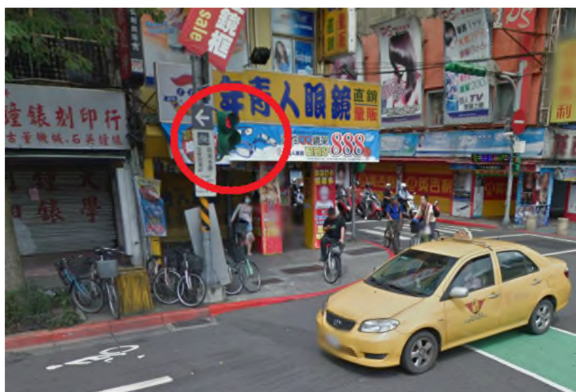
圖 6.32 自行車專用號誌與倒數計時顯示器(羅斯福路與新生南路路口)
