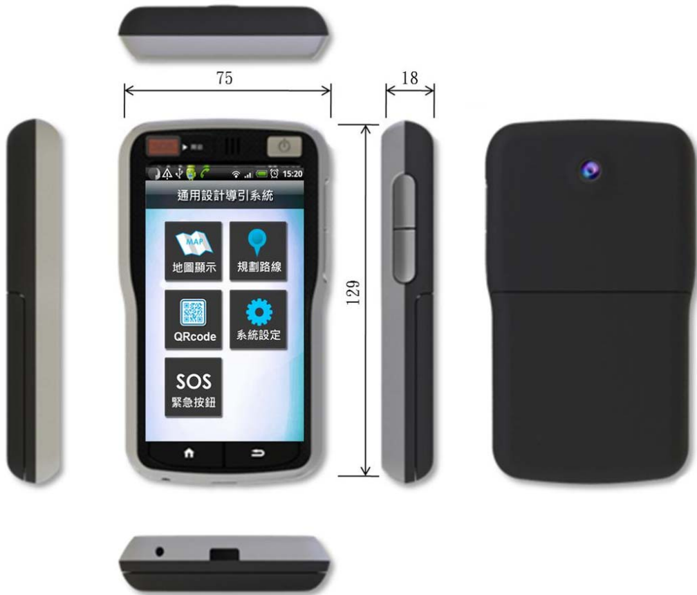
圖 4- 14 概念設計(三)裝置尺寸圖(單位:mm)
