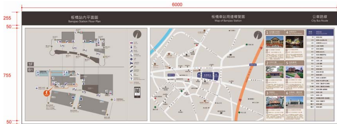
圖 4- 53 壁面燈箱尺寸(單位:mm)
