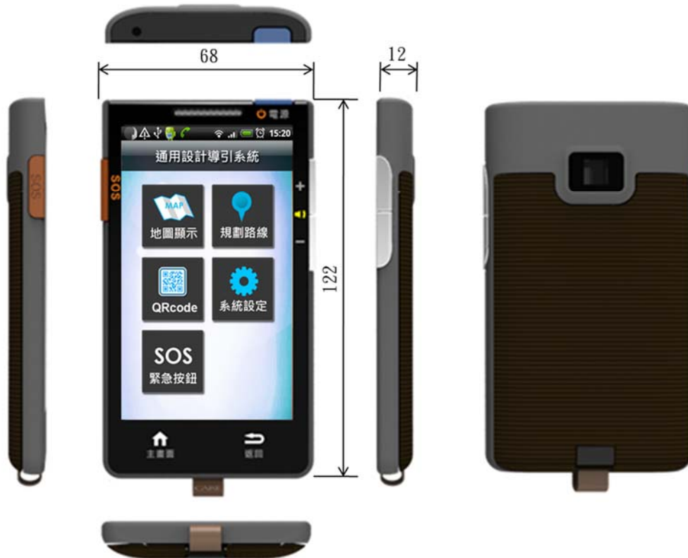
圖 4-13 概念設計(二)裝置尺寸圖(單位:mm)
