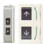
具弧度的按鍵設計，以觸覺即可了解方向性 電梯操作盤按鍵斜上5度，讓各種人而言容易看見與使用的按鍵配置和角度
