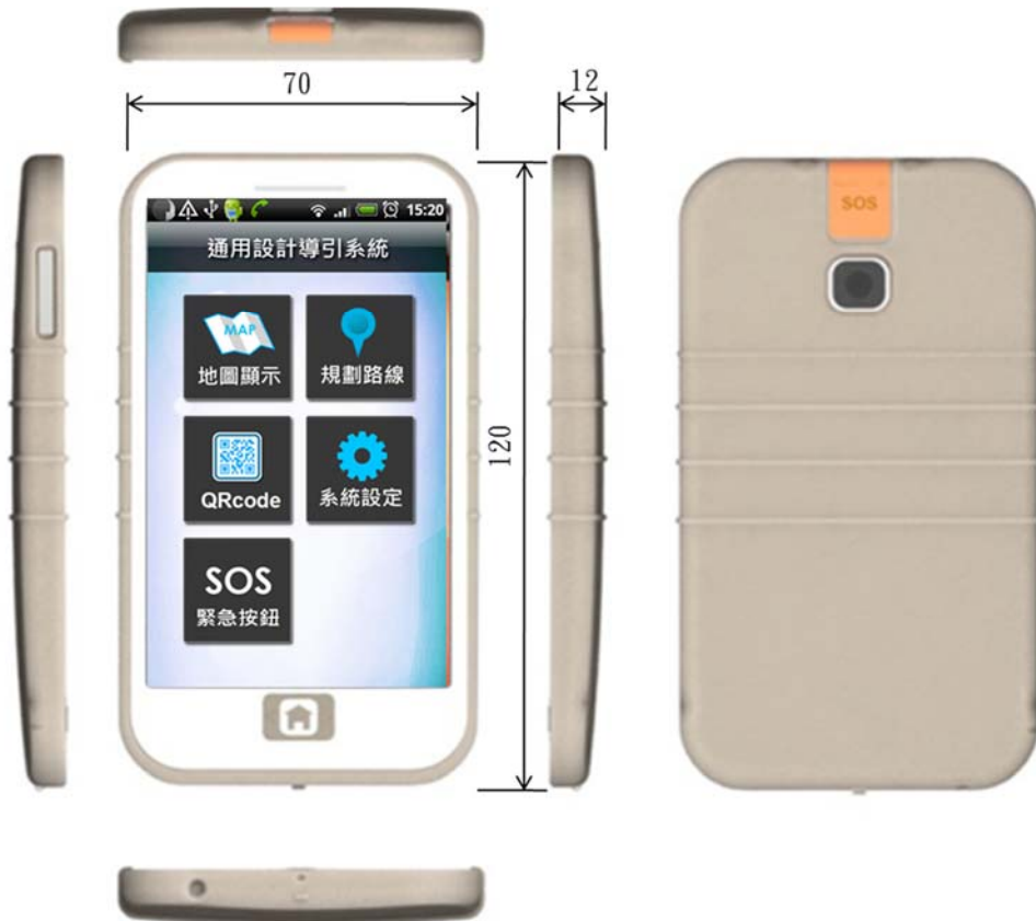
圖 4- 15 概念設計(四)之尺寸圖(單位:mm)
