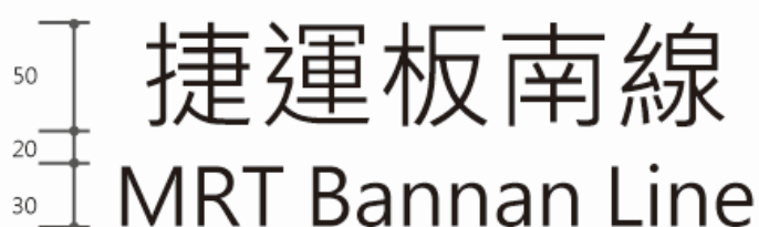
圖 4- 58 頂掛燈箱之符碼下小型文字尺寸(單位:mm)
