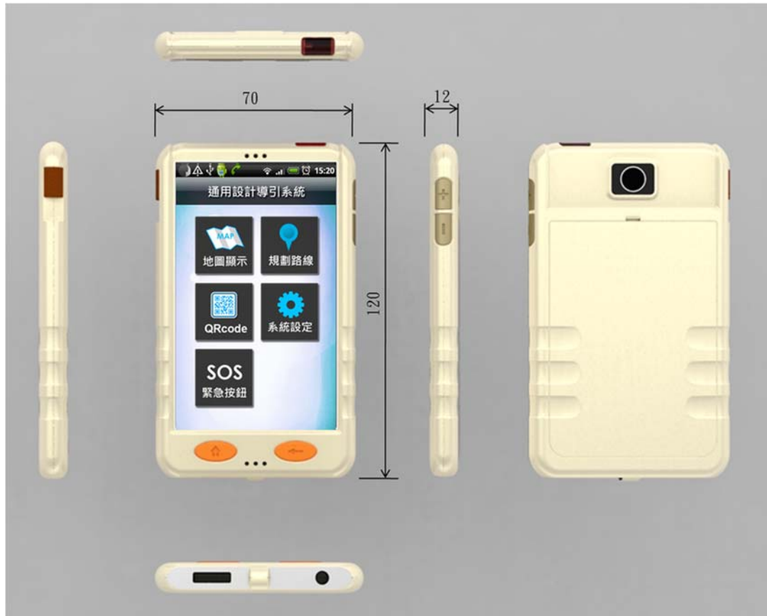
圖 4- 12 概念設計(一)裝置尺寸圖(單位:mm)
