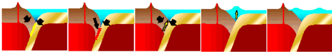
圖 2.6 板塊交界處發生錯動後引起海嘯之示意圖
