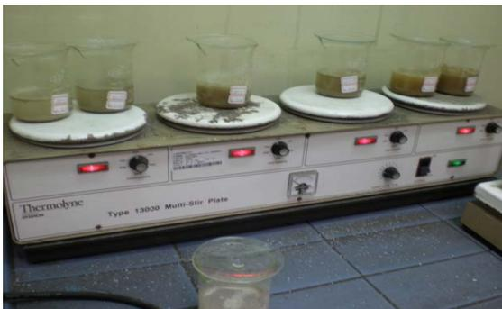
圖 4.9 混凝土粉末浸泡於蒸餾水煮沸
