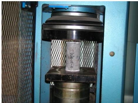
圖 4.7 試體之抗壓試驗
