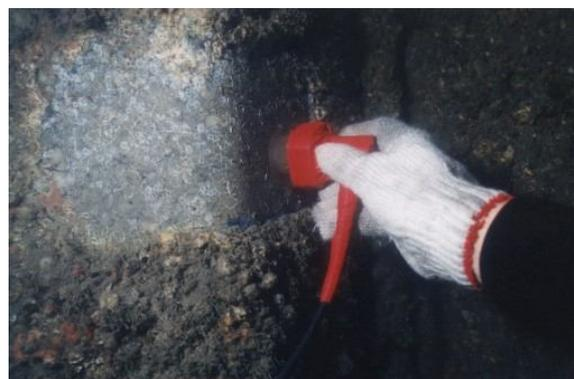
圖 3.9 鋼版樁厚度檢測情形
