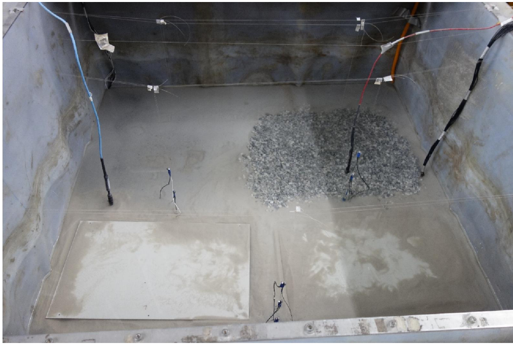
圖 4.12 CASE02 人工回填基礎礫石
