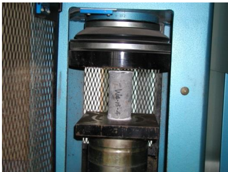
圖 4.7 試體之抗壓試驗
