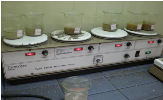
圖 4.9 混凝土粉末浸泡於蒸餾水煮沸
