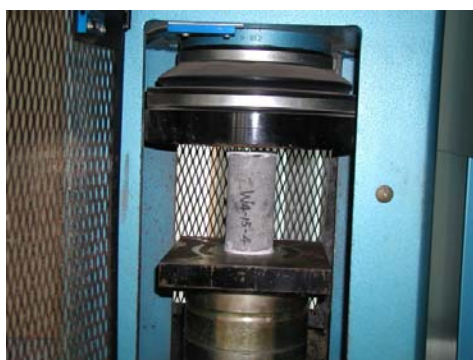
圖 3.17 試體之抗壓試驗
