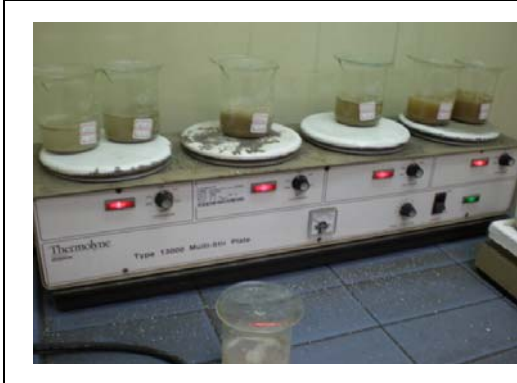
圖 3.19 試樣浸泡於蒸餾水煮沸
