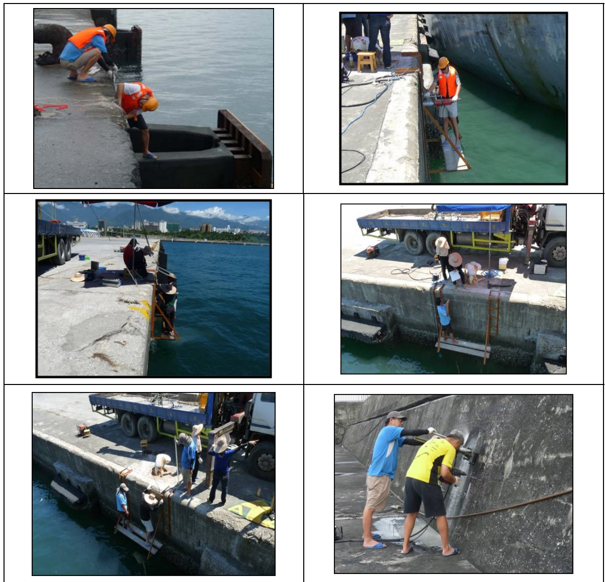
圖 3.44 非破壞性檢測現地作業情形
