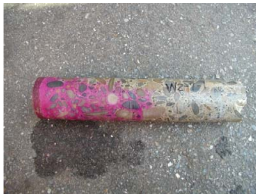
圖 3.14 鑽心試體中性化試驗情形
