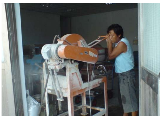
圖 3.15 鑽心試體切割
