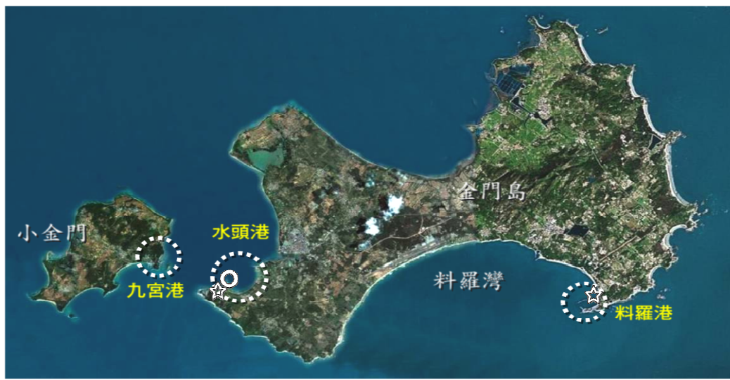
圖 2.5 金門水頭、料羅港海氣象觀測站圖 ☆ 風速儀 ○ 潮位計
