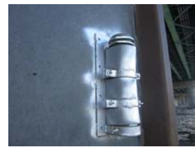
儀器表面破損更換水壓計，並將 鐵架加焊保護蓋及更改水壓計安裝位置
