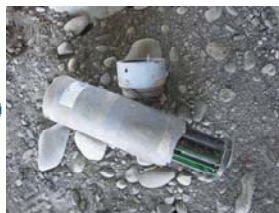
儀器表面破損更換水壓計，並將 鐵架加焊保護蓋及更改水壓計安裝位置
