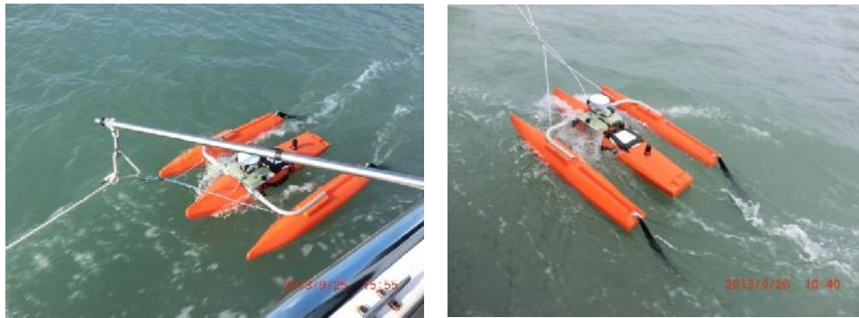
圖 4.2 RiverRay ADCP 在淡水河口量測現況
