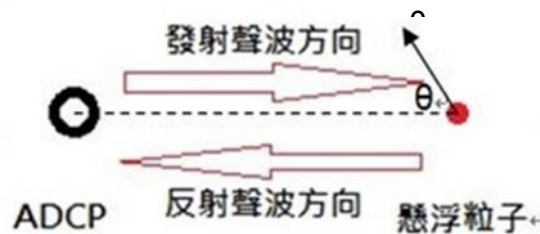
圖 4.3 ADCP 量測粒子速度示意圖
