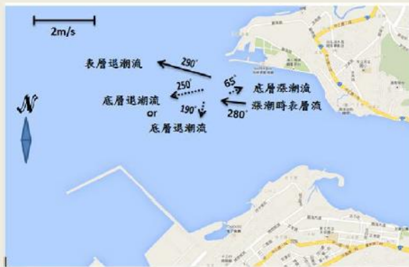
淡水河河口洪流時流況示意圖
