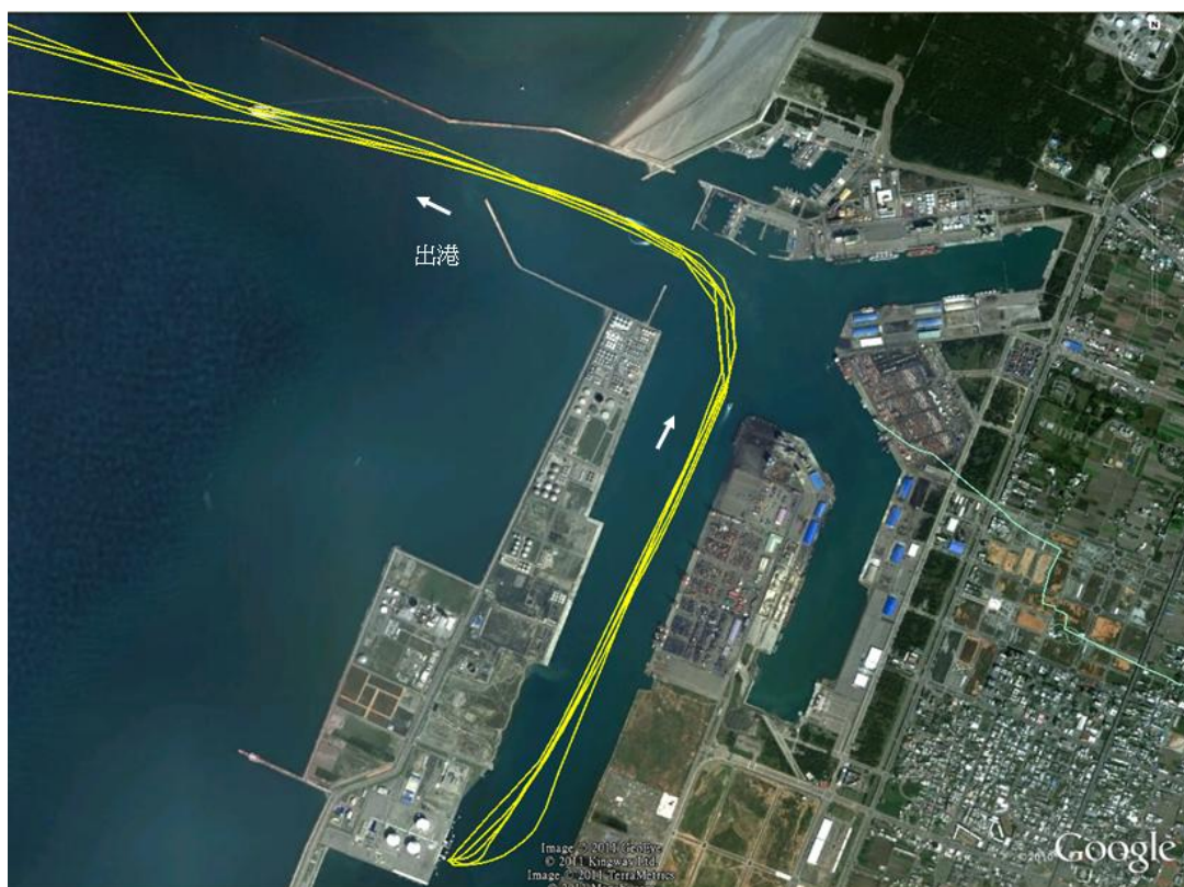
圖 2.25 臺中港 LNG 運輸船出港軌跡
