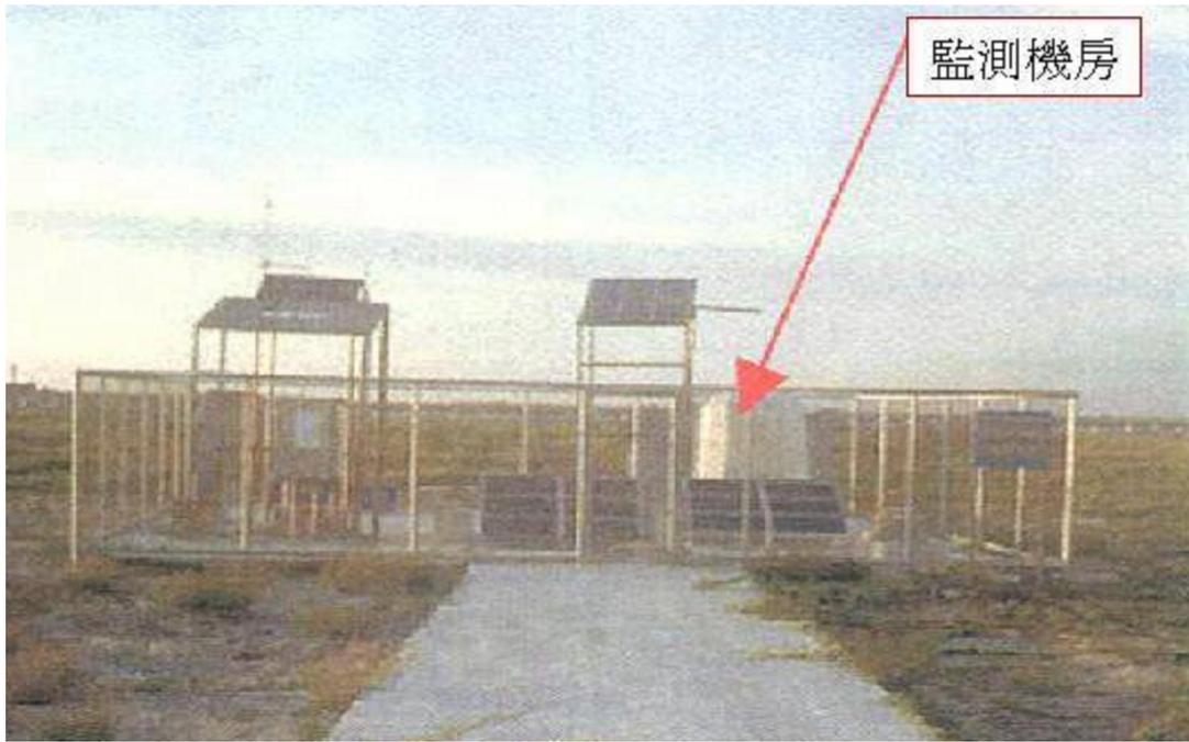
圖 2.9 布袋港區井下地震監測站示意圖
