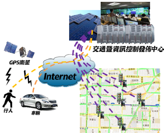
圖7.1-3 傳統交通暨資訊控制發布系統架構示意圖
