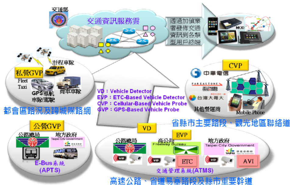
圖4.2.1-1 整合式交通資訊服務架構示意圖
