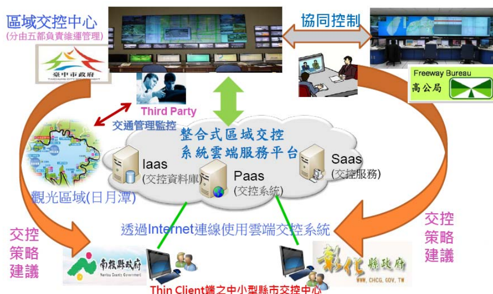
圖4.2.1-2 區域交通控制中心雲端化示意圖
