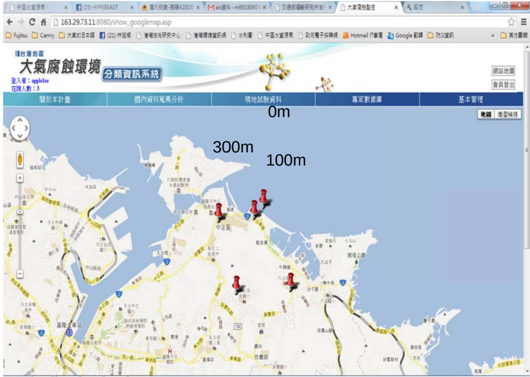
圖 3-117 大氣環境腐蝕因子調查與腐蝕環境地圖(以基隆港為例)
