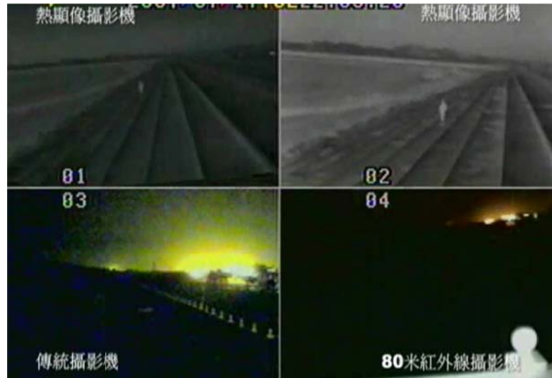
圖 3-93 傳統、紅外線及熱顯影像比較圖
