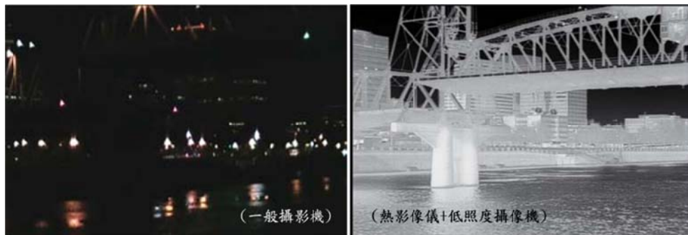
圖 3-94 一般攝影機與熱影像儀+低照度攝影機比較
