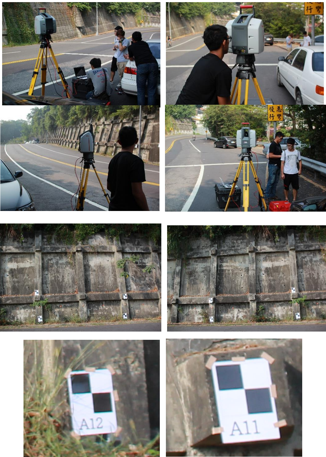
圖 5.33 Lidar 掃瞄作業情形
