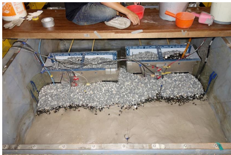
圖 3.15 分三層依序注水、回填礫石、砂土
