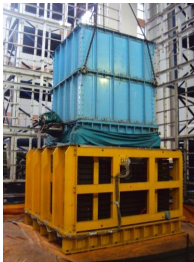
圖 3.5 以貫落裝置進行試體準備
