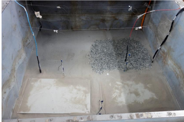
圖 3.14 海床質降完成後，CASE01 基礎砂土換置成礫石
