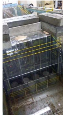
模型架設於水槽中情形
