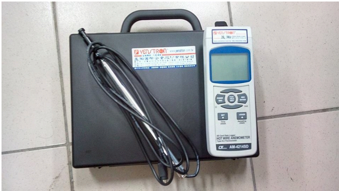
圖 7.9 氣流速度計(產品代號：AM.4214SD)
