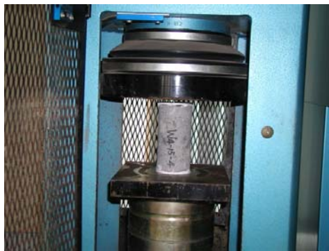
圖 3.7 試體之抗壓試驗
