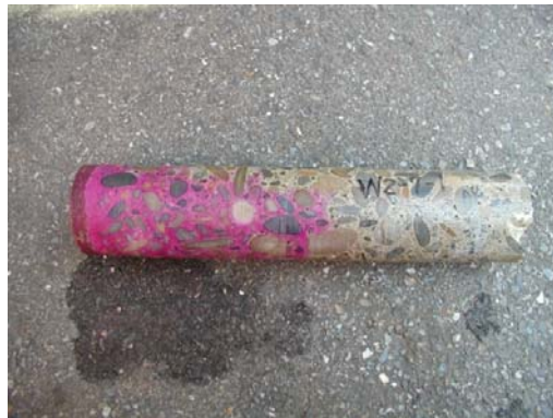
圖 3.4 鑽心試體中性化試驗情形
