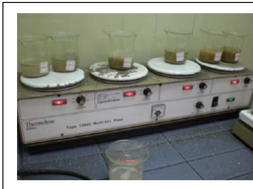
圖 3.9 試樣浸泡於蒸餾水煮沸
