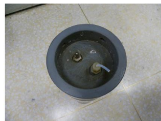
壓力式波浪儀溫度及壓力感測器
