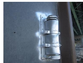
儀器表面破損更換水壓計，並將 鐵架加焊保護蓋及更改水壓計安裝位置 (102年10月7日)
