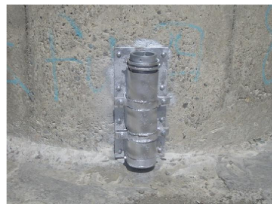
c. 換新電池後再安裝水壓計
