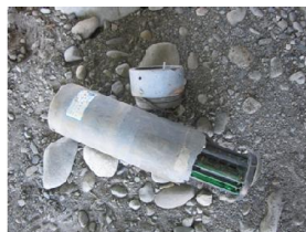
儀器表面破損更換水壓計，並將 鐵架加焊保護蓋及更改水壓計安裝位置 (102年10月7日)
