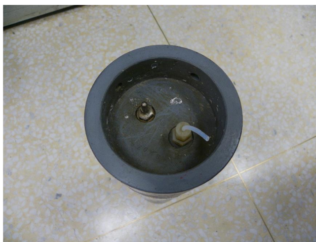
圖 2.3 壓力式波浪儀溫度及壓力感測器
