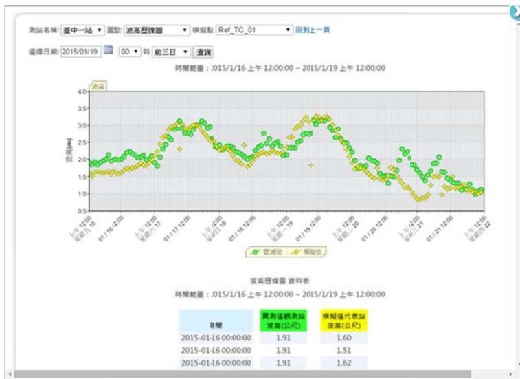
圖 2.61 展示臺中港波浪模擬 (大尺度、中尺度、小尺度) 歷線圖
