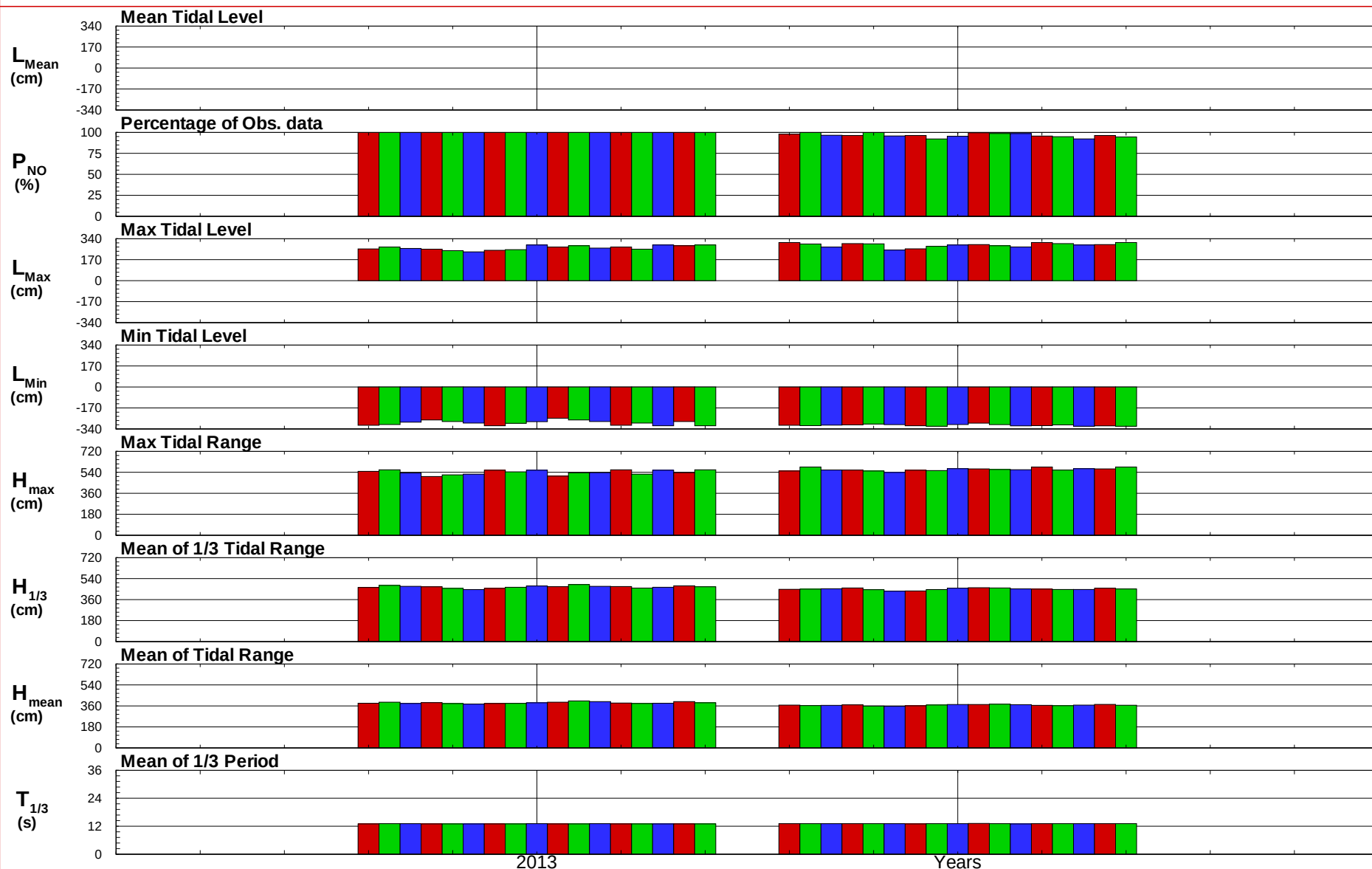
圖 6.3.4 臺中港 T 站 2013 及歷年每月 (季) 潮位統計量比較圖
