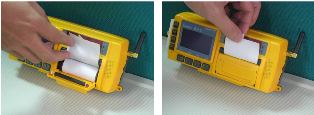
圖 B- 15 列印用紙卷安裝與更換操作步驟二
