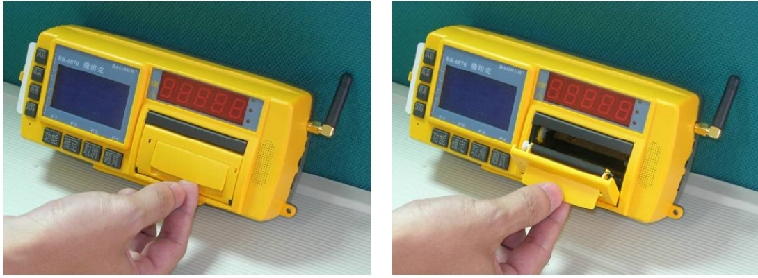
圖 B- 14 列印用紙卷安裝與更換操作步驟一
