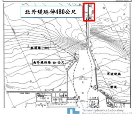
圖3-1-11 北外堤延伸段平面圖
