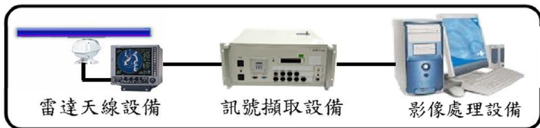
圖 2.2 雷達監測系統架構
