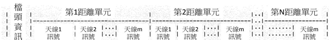
圖 2.52 WERA 高頻雷達天線回波原始資料之結構
