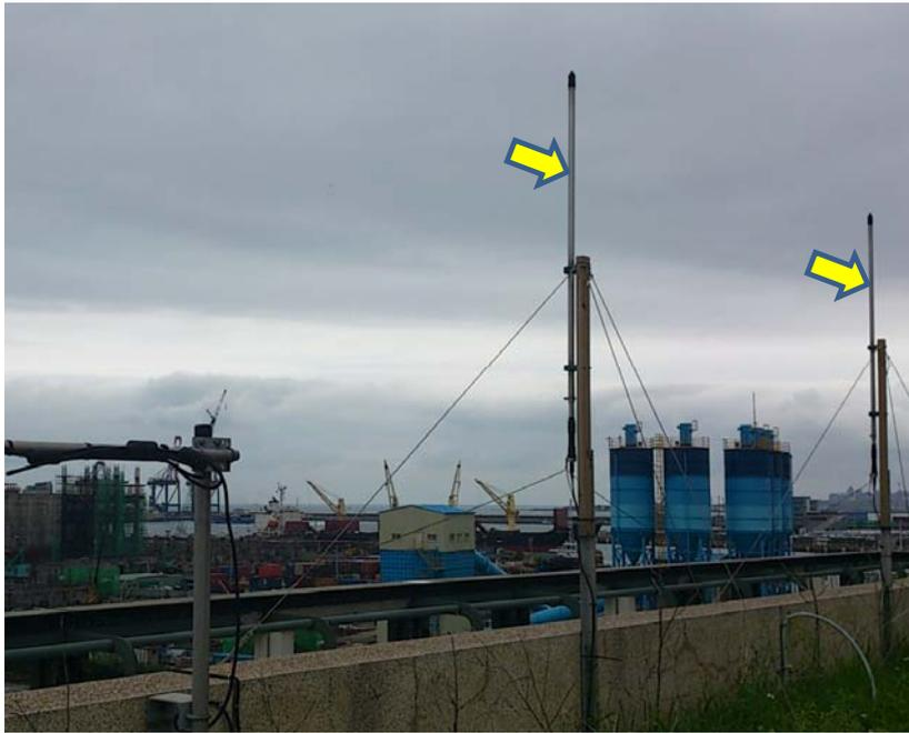
圖 2.50 臺北港 WERA 高頻雷達觀測系統天線(箭頭處)
