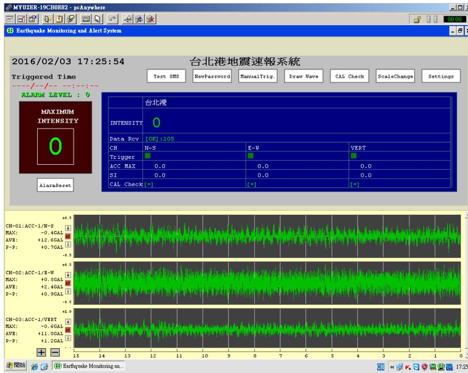
圖 5.29 臺北港區地震即時監測加速度歷時圖
