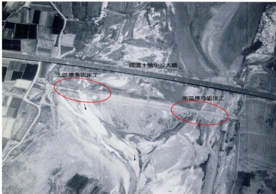
圖 3.3 中沙大橋下游固床工
