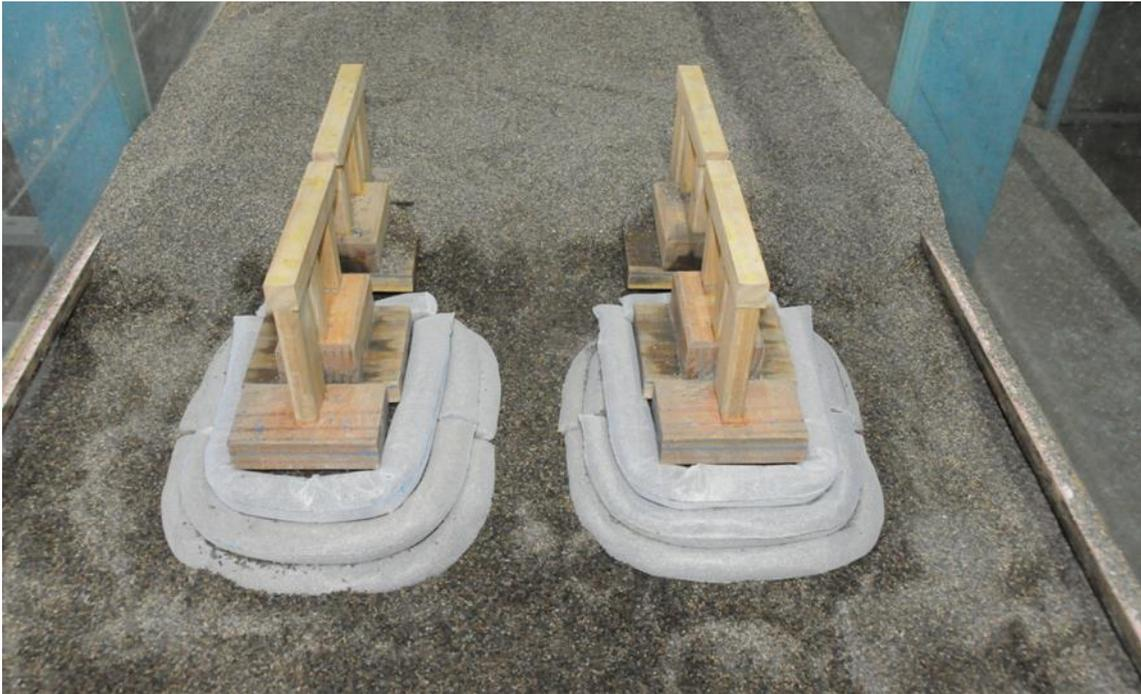
圖 6.52 三層斜坡砂腸袋鋪設
