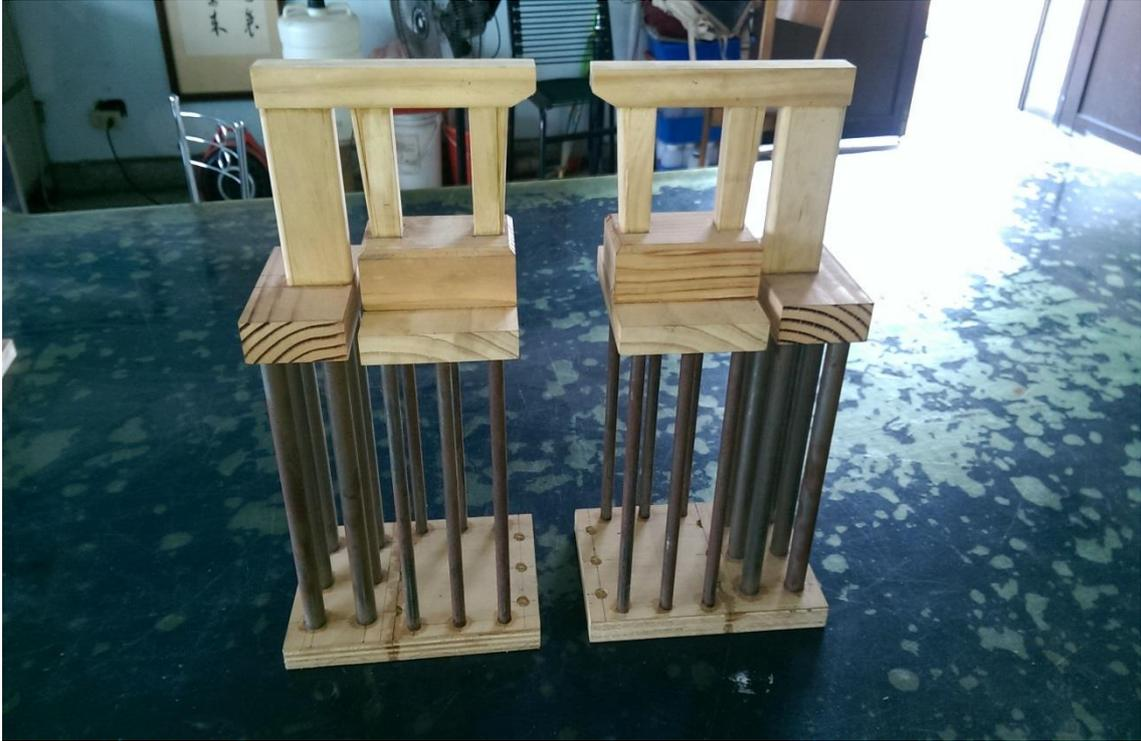
圖 5.10 試驗橋墩模型照片
