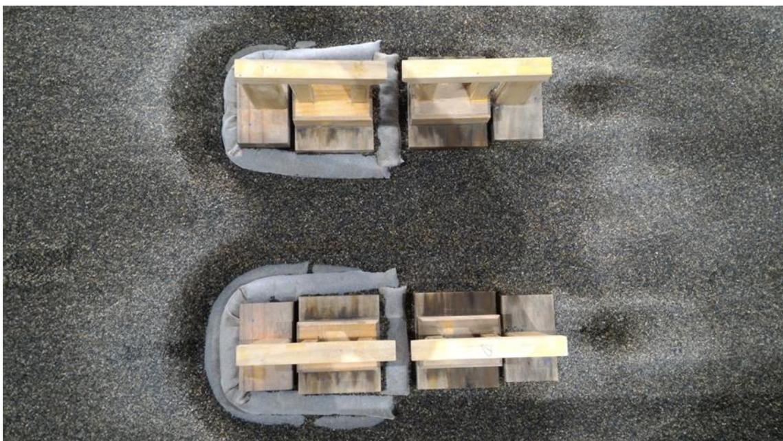
圖 6.55 三層斜坡砂腸袋基礎沖刷情形
