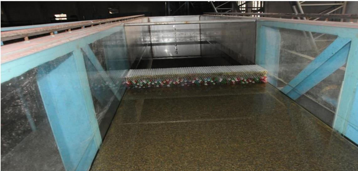
圖 5.11 吸管製成之蜂巢式整流器
