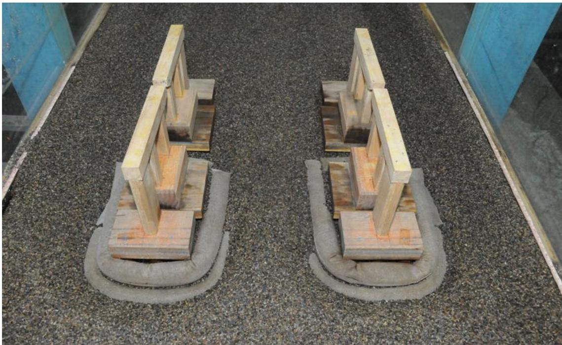
圖 6.39 二層斜坡砂腸袋基礎沖刷情形
