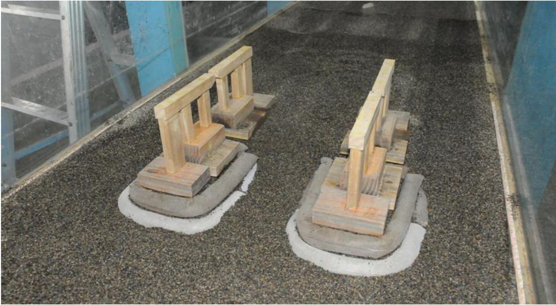
圖 6.36 二層斜坡砂腸袋鋪設
