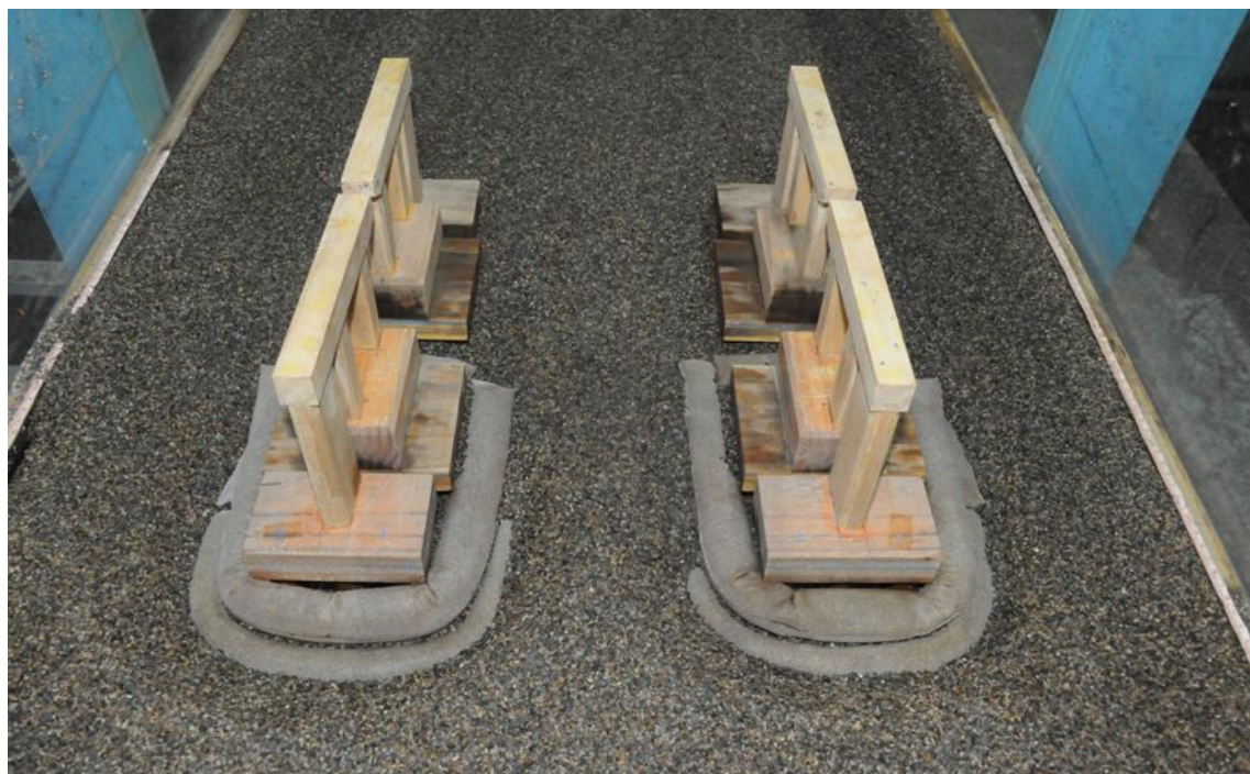
圖 7.39 二層斜坡砂腸袋基礎沖刷情形
