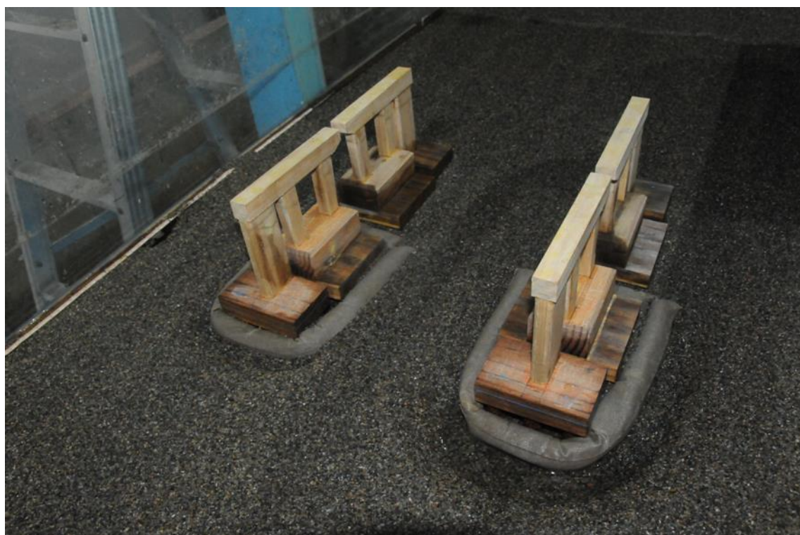
圖 7.23 一層砂腸袋(底床下 1.5 公分)基礎沖刷情形
