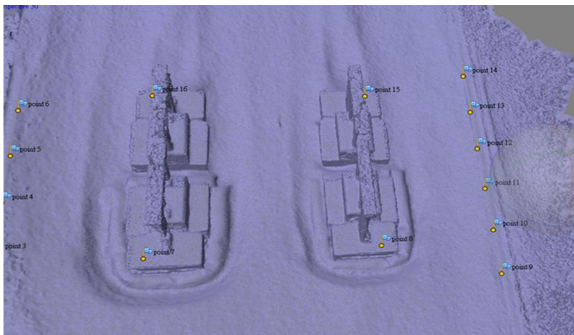
圖 7.64 一層砂腸袋+織物模板沖刷深度與範圍 3D 圖
