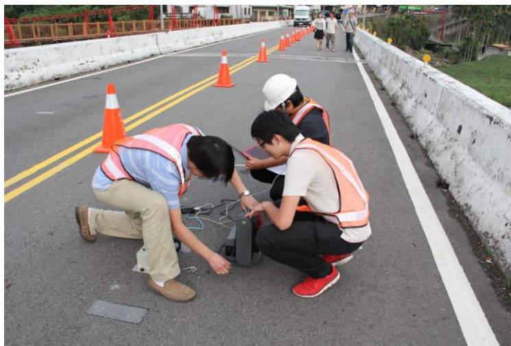
圖 4.12 以備用電源供應筆電與速度計之電力
