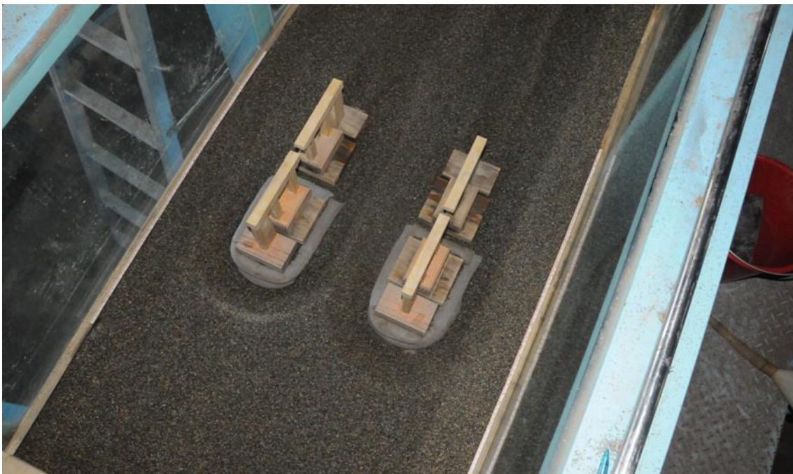
圖 7.47 三層直立砂腸袋基礎沖刷情形
