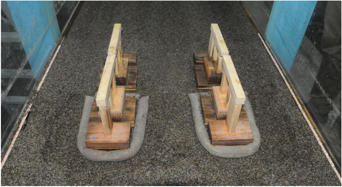
圖 7.12 一層砂腸袋(底床下 0.5 公分)鋪設
