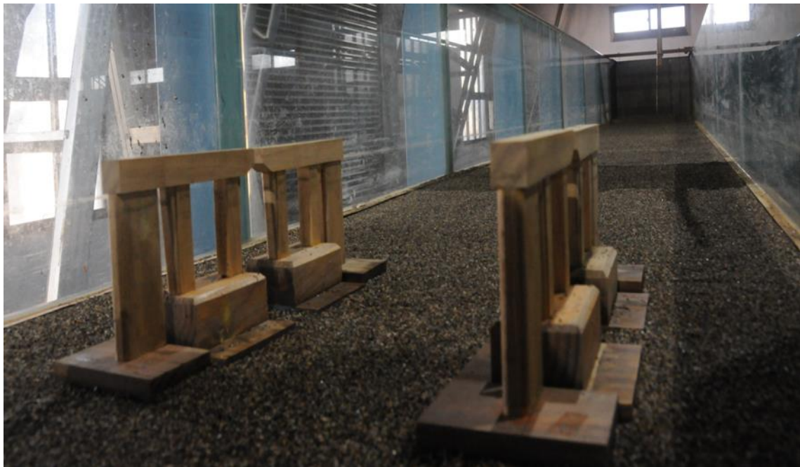
圖 7.3 橋墩鋪設情形
