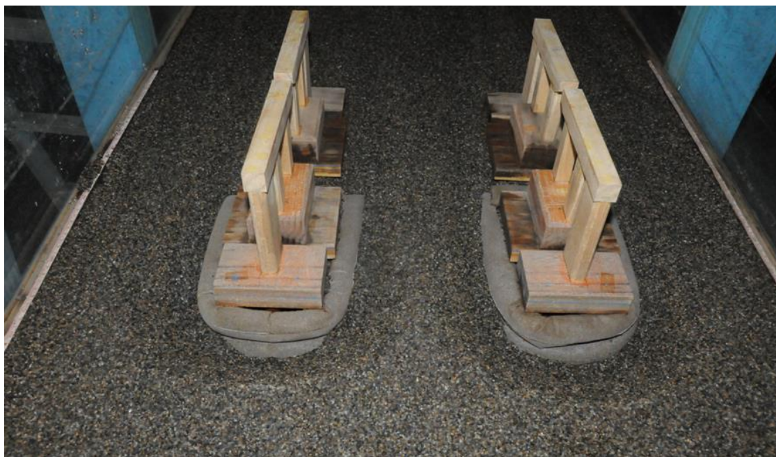
圖 7.31 二層直立砂腸袋基礎沖刷情形
