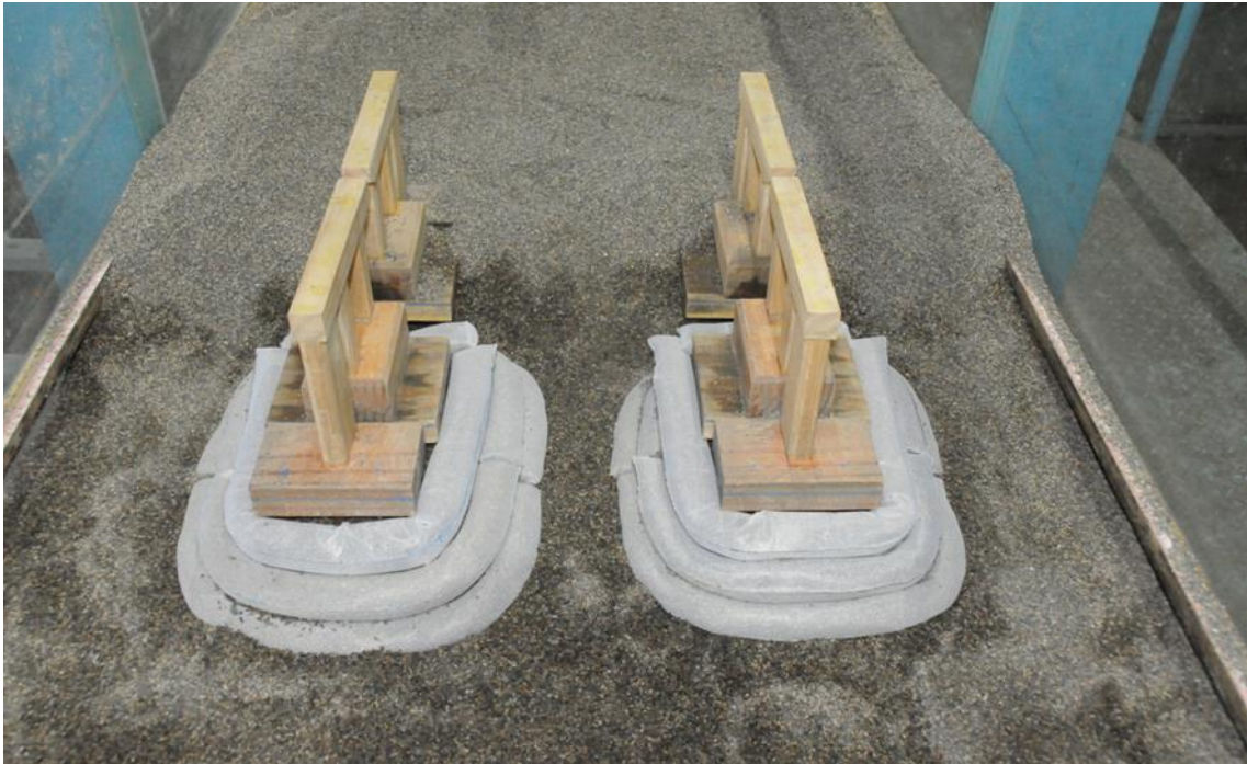
圖 7.52 三層斜坡砂腸袋鋪設
