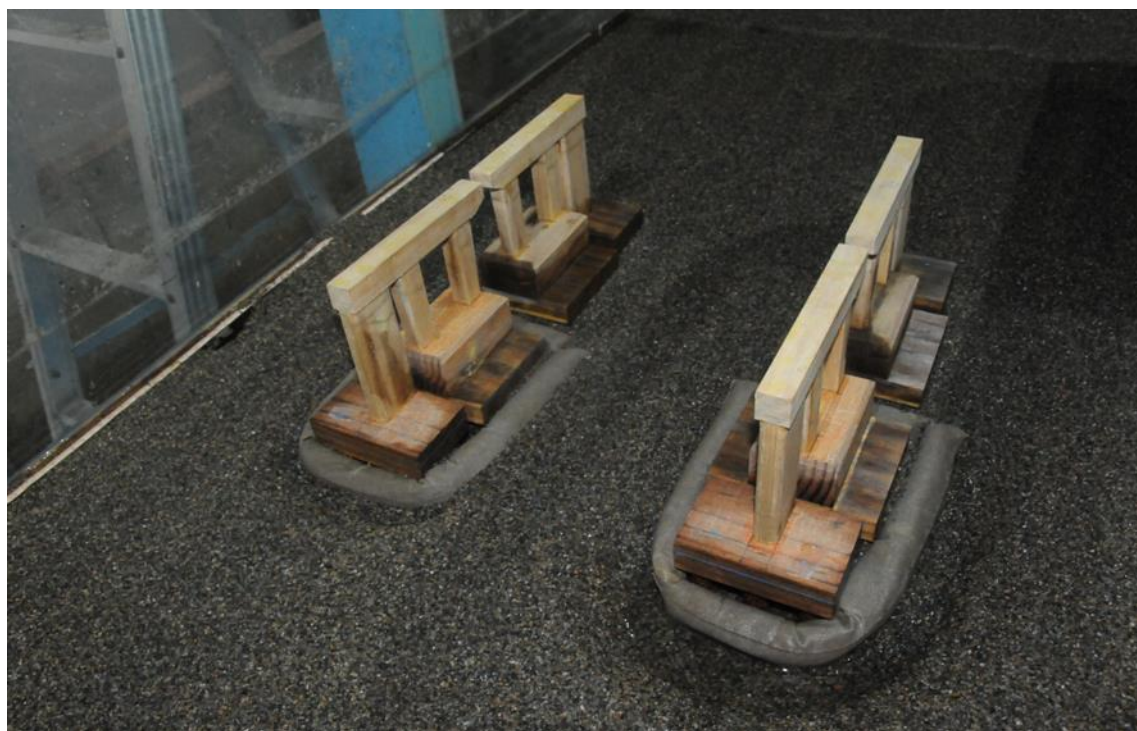
圖 7.15 一層砂腸袋(底床下 0.5 公分)基礎冲刷情形
