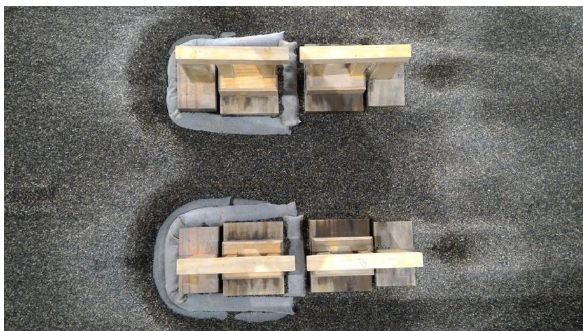
圖 7.55 三層斜坡砂腸袋基礎沖刷情形
