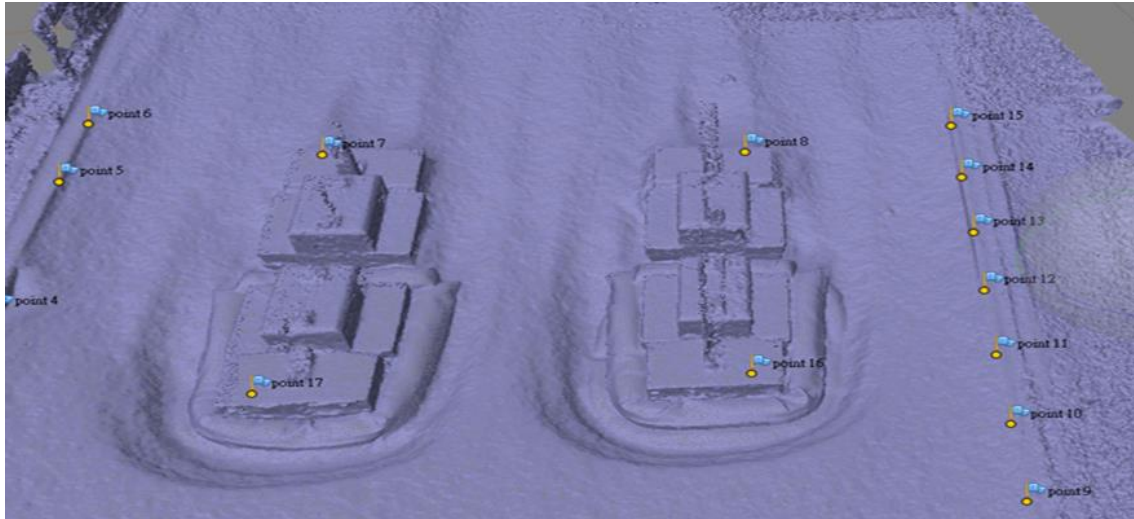
圖 7.56 三層斜坡砂腸袋沖刷深度與範圍 3D 圖
