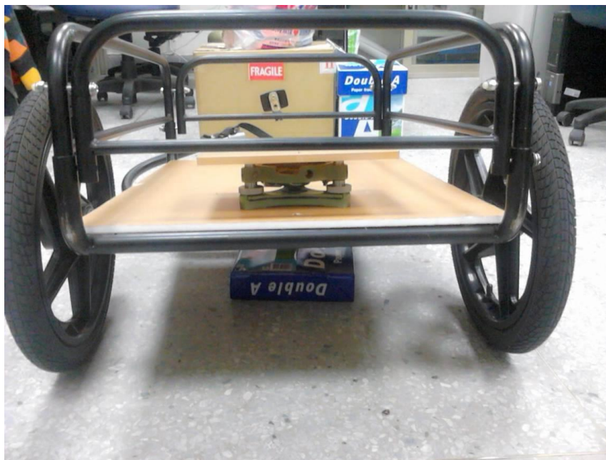
圖 4.14 求心基座之定平設計-後視圖
