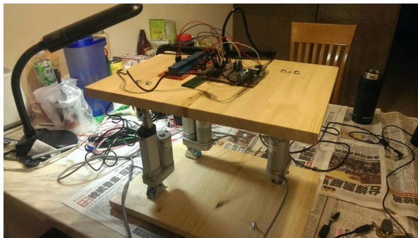
圖 4.10 本團隊初步開發的自動定平機構
