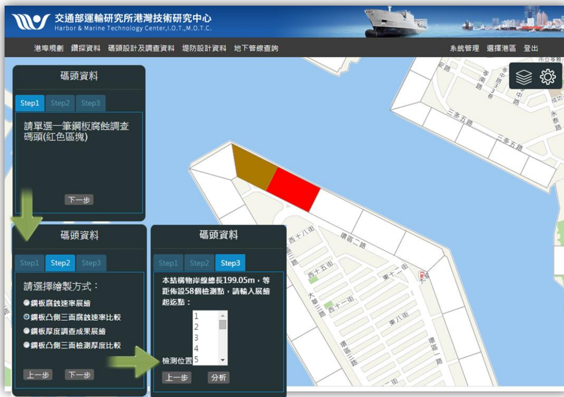
圖 3.28 鋼板凸側凹三面腐蝕速度/檢測厚度比較功能
