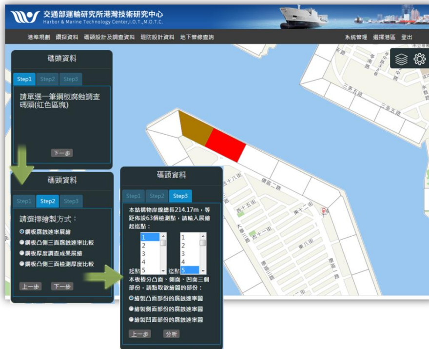
圖 3.26 鋼板腐蝕速率/厚度調查成果展繪功能
