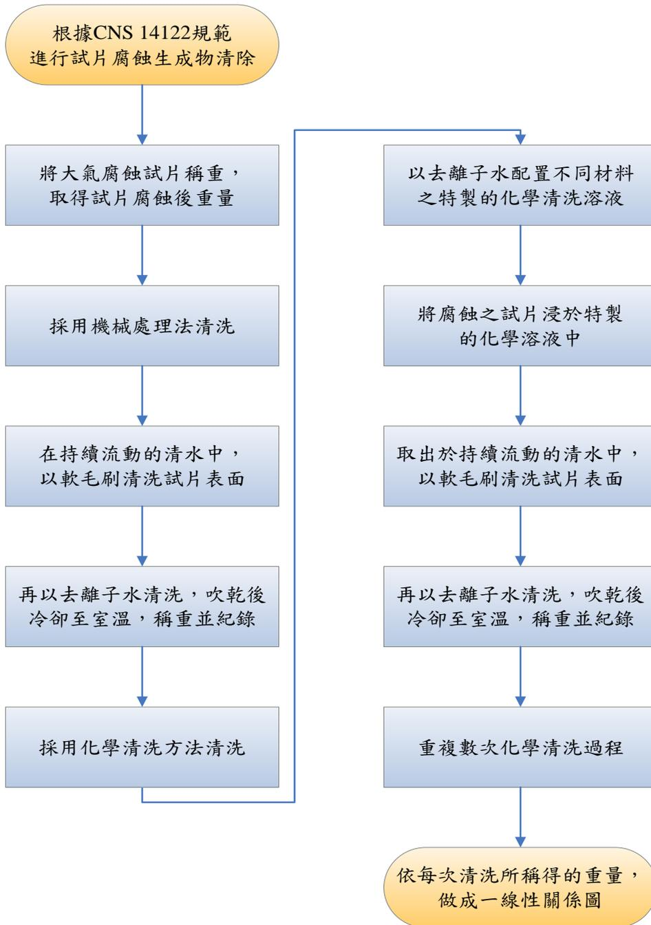
圖 3.9 腐蝕生成物清除法作業流程圖
