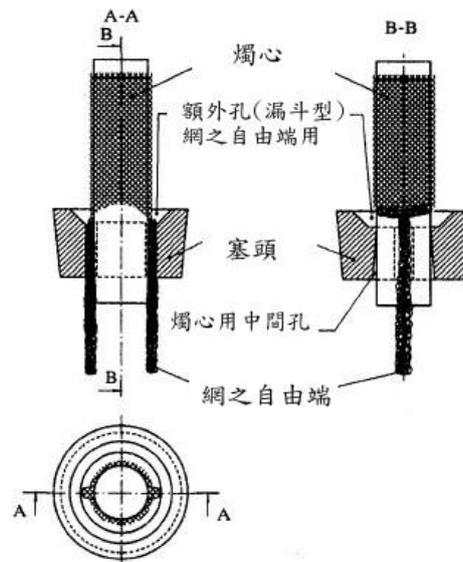
圖 3.3 濕燭法燭心構造示意圖 (CNS 13754)
