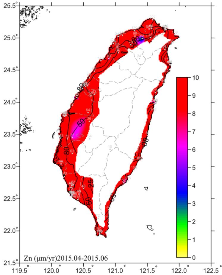
圖 4.20 2015.04-2015.06 鋅腐蝕速率
