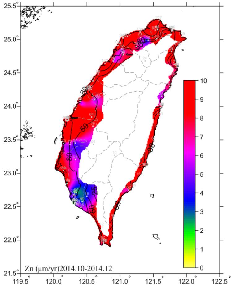
圖 4.18 2014.10-2014.12 鋅腐蝕速率
