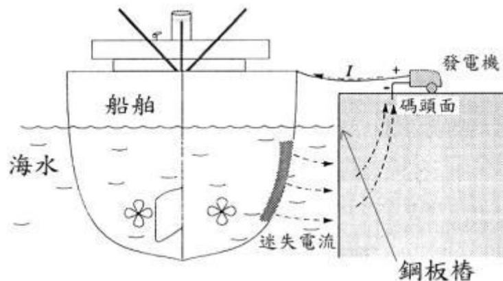
圖 2.9 碼頭鋼板樁遭受迷失電流之情形
