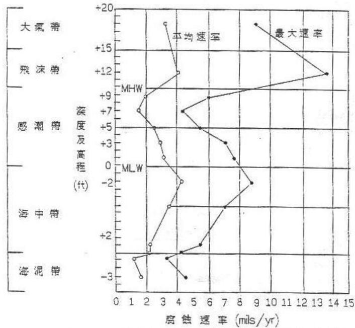
圖 2.4 鋼板樁曝露區域與腐蝕速率之關係
