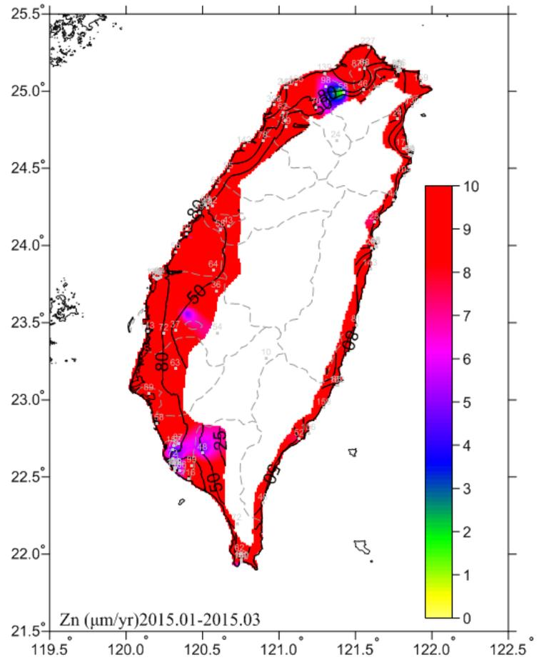
圖 4.19 2015.01-2015.03 鋅腐蝕速率
