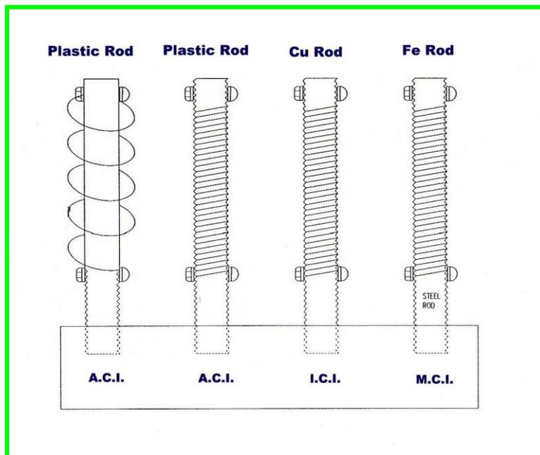
圖 2.2 CLIMATE TEST 大氣腐蝕測試
