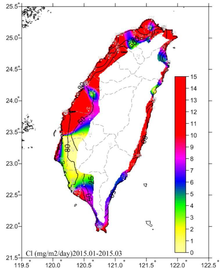
圖 4.2 2015.01-2015.03 氯鹽沉積速率(mg/m<sup>2</sup>/day)
