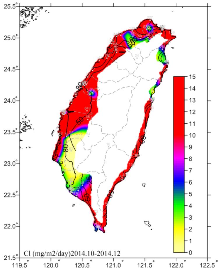
圖 4.1 2014.10-2014.12 氯鹽沉積速率(mg/m<sup>2</sup>/day)
