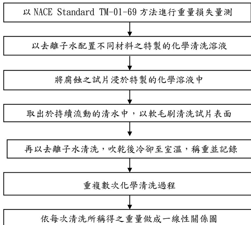
圖 5.6 水下金屬腐蝕生成物清除作業流程圖
