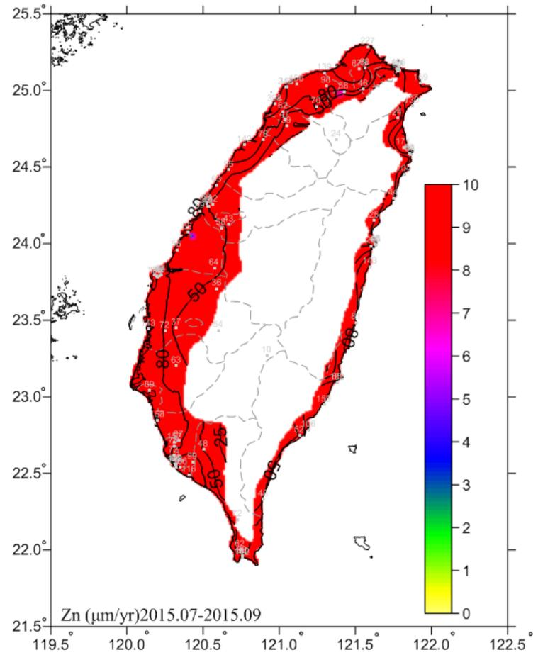
圖 4.21 2015.07-2015.09 鋅腐蝕速率
