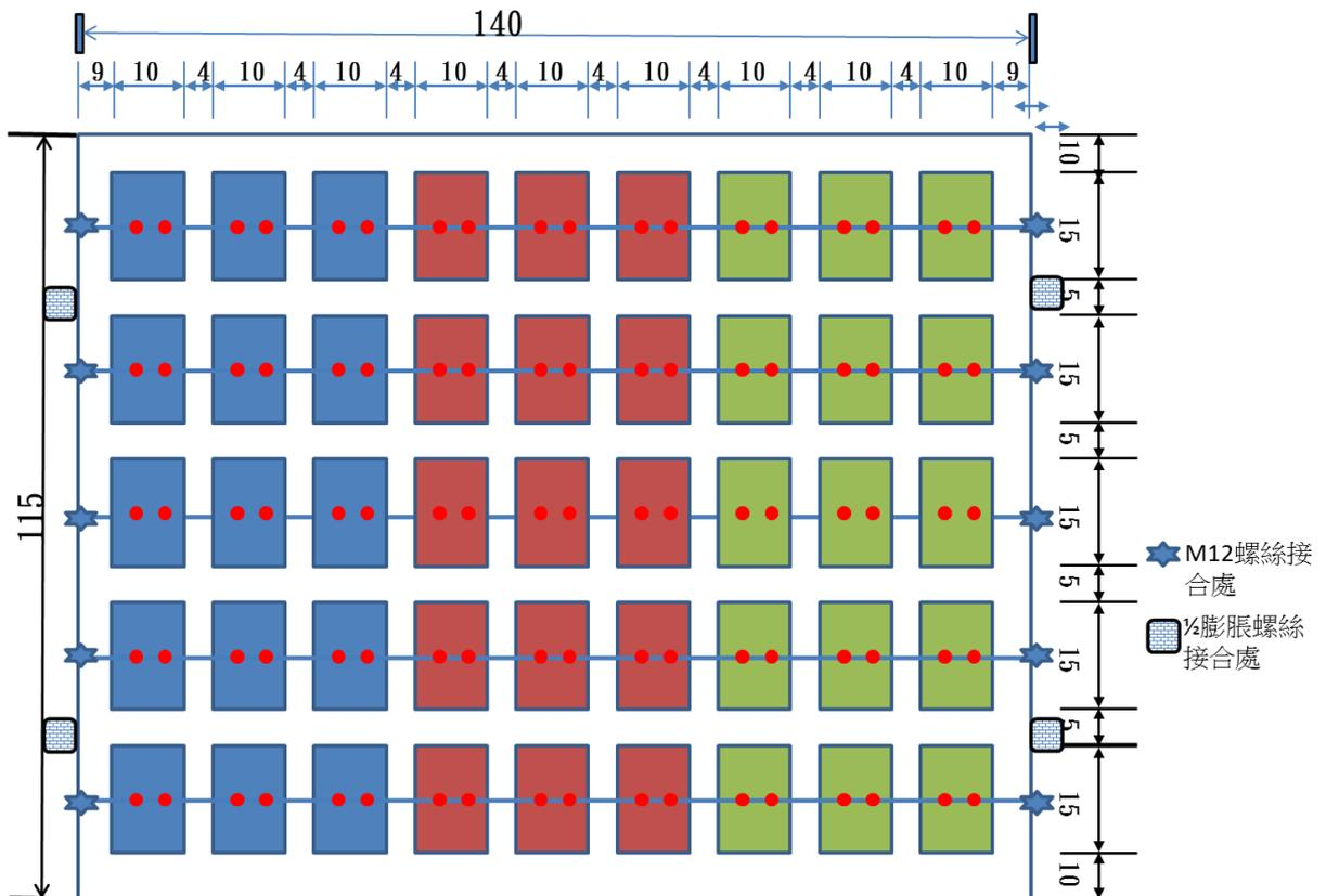
圖5.4.水下金屬腐蝕試驗架示意圖
