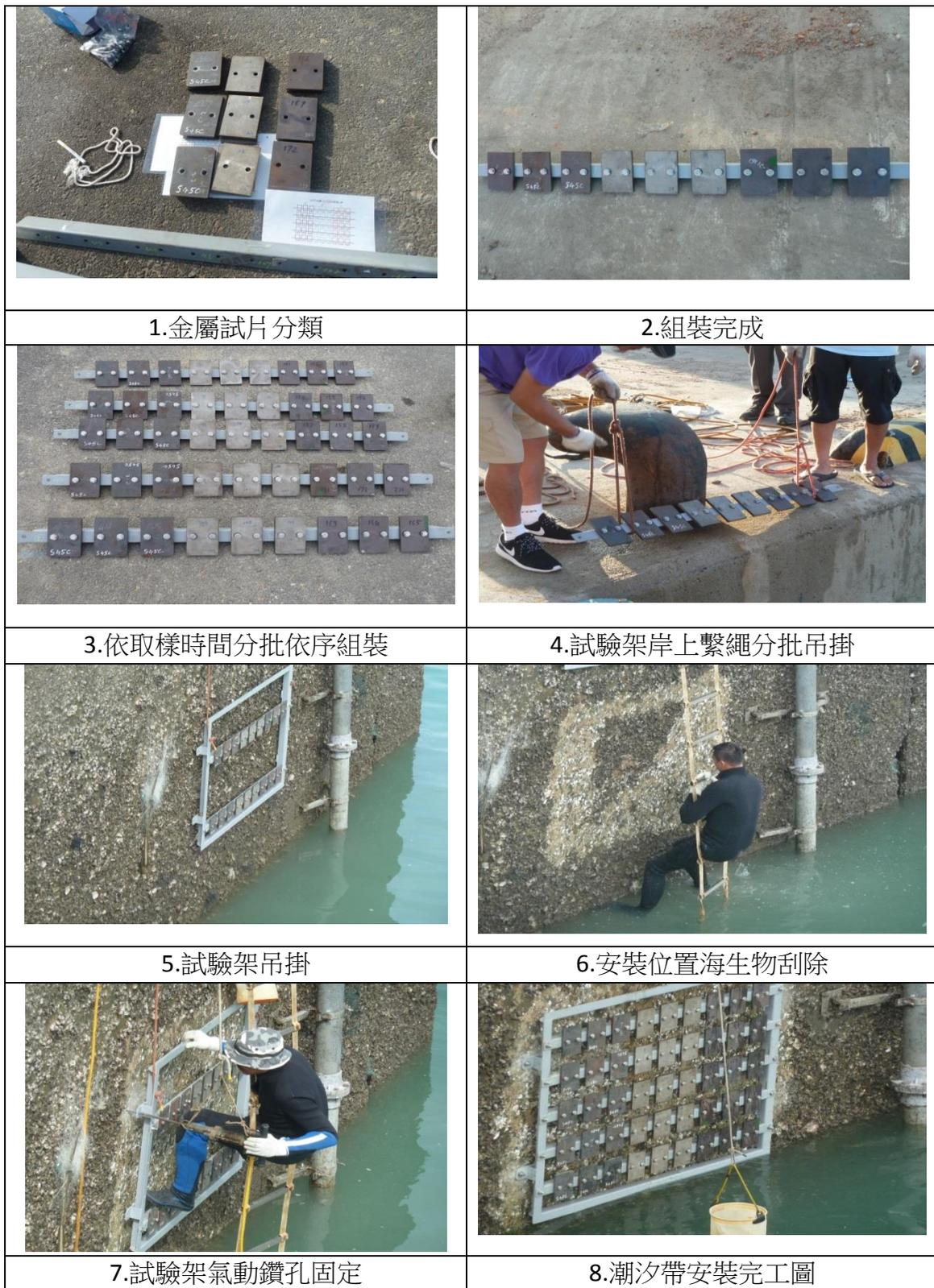
圖5.5 金門料羅港與水頭商港水下金屬曝露試驗架安裝
