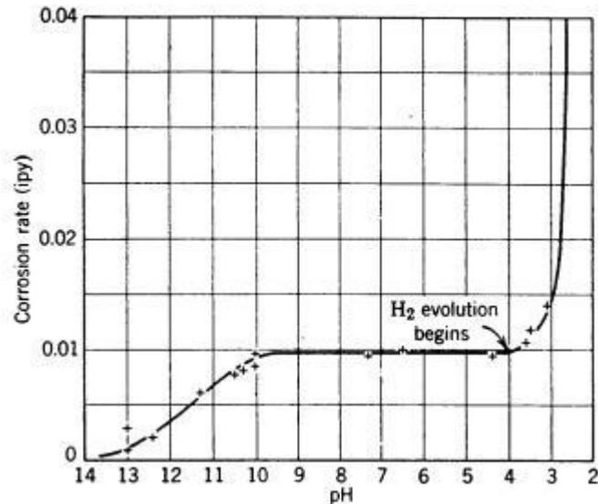
圖 2.6 鋼材腐蝕速率與 pH 值之關係
