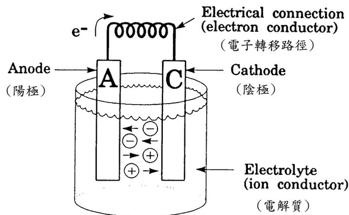
圖 2.3 水溶液系統之腐蝕程序示意圖
