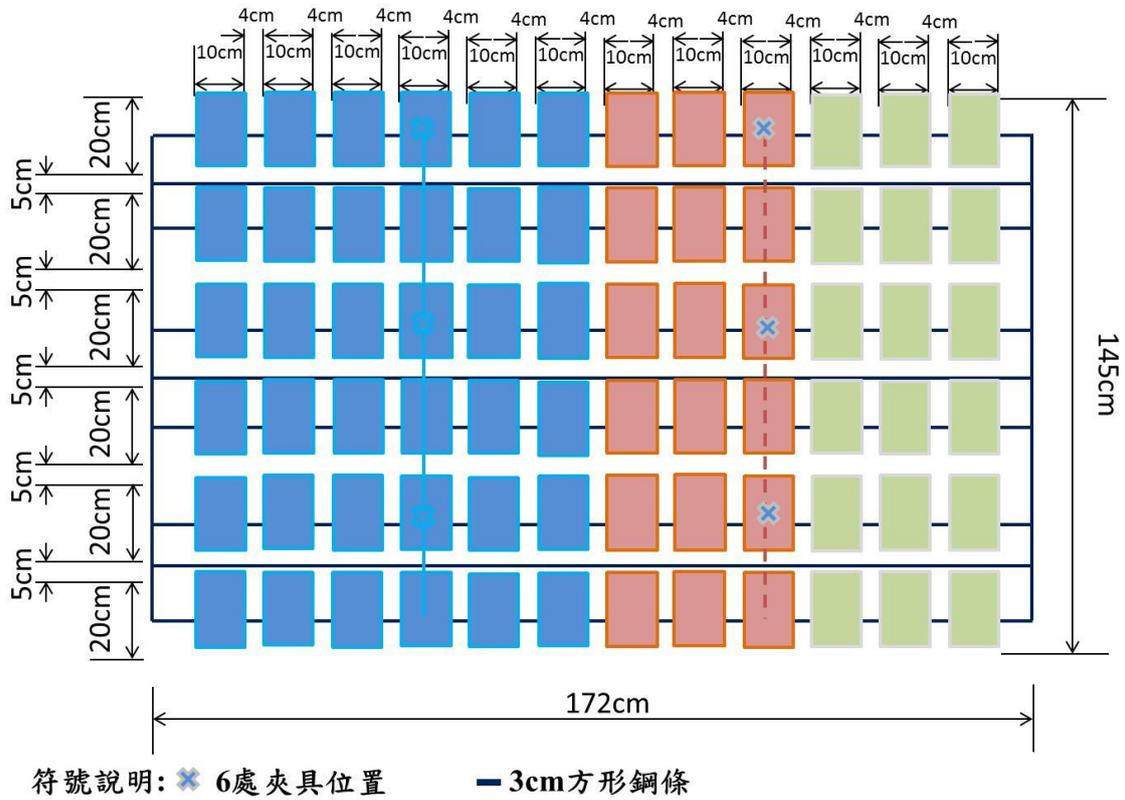
圖 5.2 臺中港水下金屬腐蝕試驗架示意圖
