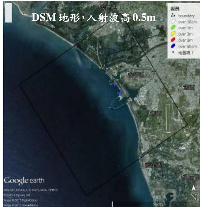
圖 5.42(a) 安平港結合 Google Earth 之溢淹圖(DSM)，入射波高 0.5 公尺
