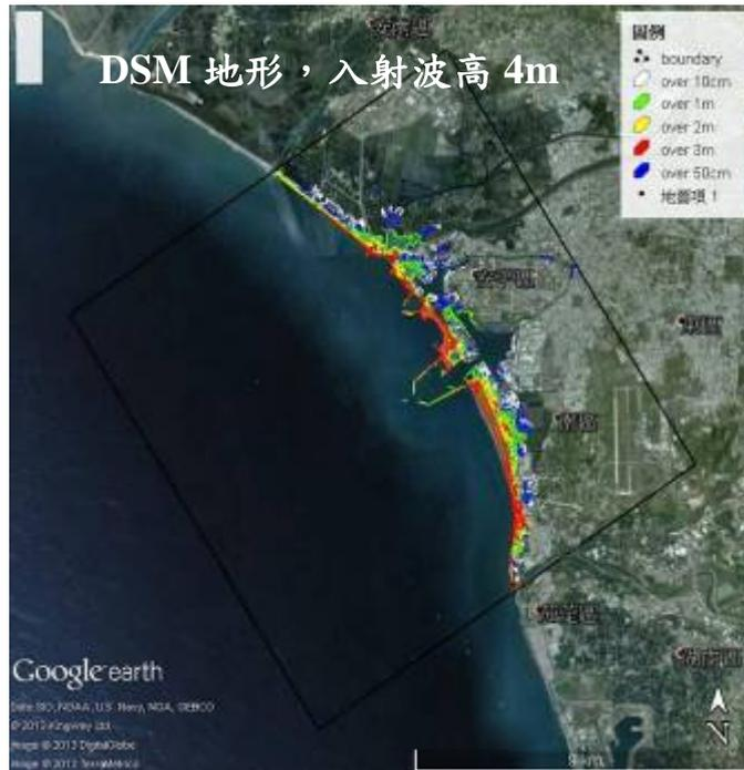
圖 5.42(e) 安平港結合 Google Earth 之溢淹圖(DSM)，入射波高 4 公尺
