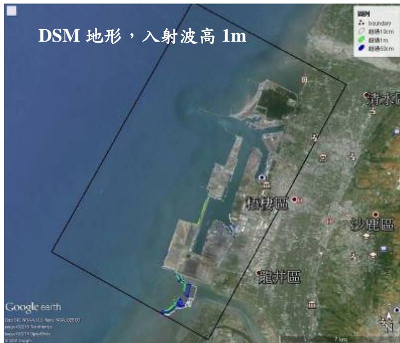
圖 5.40(b) 臺中港結合 Google Earth 之溢淹圖(DSM), 入射波高 1 公尺
