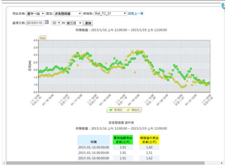
圖 2.56 展示臺中港波浪模擬 (大尺度、中尺度、小尺度) 歷線圖
