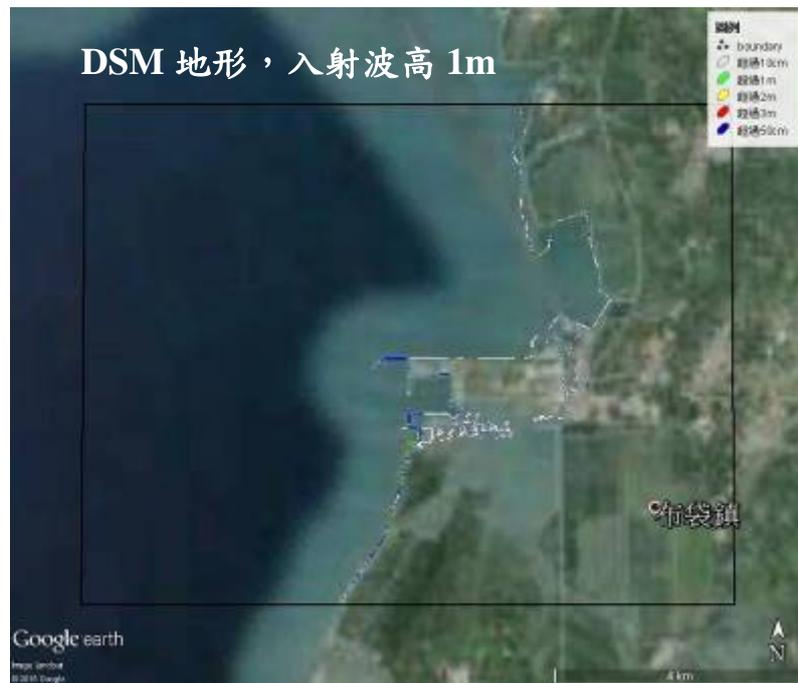
圖 5.41(b) 布袋港結合 Google Earth 之溢淹圖(DSM)，入射波高 1 公尺
