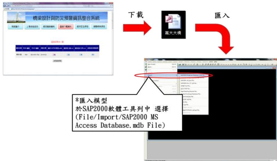
圖 5.37 下載橋梁結構模型
