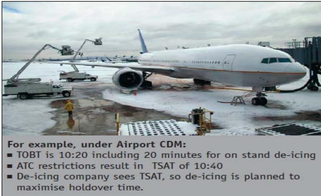
圖 2.3 機場飛機除冰資訊傳遞
