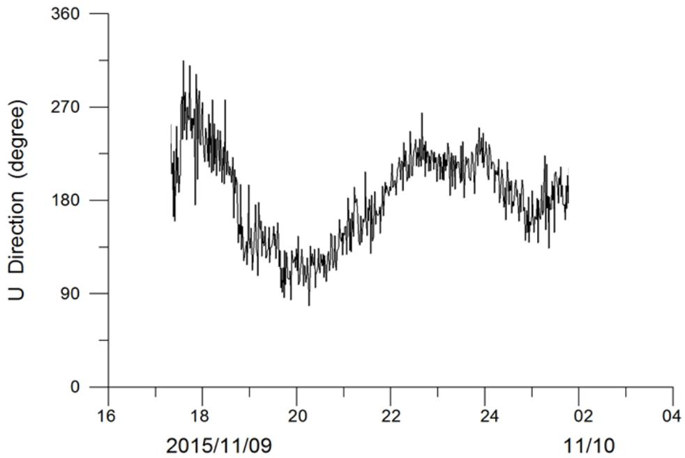
圖 3.38 測點 D 第 1 次潮離底高 14cm 處之流速與流向
