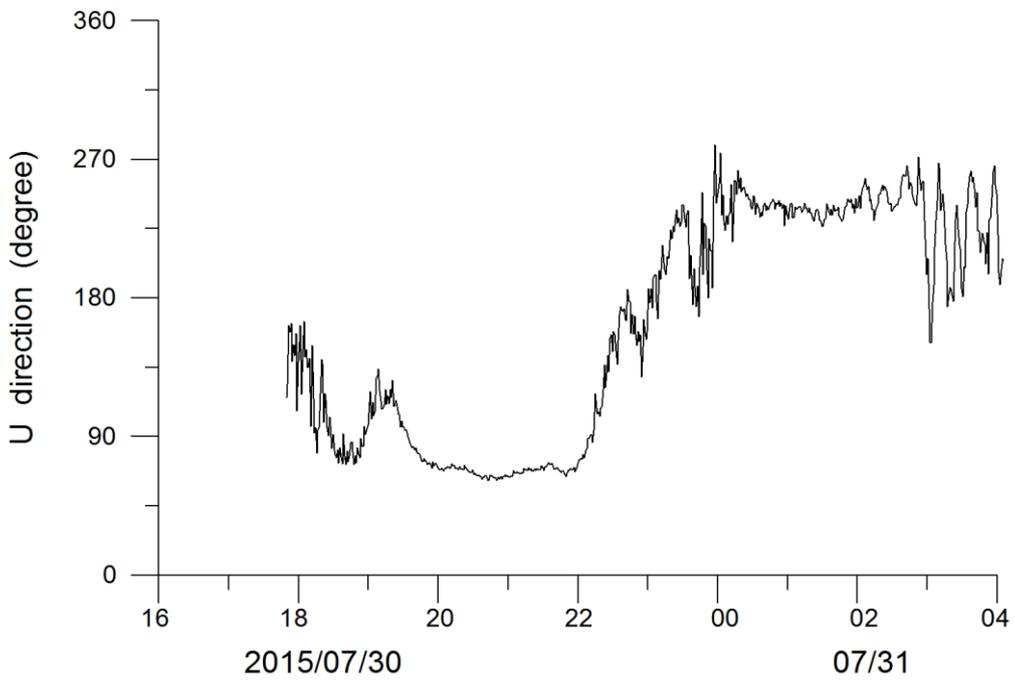
圖 3.12 測點 A 離底高 24.5cm 處之流速與流向
