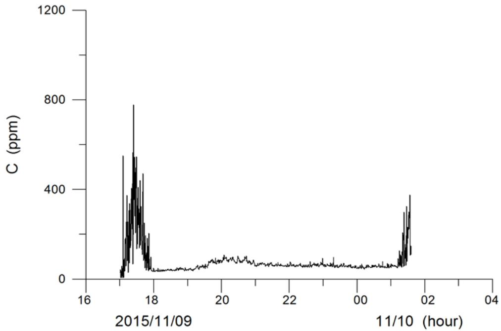
圖 3.42 測點 D 第 1 次潮離底高 28cm 處之懸浮質濃度變化
