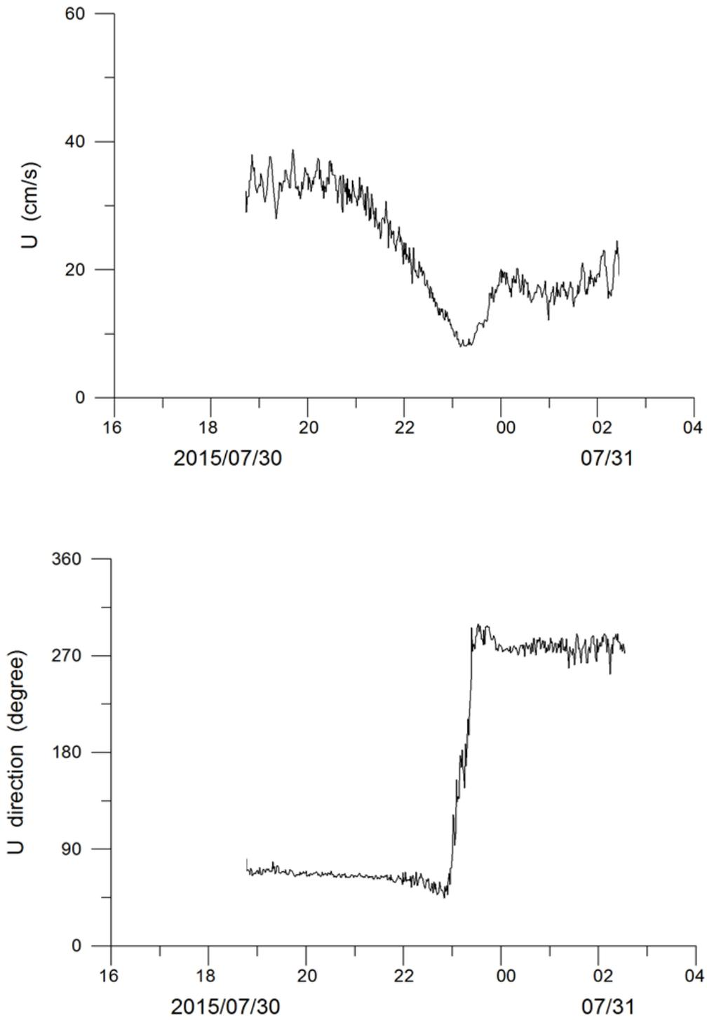
圖 3.11 測點 A 離底高 72.5cm 處之流速與流向
