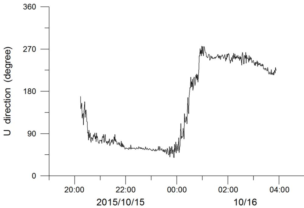
圖 3.26 測點 C 離底高 34.5cm 處之流速與流向
