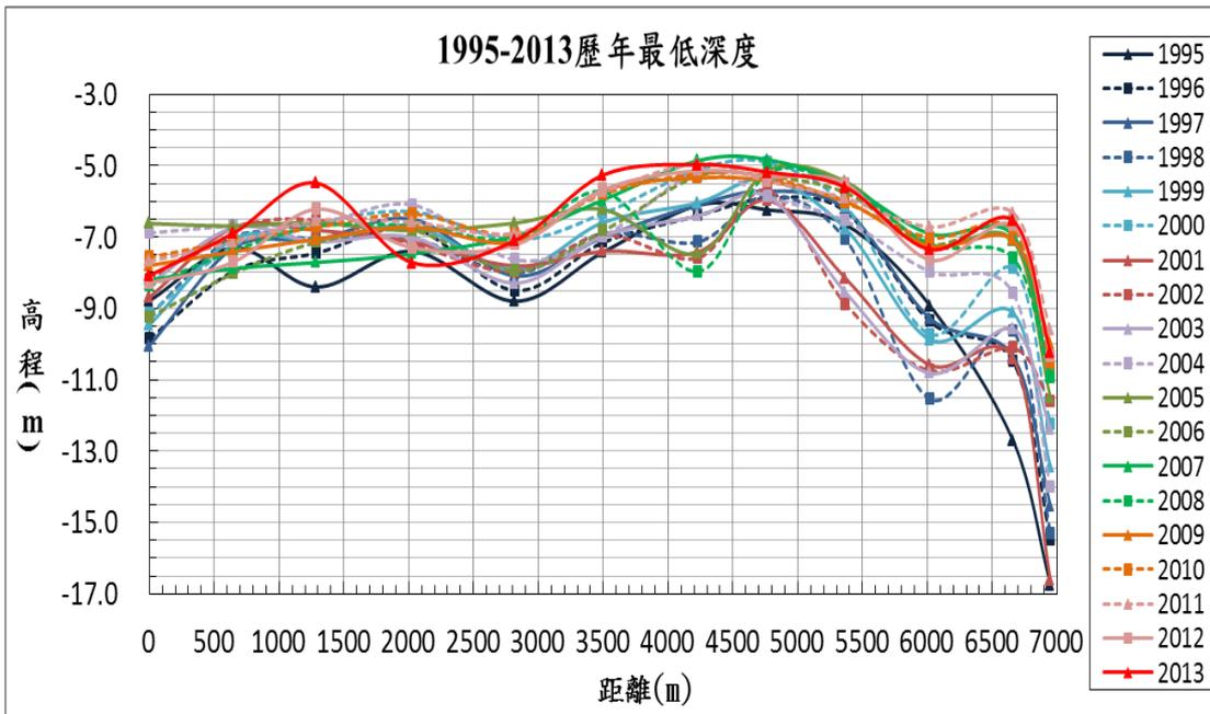
圖 4.2 斷面 T00-T10A 歷年最低點深度(與河口距離)
