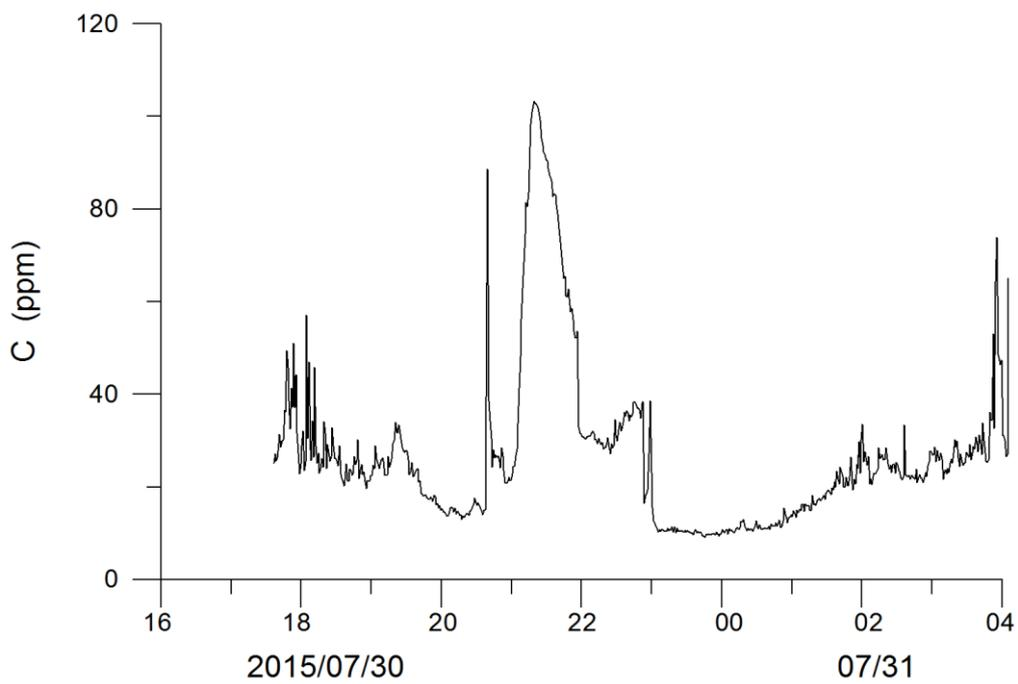
圖 3.18 測點 A 離底高 8cm 處之懸浮質濃度
