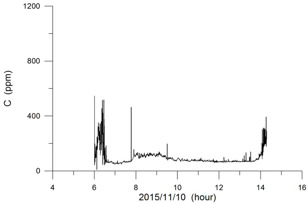
圖 3.44 測點 D 第 2 次潮離底高 28cm 處之懸浮質濃度變化
