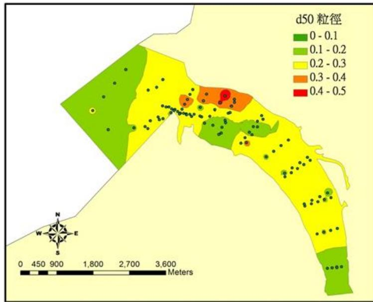
圖 5.13 淡水河河口段底床平均粒徑分布(2014/04)
