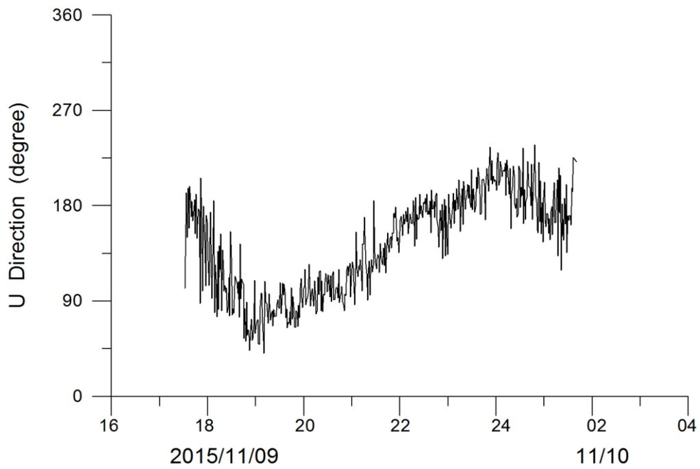
圖 3.36 測點 D 第 1 次潮離底高 34cm 處之流速與流向
