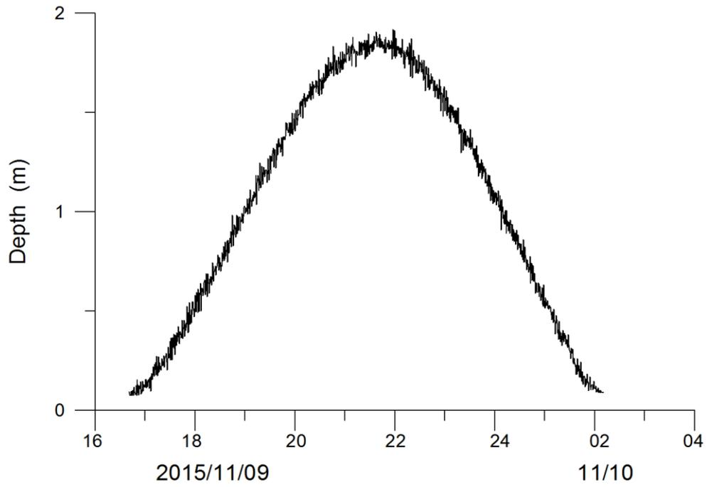
圖 3.32 測點 D 第一次漲退潮之水位變化
