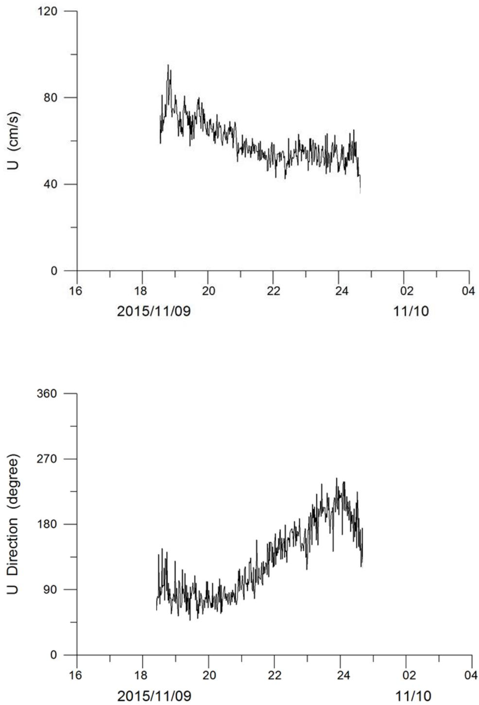
圖 3.34 測點 D 第 1 次潮離底高 66cm 處之流速與流向
