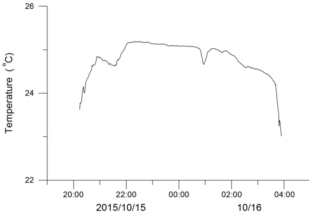
圖 3.28 測點 C 離底高 34.8cm 處之水溫變化
