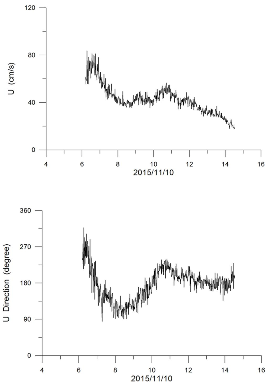
圖 3.39 測點 D 第 2 次潮離底高 14cm 處之流速與流向
