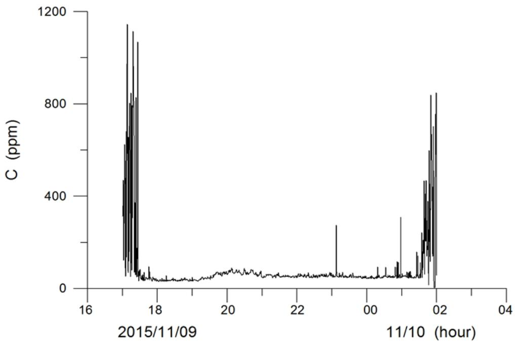
圖 3.43 測點 D 第 1 次潮離底高 19cm 處之懸浮質濃度變化
