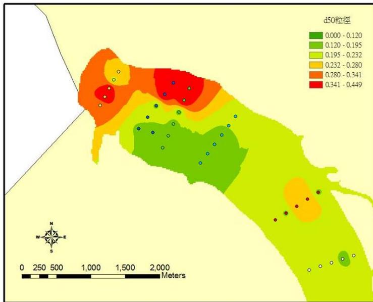
圖 5.11 淡水河河口段底床平均粒徑分布(2013/04)
