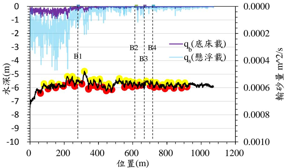
圖 5.8 2015 年 4 月 21 日 B 段水深及輸砂量變化
