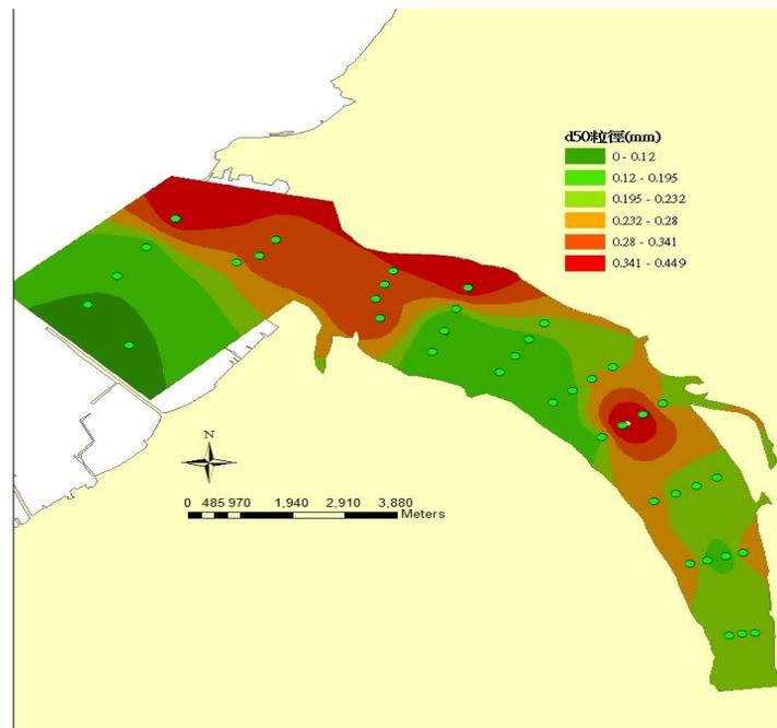
圖 5.14 淡水河河口段底床平均粒徑分布(2015/06)
