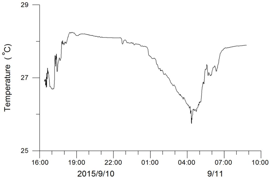
圖 3.22 測點 B 離底高 13cm 處之水溫變化
