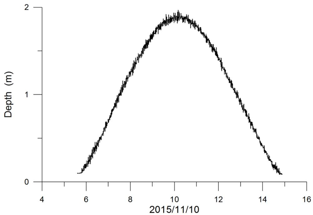
圖 3.33 測點 D 第二次漲退潮之水位變化
