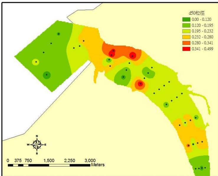
圖 5.12 淡水河河口段底床平均粒徑分布(2013/09)
