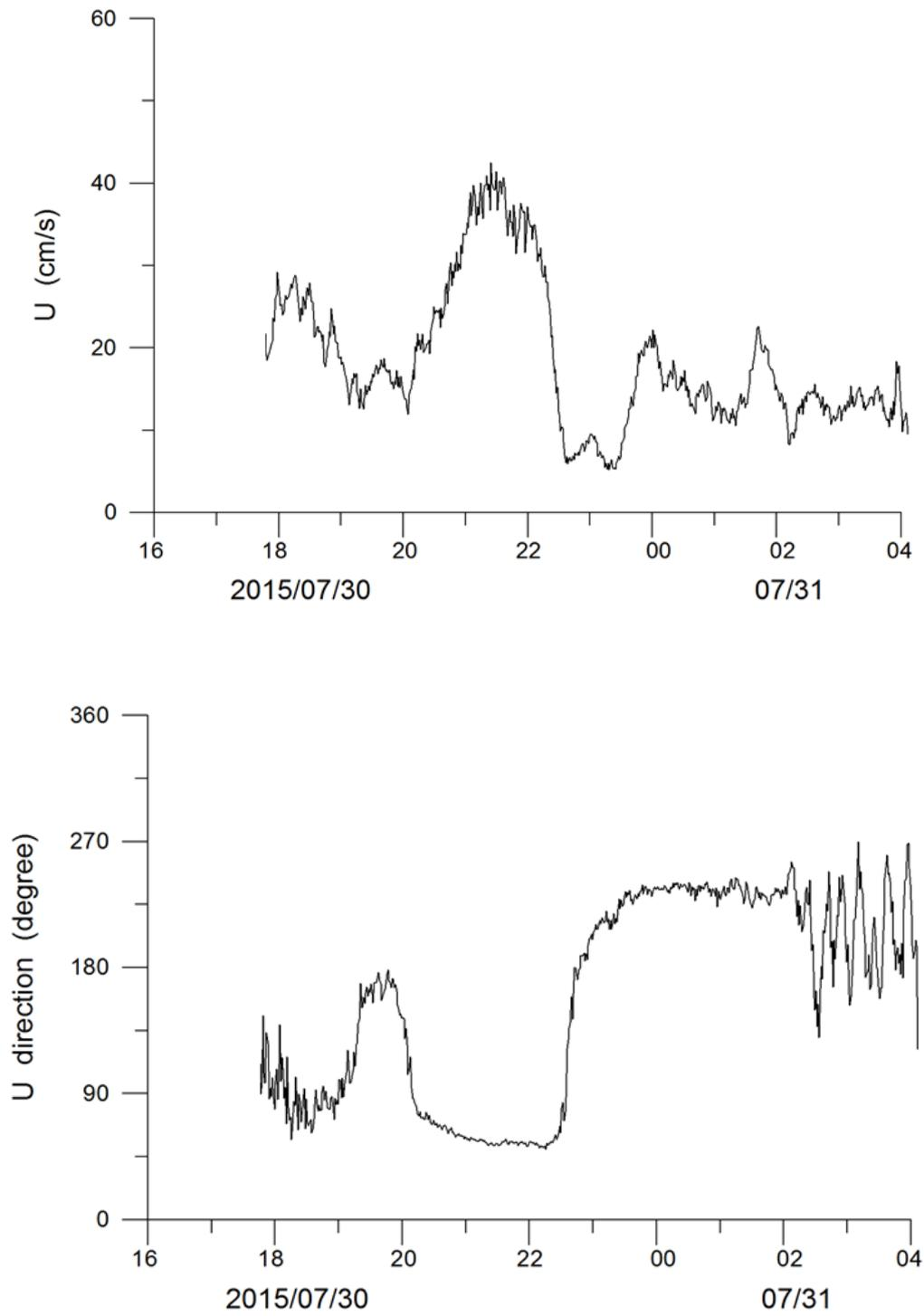
圖 3.13 測點 A 離底高 16.5cm 處之流速與流向
