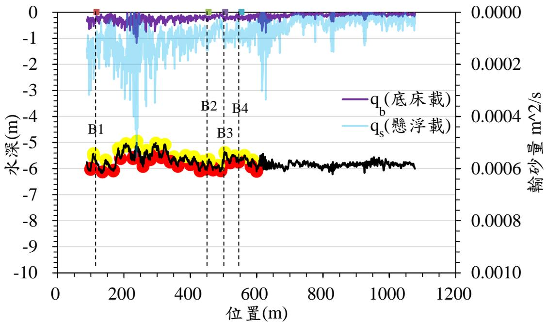
圖 5.6 2014 年 8 月 7 日 B 段水深及輸砂量變化
