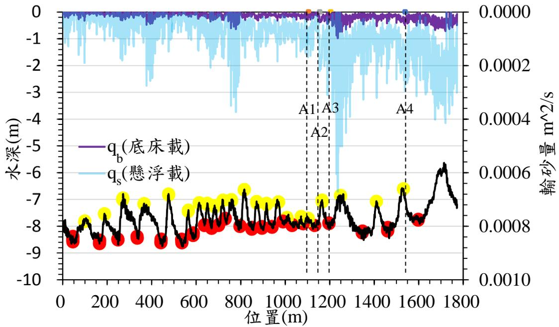
圖 5.3 2014 年 8 月 7 日 A 段水深及輸砂量變化
