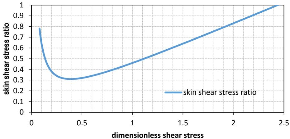
圖 5.10 具底床波形時表面阻抗佔底床剪應力值的比例
