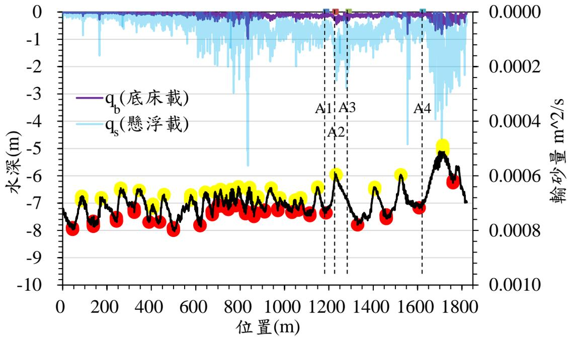
圖 5.4 2014 年 10 月 20 日 A 段水深及輸砂量變化
