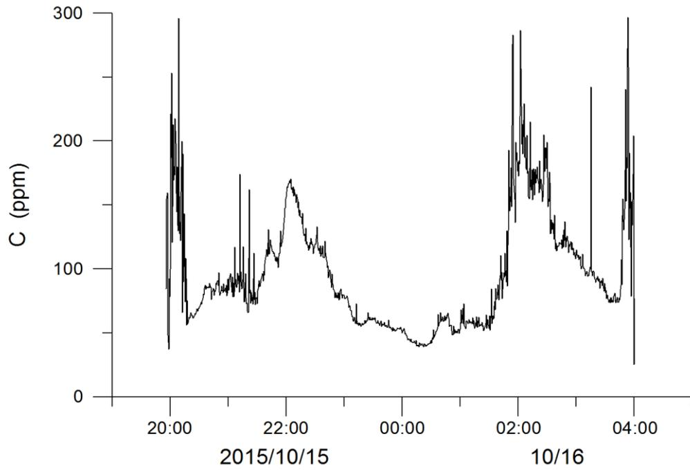
圖 3.30 測點 C 離底高 28.3cm 處之懸浮質濃度變化
