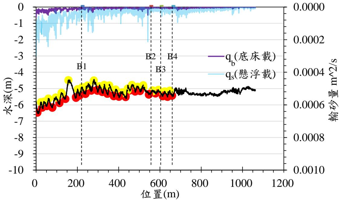
圖 5.7 2014 年 10 月 20 日 B 段水深及輸砂量變化
