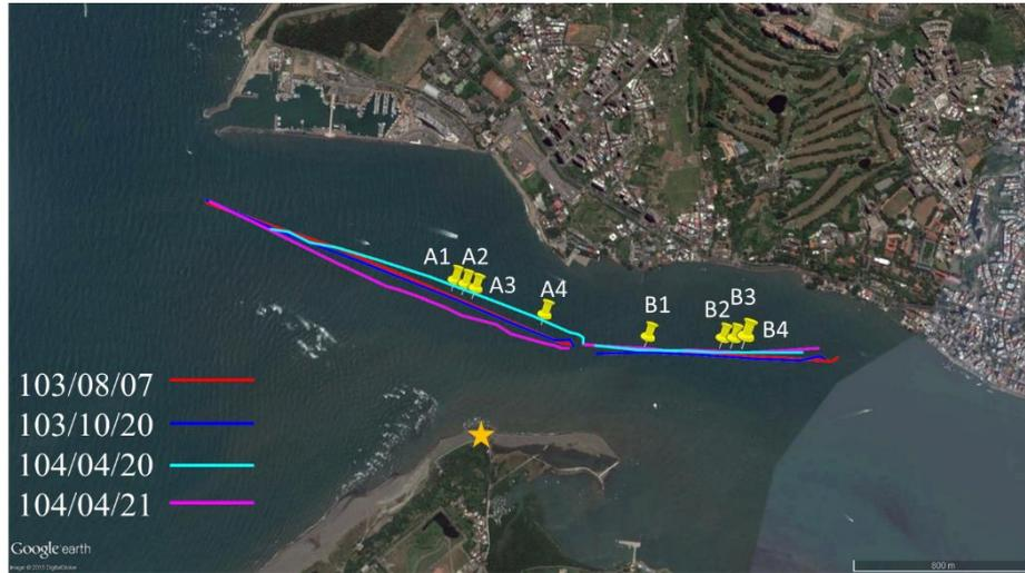
圖 5.1 2014 River-Ray ADCP 在淡水河口進行量測之航跡
