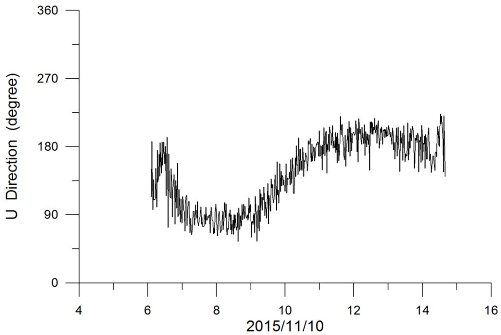
圖 3.37 測點 D 第 2 次潮離底高 34cm 處之流速與流向
