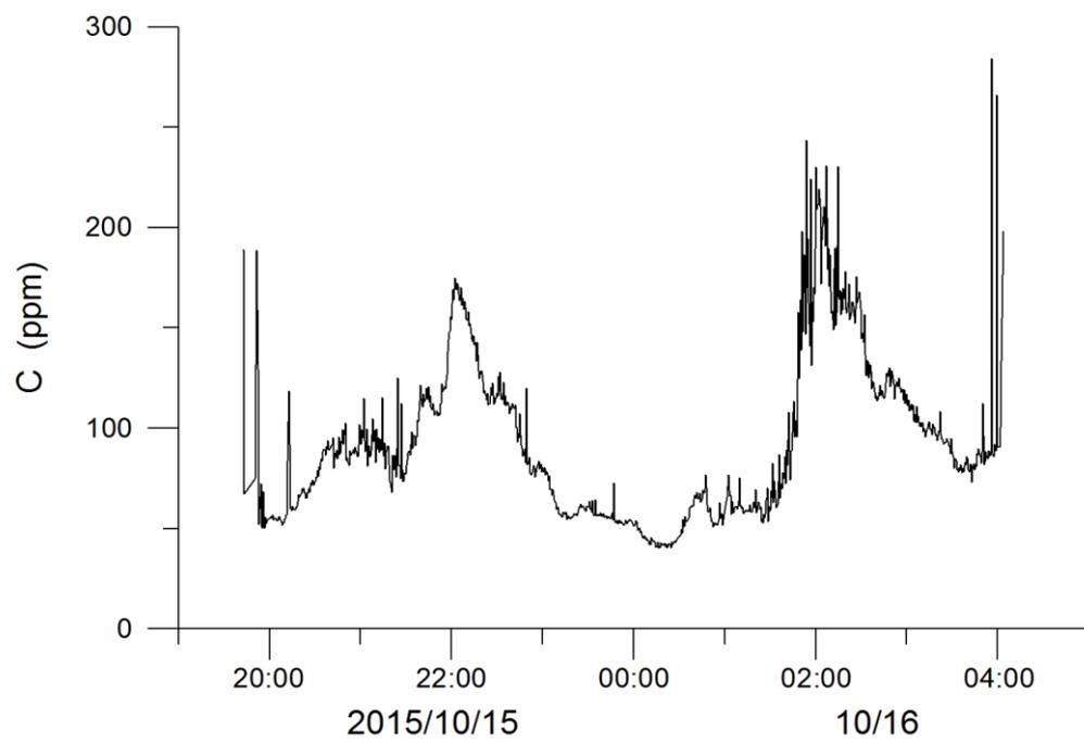
圖 3.31 測點 C 離底高 18.8cm 處之懸浮質濃度變化
