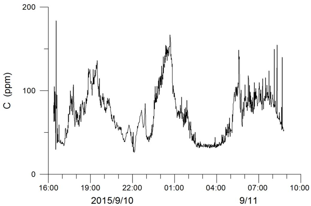
圖 3.23 測點 B 離底高 13cm 處之懸浮質濃度變化
