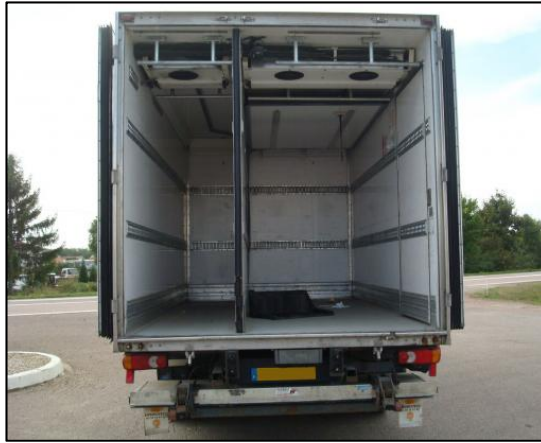
圖 1 低溫配送貨車內部隔艙圖
