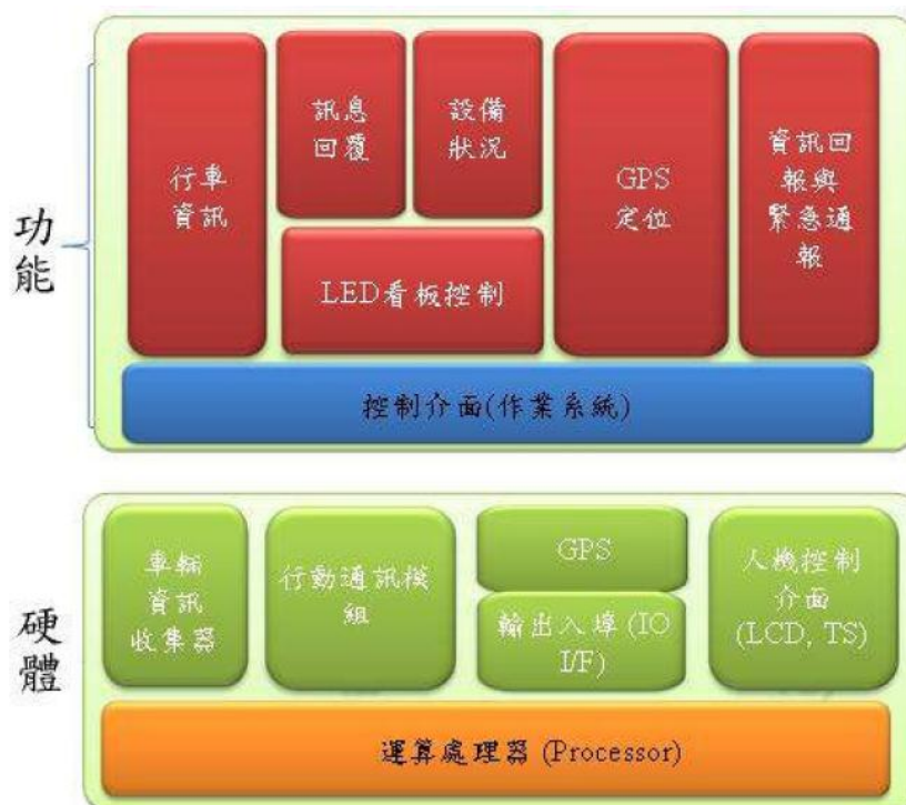
圖 3-10 營業大客車車載機系統架構圖
