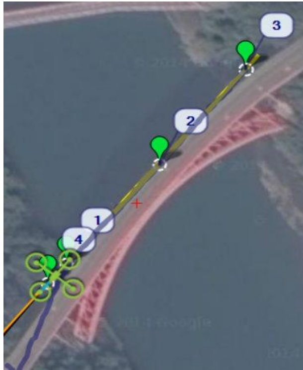
圖 5.13 直線路線拍攝羅浮橋側
