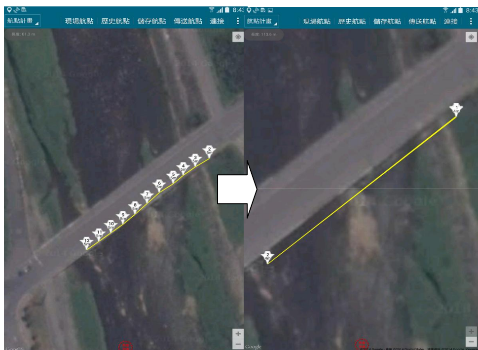
圖 5.8 現地量測橋梁位置並繪製飛行路徑
