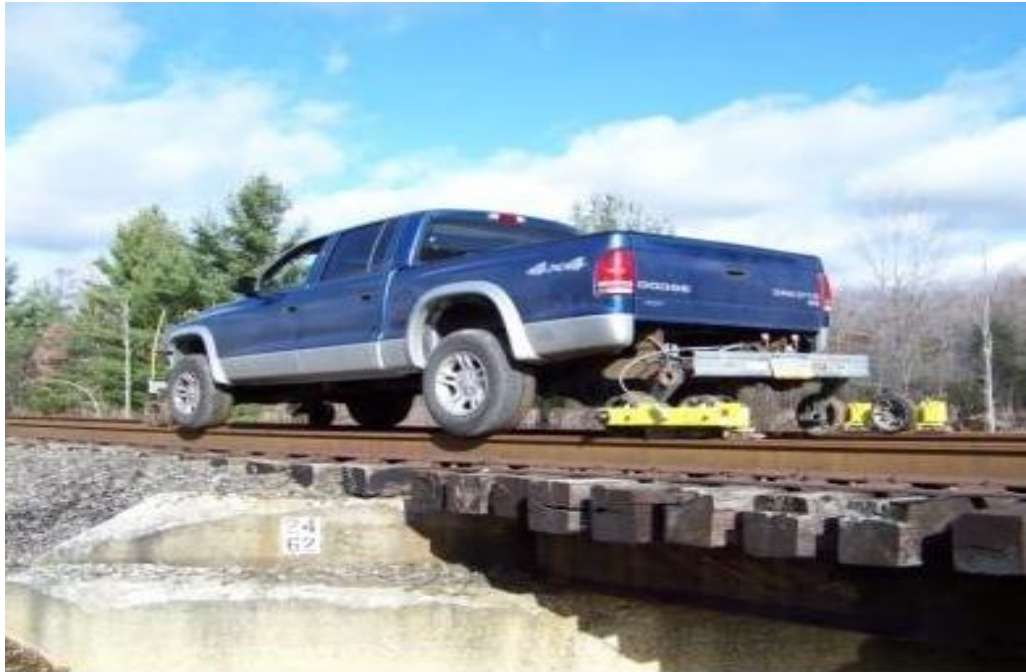
圖 2.19 超音波鐵路橋檢測車
