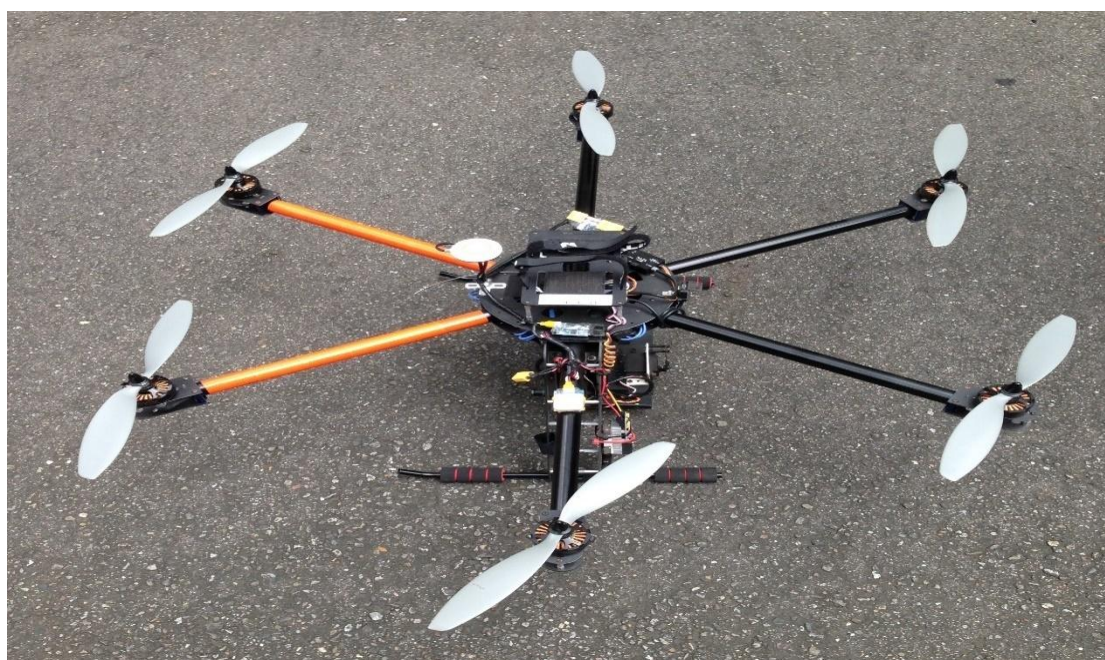
圖 3.2 B 橋梁管理機關使用之六軸 UAV
