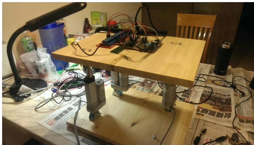
圖 3.10 本團隊初步開發的自動定平機構
