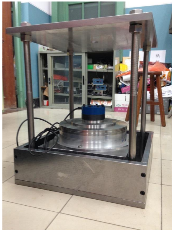
圖 3.13 水力力學耦合試驗系統剪力盒實體
