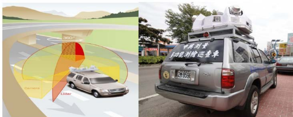
附圖 7.7 掃描觀測示意圖
