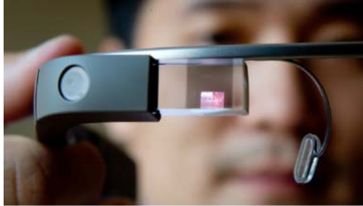
附圖 8.5 眼見穿戴裝置之近眼微投影顯示器示意圖
