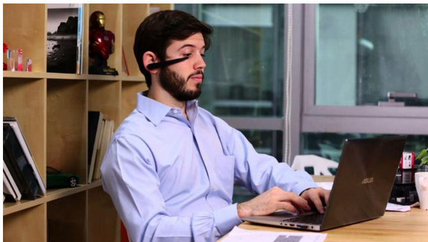
附圖 8.11 以眨眼偵測為基礎的瞌睡預防穿戴裝置圖
