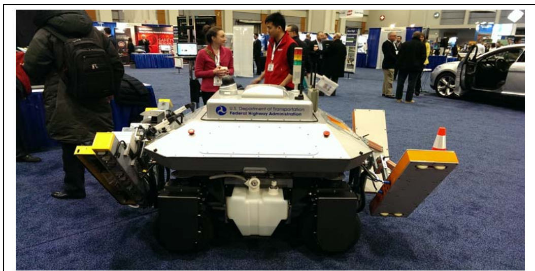
圖 2.20 美國 FHWA 橋樑檢測機器人系統
