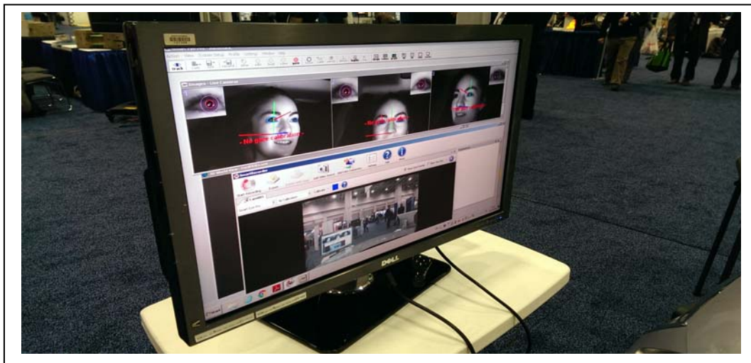
圖 2.15 美國 FHWA 車輛駕駛臉部瞳孔監測系統
