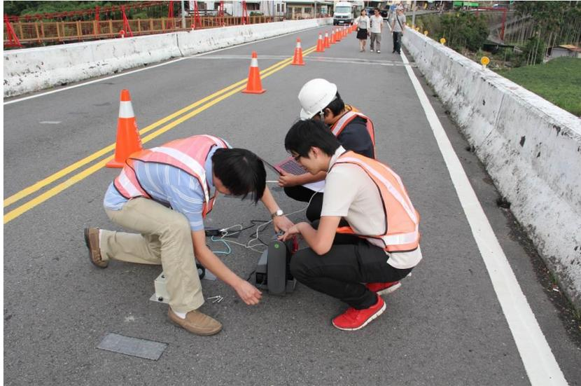
圖 3.7 以備用電源供應筆電與速度計之電力
