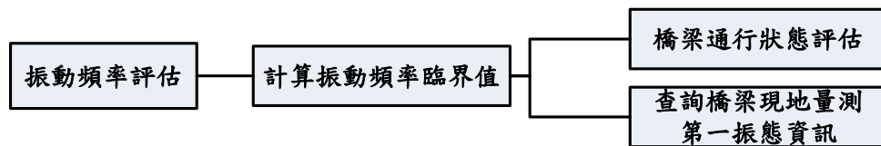
圖 6.16 振動頻率評估模組功能架構
