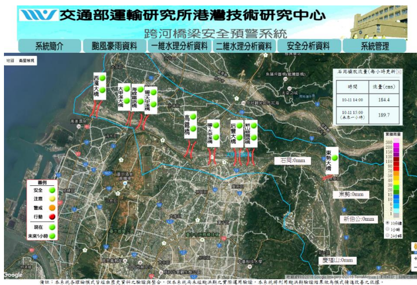
圖 3.12 跨河橋梁安全預警系統畫面
