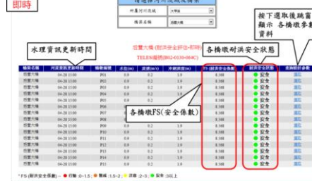
4. 橋梁耐洪安全評估計算(即時)
