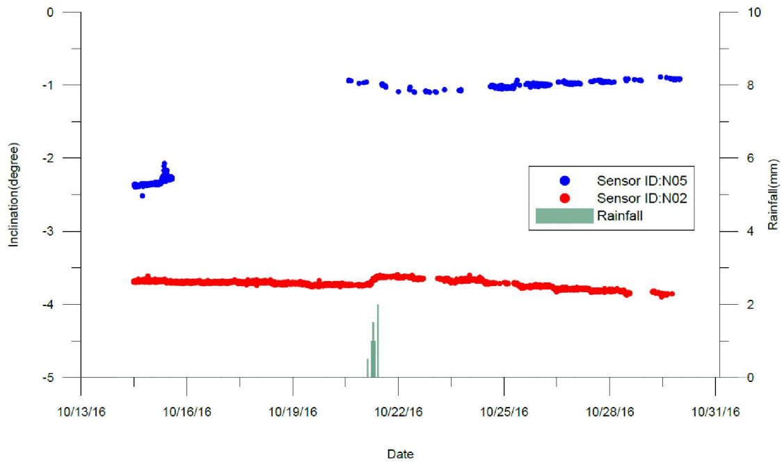
圖 5.18 監測點 ID02 單向傾角連續觀測紀錄與雨量分布
