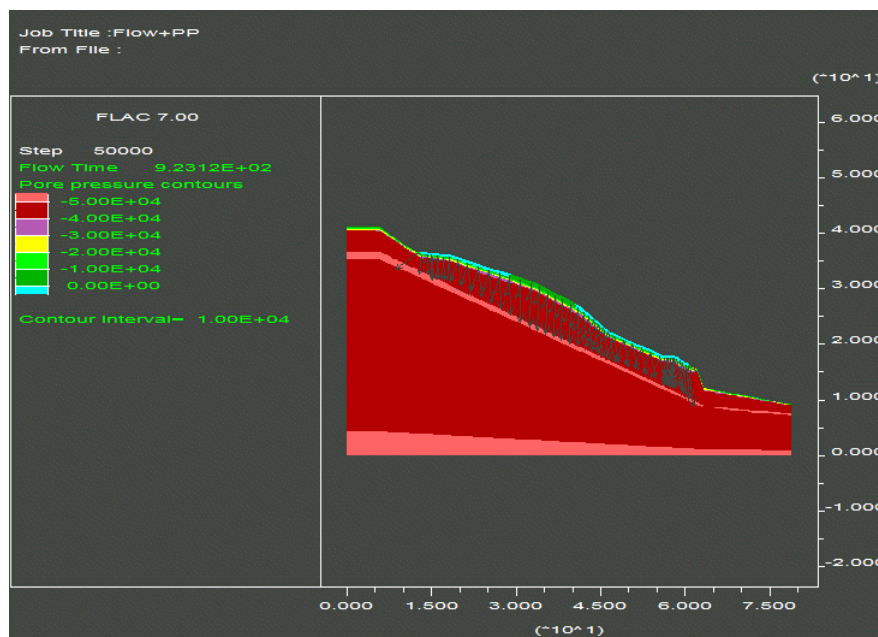
圖 5.20 入滲開始 900 秒後孔隙水壓分布與流動向量
