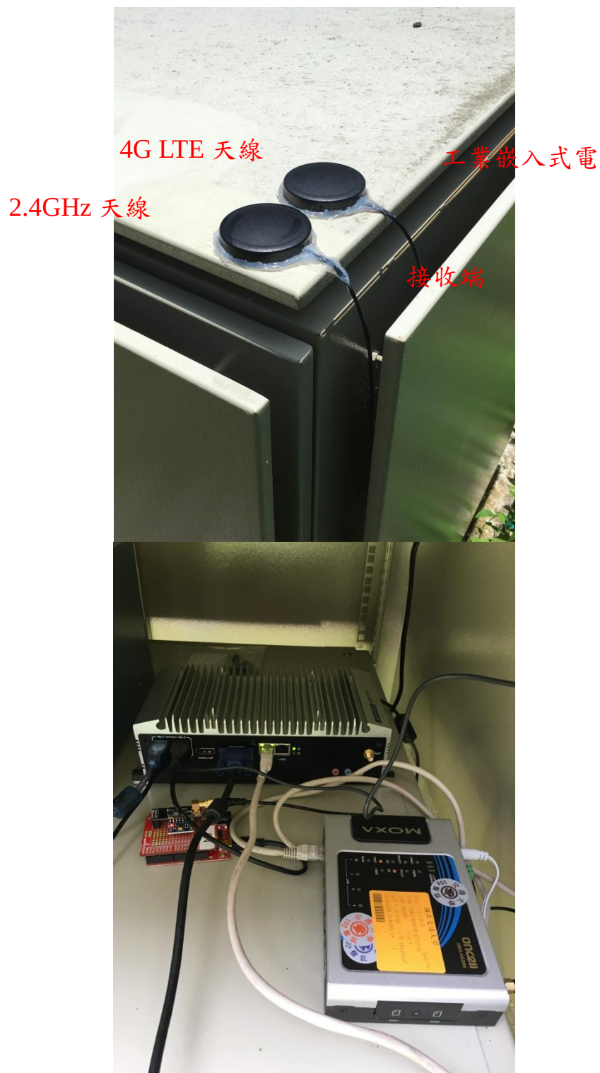
圖 4.23 接收端與自動化監測記錄系統
