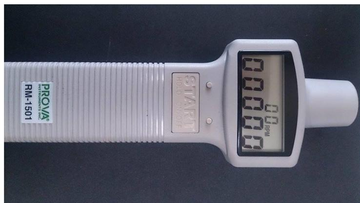
圖 7.39 PROVA RM-1501 轉速計
