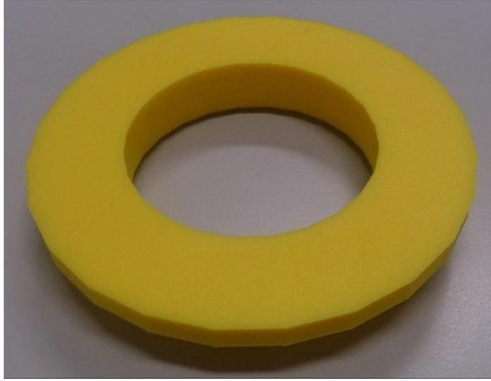
圖 5.25 導流盤 3D 列印成品
