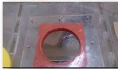
以黏土補平被開挖頂板造成之空隙之部分，以防止漏風與維持原系統的完整性
