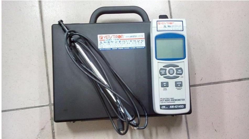
圖 6.9 氣流速度計(產品編號：AM.4214SD)
