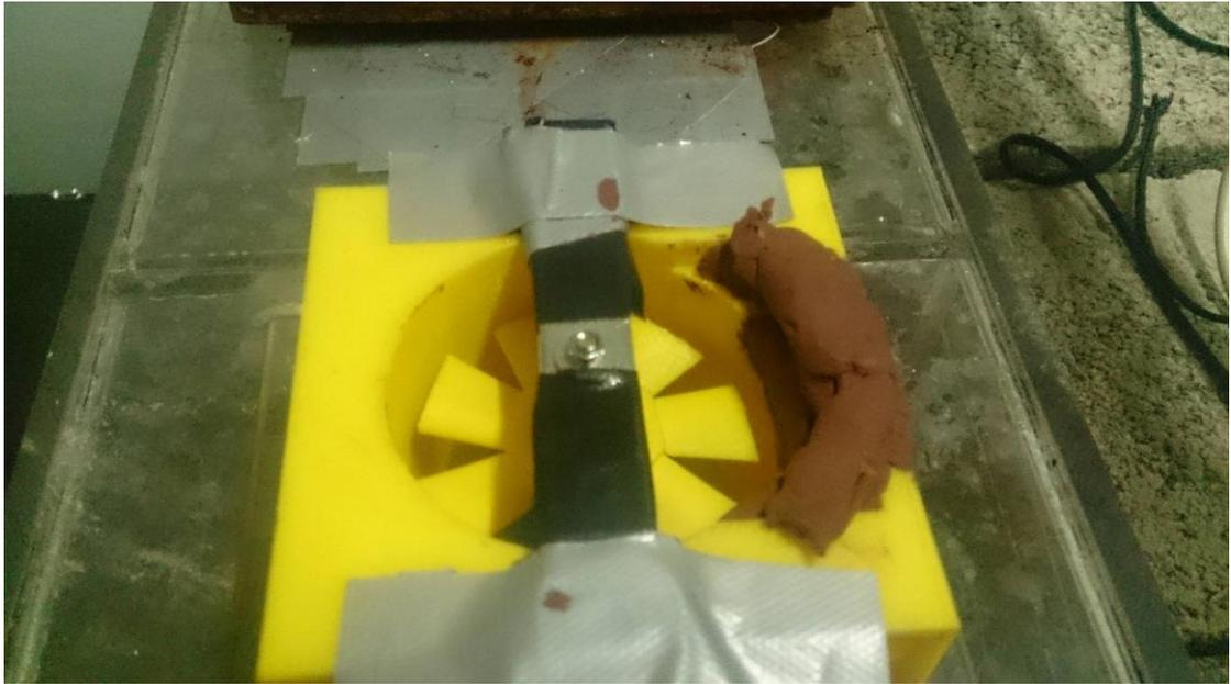
圖 7.40 威爾斯渦輪於模型進行無負載轉速試驗（無上導管）
