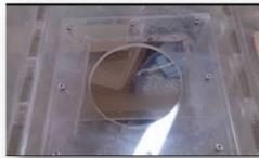
擴大原波能轉換系統之出風口，將原波能轉換系統的頂板切割出邊長為10公分的正方形洞口，並在上方加裝一畫有直徑為9公分之出風口邊長為12公分之正方形的可拆卸式的壓克力板頂板
