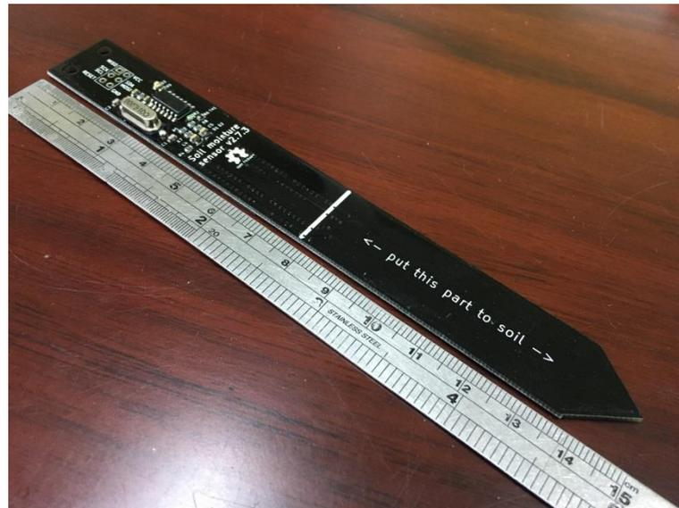
圖 3.8 Catnip Electronics 電容式土壤水份計
