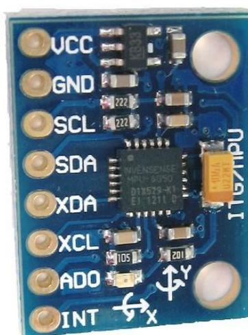
圖 3.10 MPU-6050 模組(Arduino)
