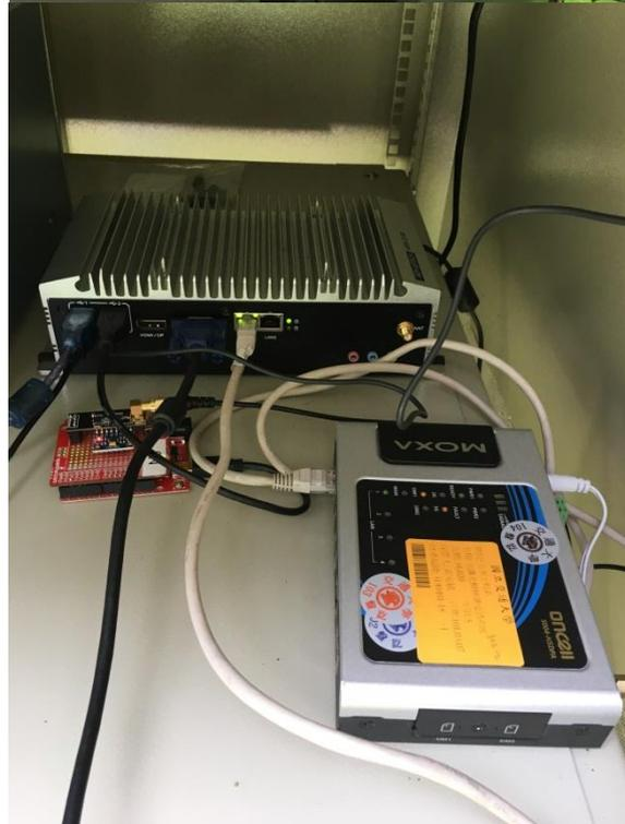
圖 3.23 接收端與自動化監測記錄系統
