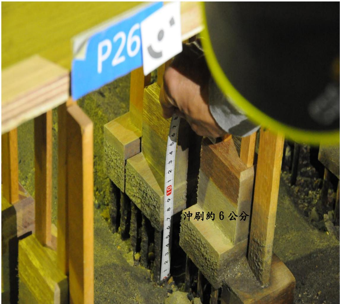
圖 10.1 橋基沖刷深度量測示意圖
