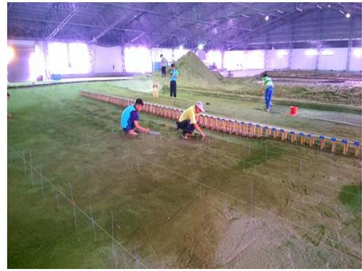
照片8.6 模型試驗斷鋪設
