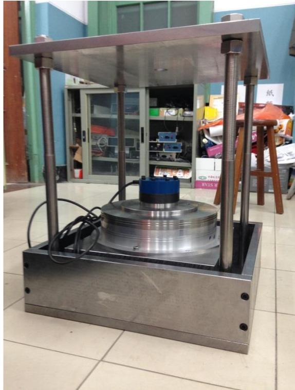
圖 2.13 水力力學耦合試驗系統剪力盒實體
