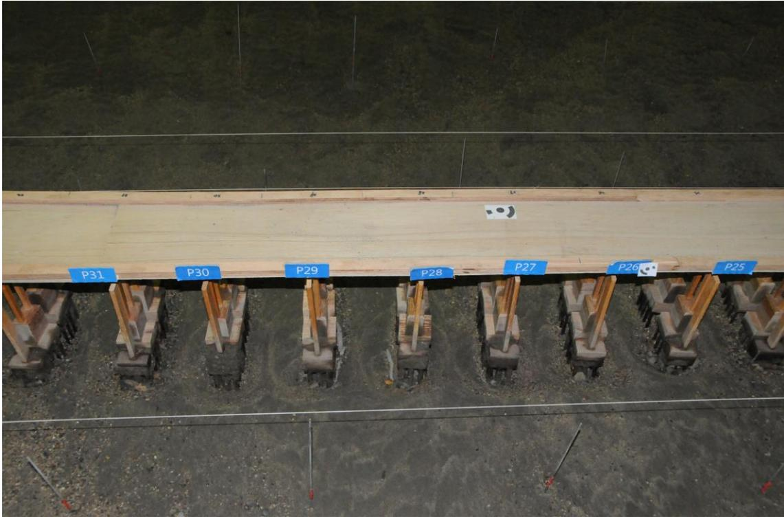
圖 10.17 方案 2(50 年重現期距)保護工露出狀況
