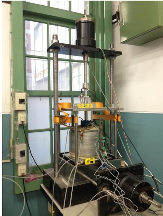
圖 2.12 水力力學耦合試驗系統實體圖
