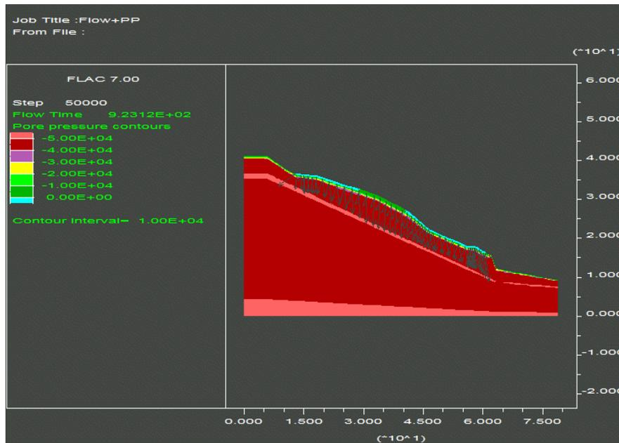
圖 4.20 入滲開始 900 秒後孔隙水壓分布與流動向量
