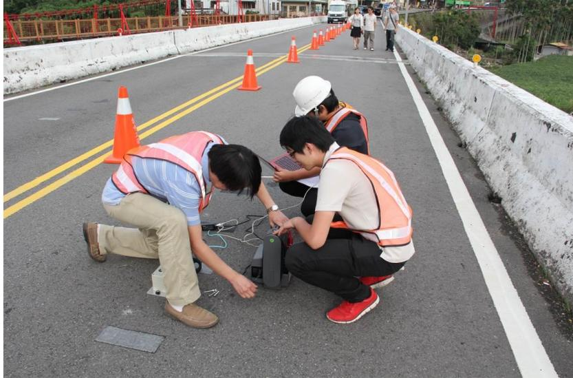
圖 5.7 以備用電源供應筆電與速度計之電力
