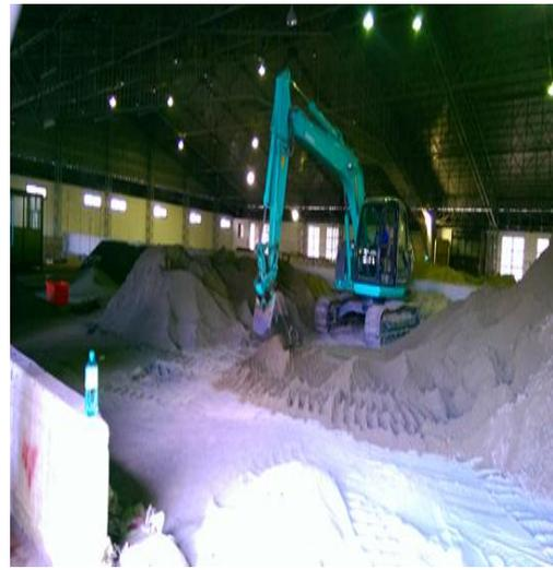
照片8.2 試驗砂拌合
