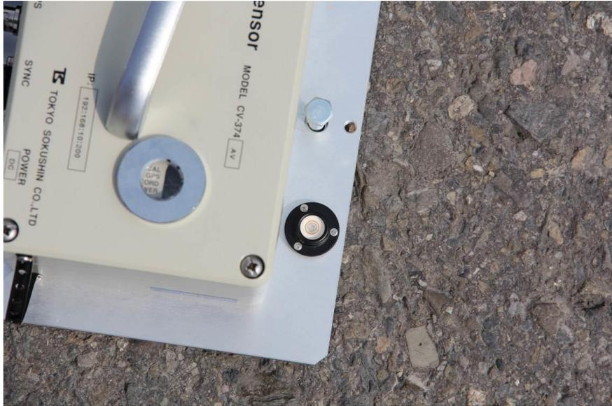
圖 5.8 速度計上 LED 燈之檢核
