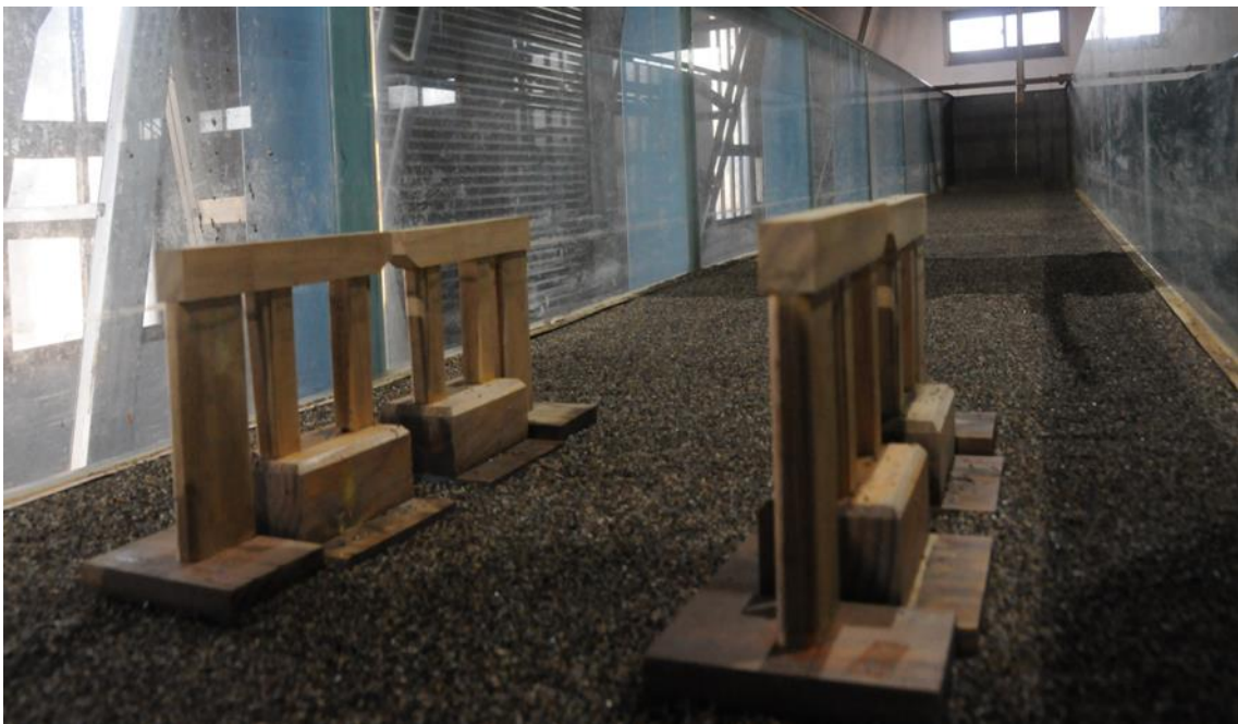
圖 6.3 橋墩鋪設情形
