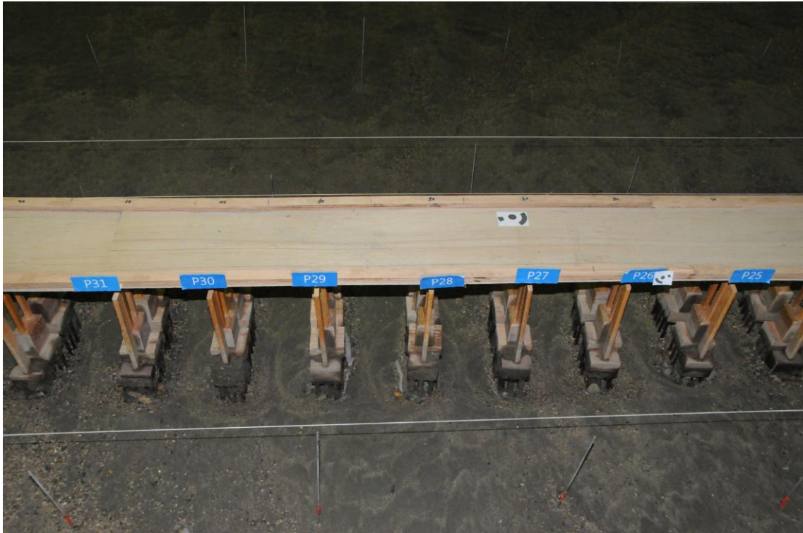
圖 9.17 方案 2(50 年重現期距)保護工露出狀況
