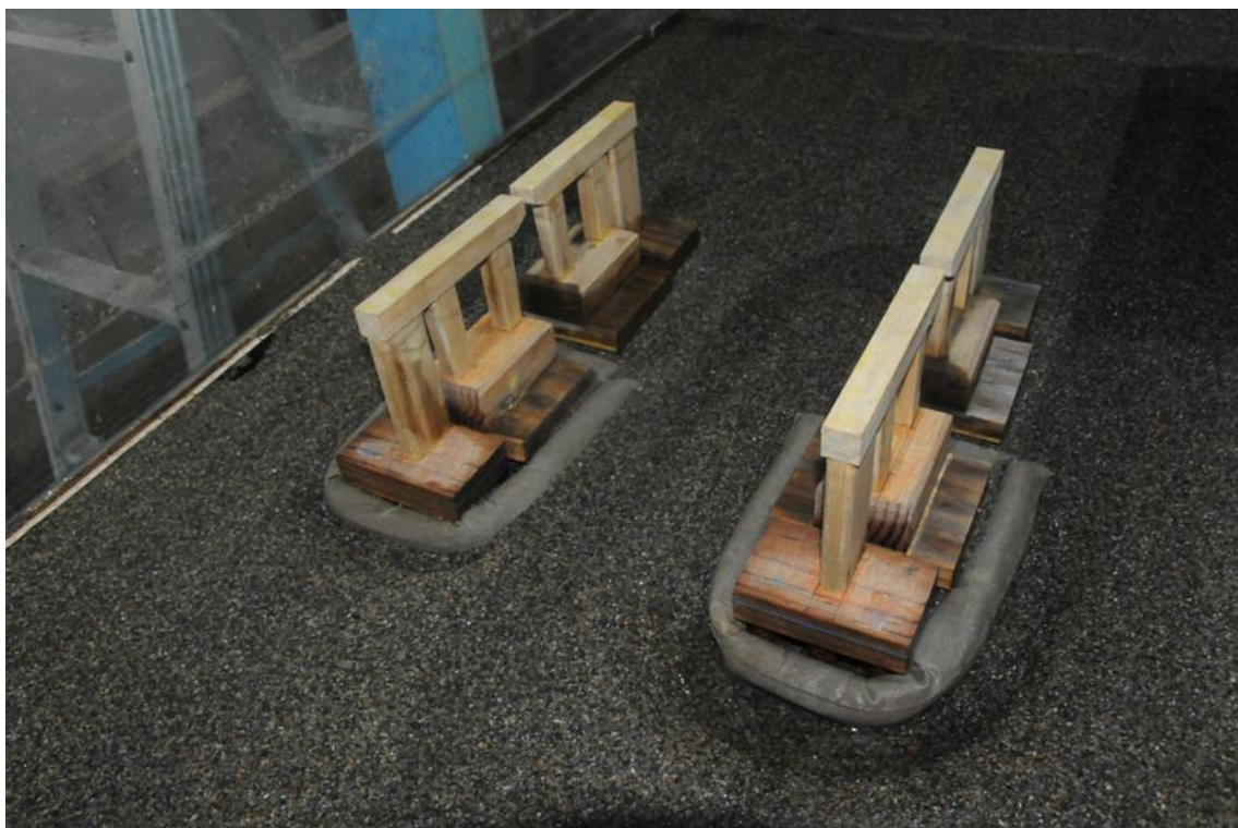
圖 6.23 一層砂腸袋(底床下 1.5 公分)基礎沖刷情形
