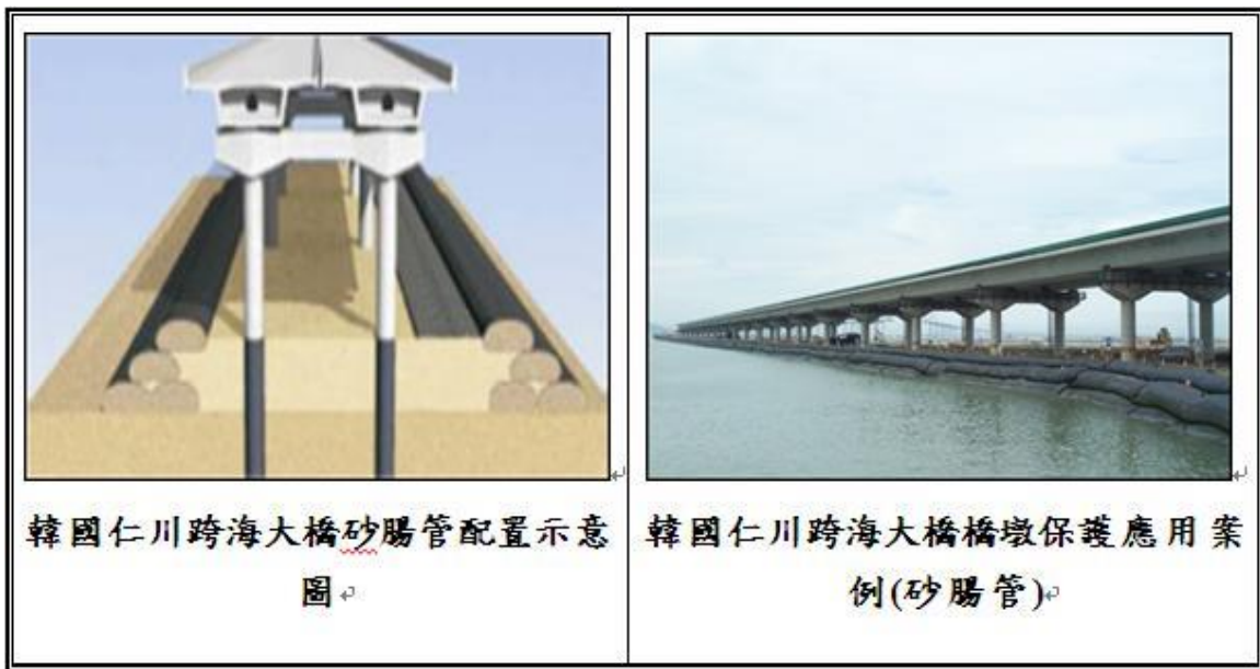
圖 4.12 韓國仁川跨海大橋砂腸管配置示意圖及應用案例
