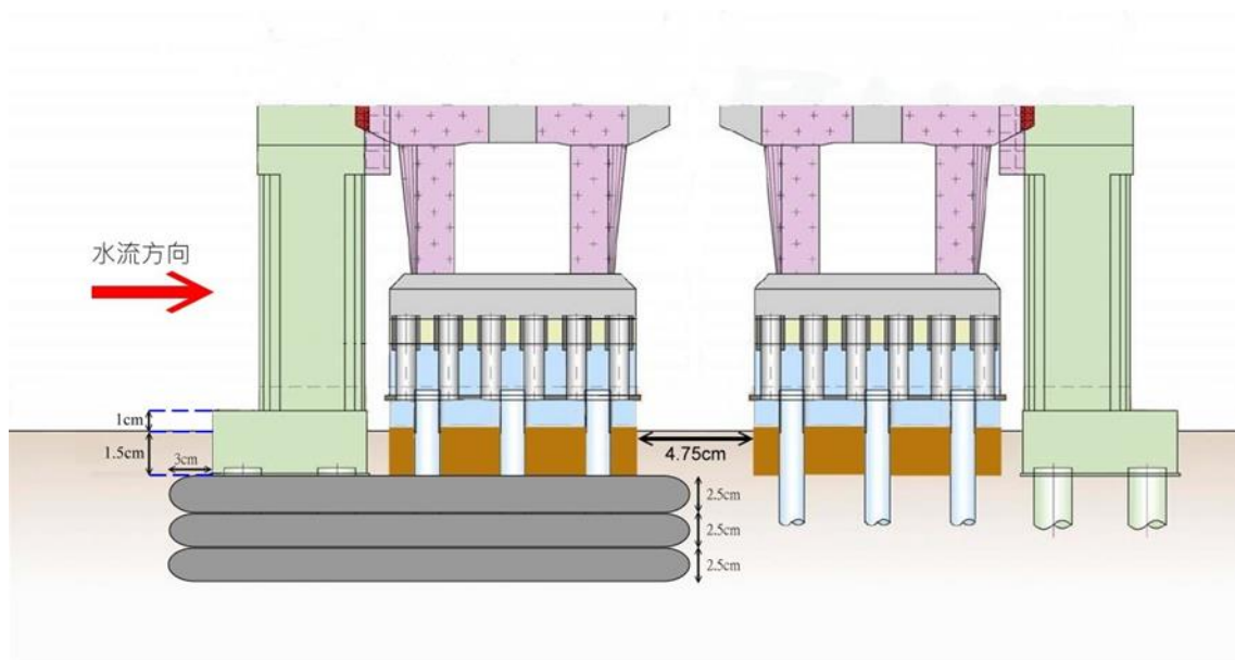
圖 6.46 三層直立砂腸袋鋪設斷面示意圖
