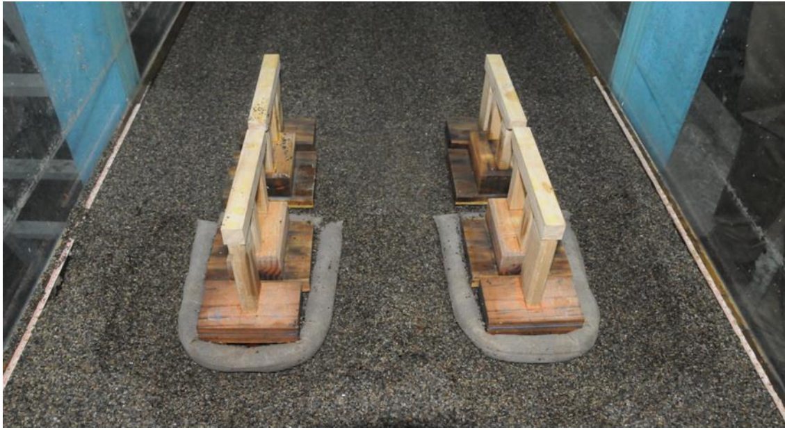
圖 6.12 一層砂腸袋(底床下 0.5 公分)鋪設
