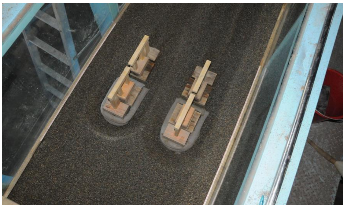
圖 6.47 三層直立砂腸袋基礎沖刷情形
