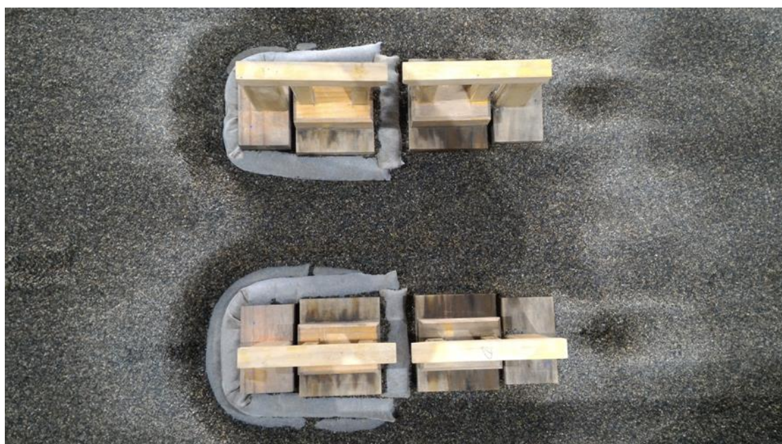
圖 6.55 三層斜坡砂腸袋基礎沖刷情形
