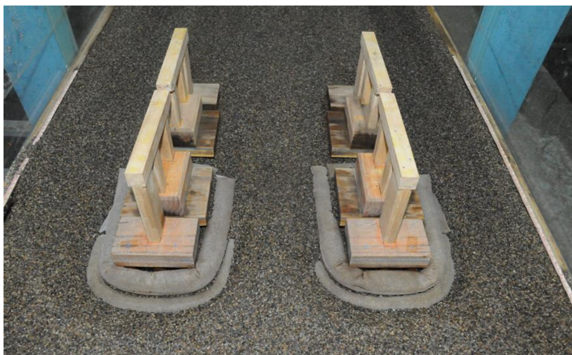
圖 6.39 二層斜坡砂腸袋基礎沖刷情形
