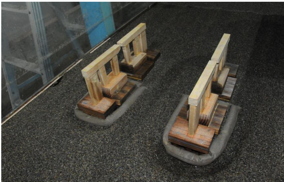
圖 6.15 一層砂腸袋(底床下 0.5 公分)基礎沖刷情形
