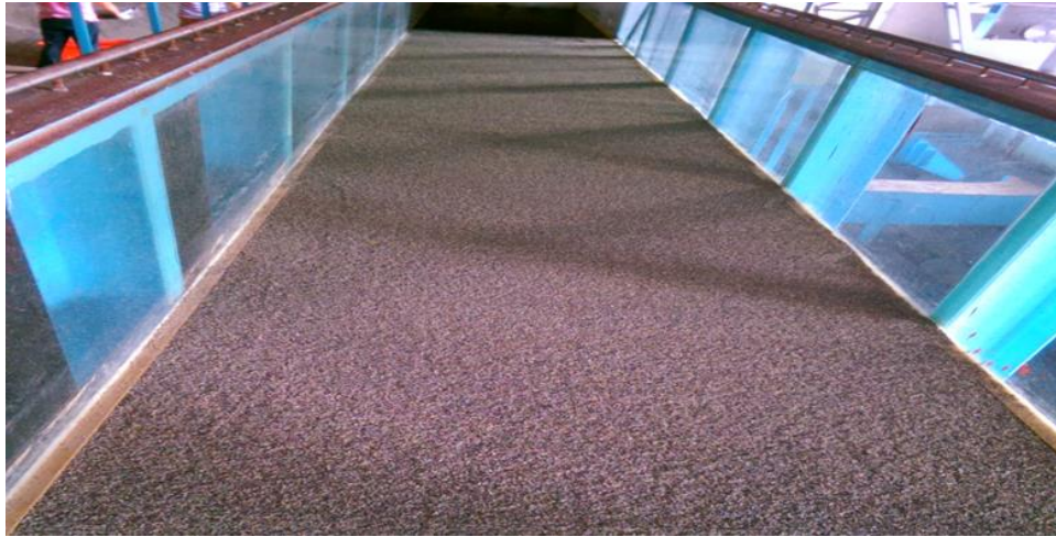
圖 6.4 底床鋪設情形
