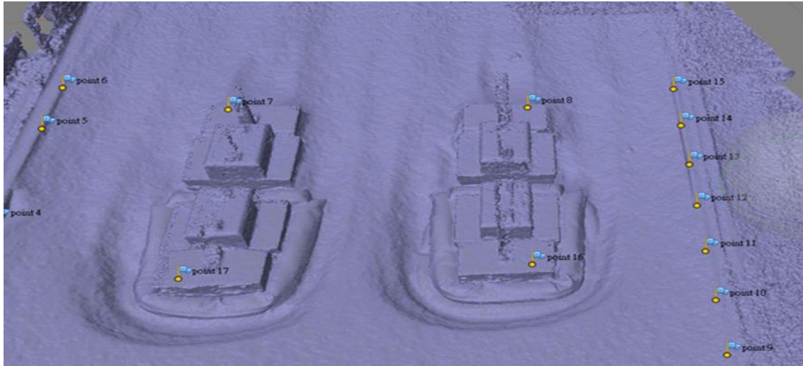
圖 6.56 三層斜坡砂腸袋沖刷深度與範圍 3D 圖
