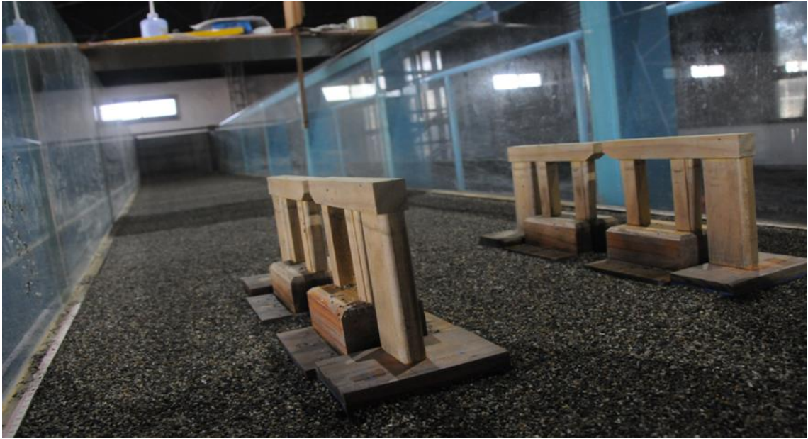
圖 6.6 無保護工鋪設
