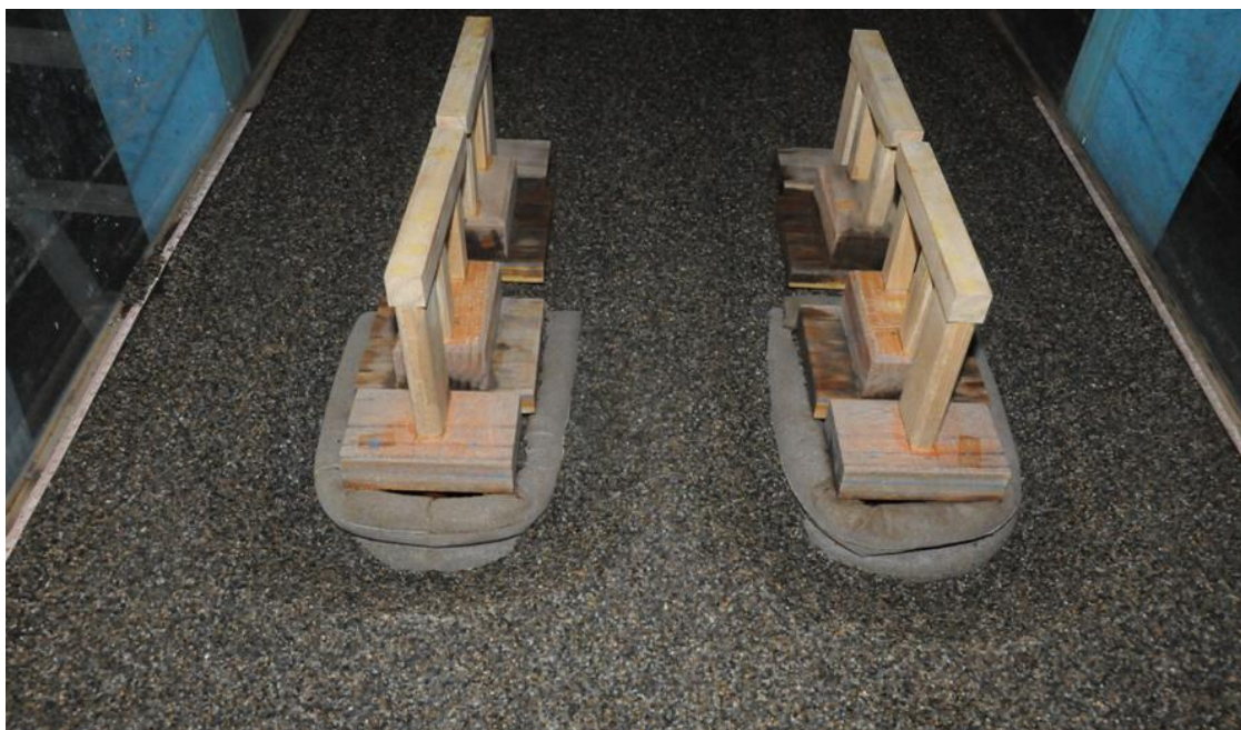
圖 6.31 二層直立砂腸袋基礎沖刷情形
