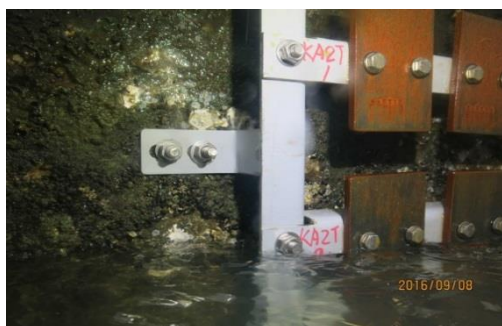
潮汐帶試驗架安裝完成
