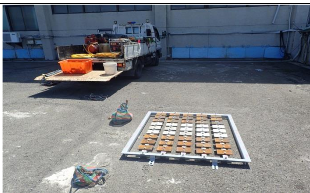
金屬腐蝕試驗架排列檢視
