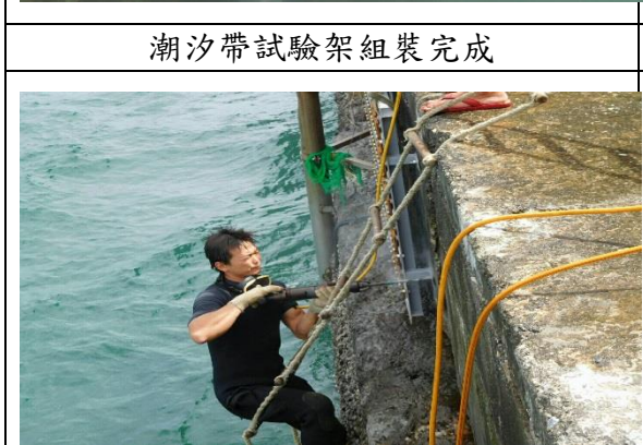
飛沫帶試驗架垂降至定位及安裝
