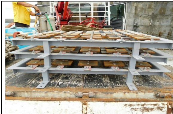
花蓮港金屬腐蝕試驗架置放
