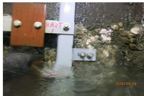
潮汐帶試驗架安裝完成
